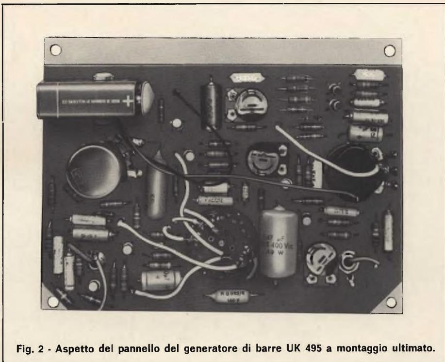
Fig. 2 - Aspetto del pannello del generatore di barre UK 495 a montaggio ultimato.
