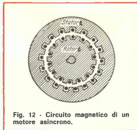
Fig. 12 - Circuito magnetico di un motore asincrono.
