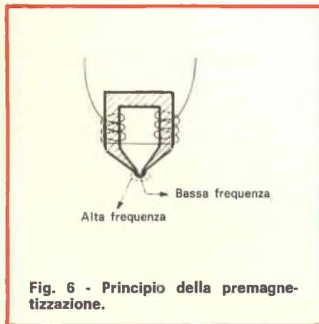
Fig. 6 - Principio della premagnetizzazione.
