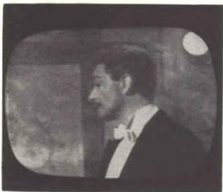
Fig. 1 - Immagine poco definita con sottotono, dovuto a deficienza dell'impianto antenna-linea di alimentazione.
