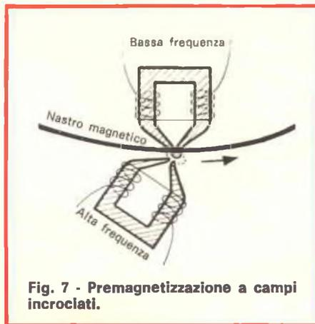
Fig. 7 - Premagnetizzazione a campi incrociati.
