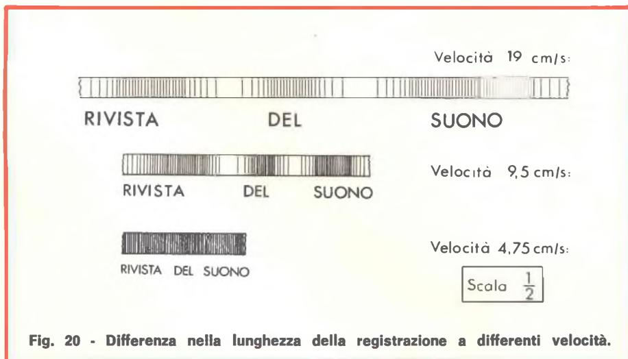
Fig. 20 - Differenza nella lunghezza della registrazione a differenti velocità.
