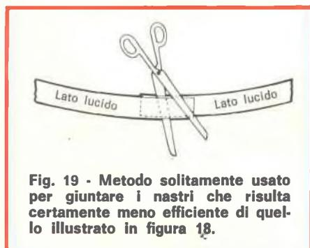
Fig. 19 - Metodo solitamente usato per giungere i nastri che risulta certamente meno efficiente di quello illustrato in figura 18.
