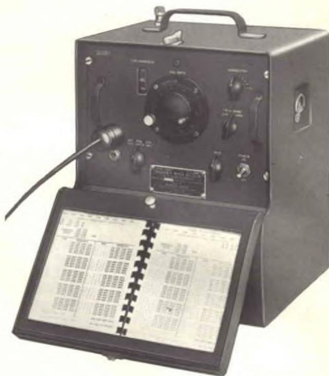
**I**l BC 221 è un ondometro ad eterodina, apparecchiatura di grandissimo interesse per una larga gamma di tecnici radio proprio perché si può affermare, senza tema di smentite, che è l'unico apparecchio di tipo professionale alla portata di ogni borsa.
