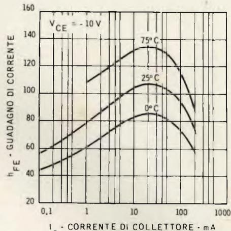
Fig. 4 - Curva «Guadagno -  $I_c$ » del transistor d'impiego generale BC 116; questa è riportata a titolo puramente esemplificativo, perché se anche il transistor è al Silicio, esso è «PNP» quindi inutilizzabile nel nostro circuito.
