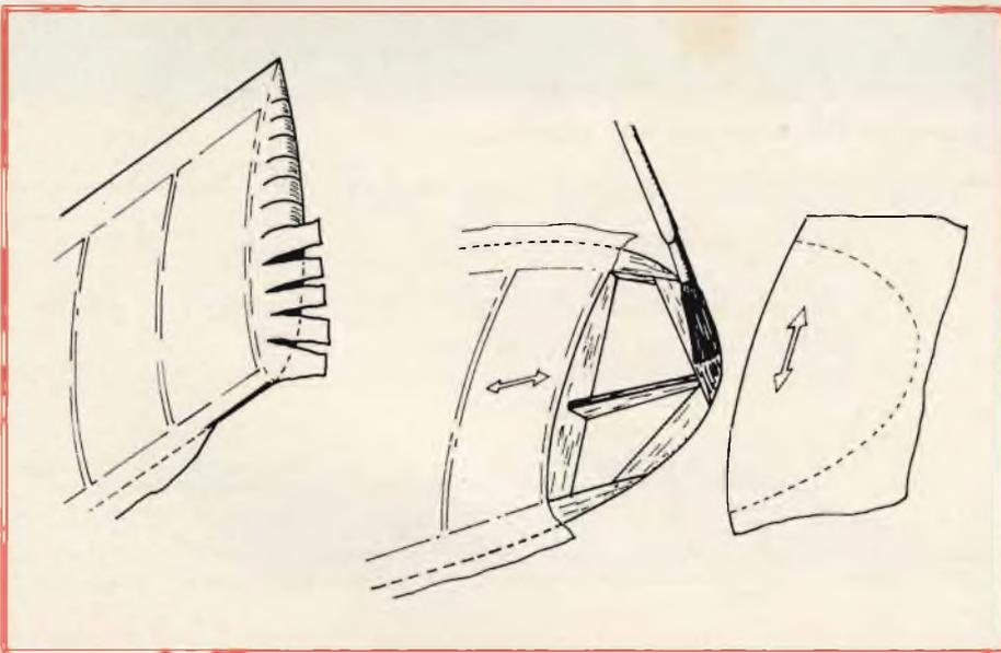
Fig. 6 - Sistema di ricopertura dei terminali alari.
