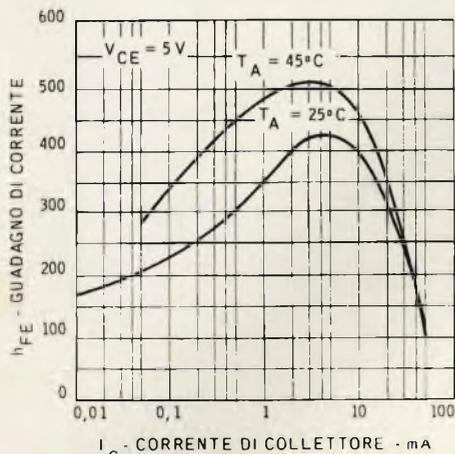
Fig. 2 - Guadagno in funzione della  $I_c$  di un tipico transistor di elevata qualità, preamplificatore audio al Silicio (BC 113) - Come si nota, il guadagno da «350» ad 1 mA (curva 25°C) scade a «150» intorno ai 10  $\mu$ A.
