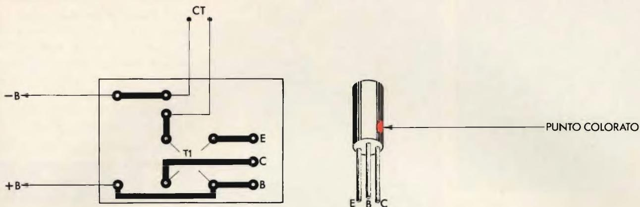
Fig. 4 - Cablaggio dell'oscillatore di fig. 2 e disposizione dei terminali del transistor AC 126.
