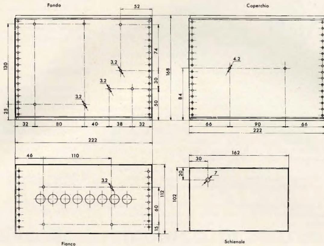
Fig. 9 - Foratura dei pannelli del contenitore.
