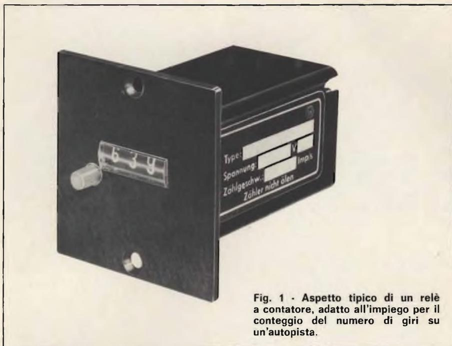
**Fig. 1 - Aspetto tipico di un relè a contatore, adatto all'impiego per il conteggio del numero di giri su un'autopista.**
