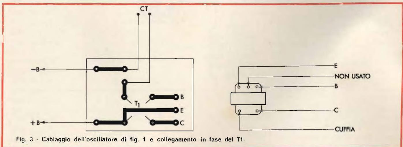
Fig. 3 - Cablaggio dell'oscillatore di fig. 1 e collegamento in fase del T1.
