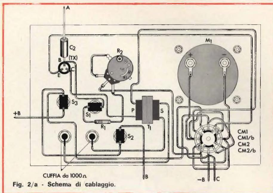
Fig. 2/a - Schema di cablaggio.
