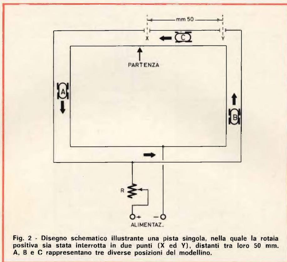
Fig. 2 - Disegno schematico illustrante una pista singola, nella quale la rotaia positiva sia stata interrotta in due punti (X ed Y), distanti tra loro 50 mm. A, B e C rappresentano tre diverse posizioni del modellino.
