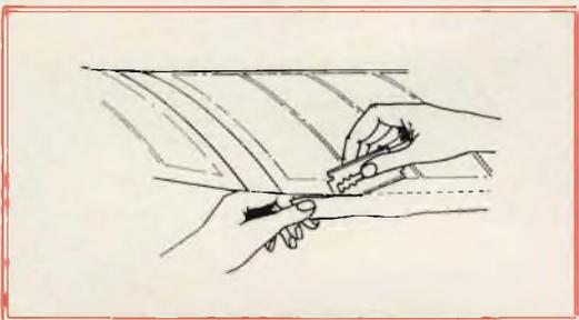
Fig. 5 - Per togliere le parti eccedenti, si procede con una lametta.
