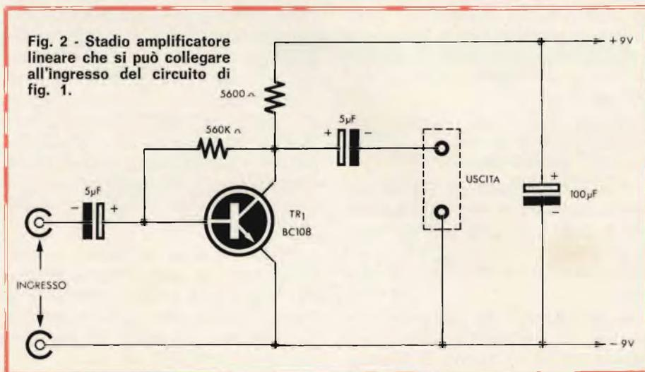
Fig. 2 - Stadio amplificatore lineare che si può collegare all'ingresso del circuito di fig. 1.
