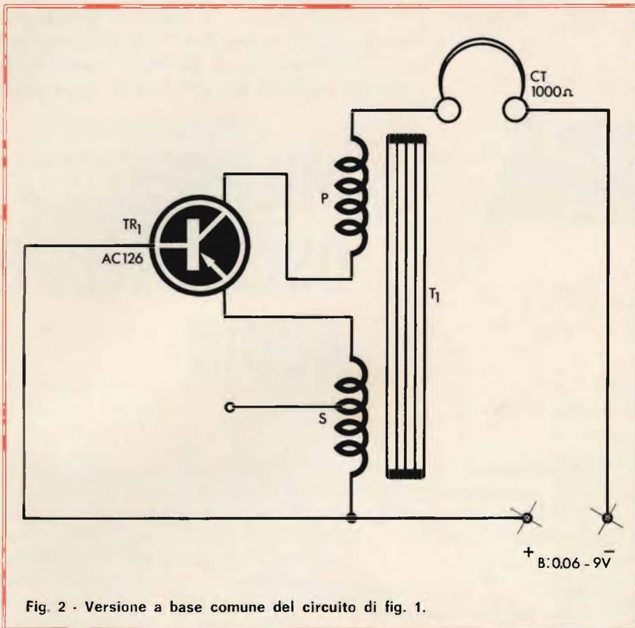
Fig. 2 - Versione a base comune del circuito di fig. 1.
