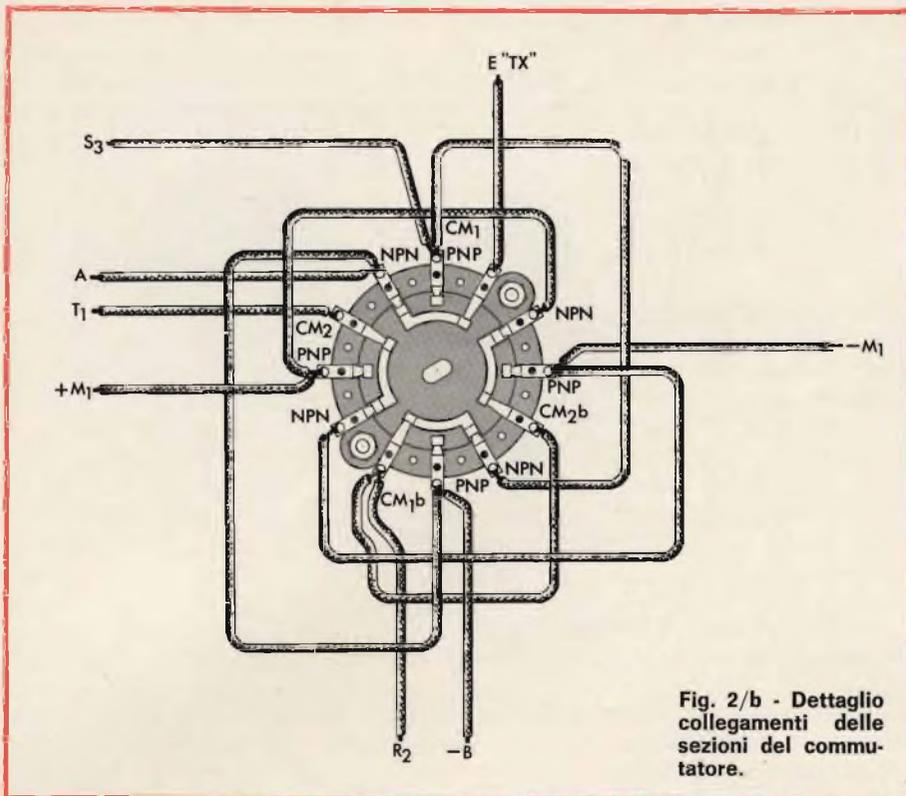
Fig. 2/b - Dettaglio collegamenti delle sezioni del commutatore.
