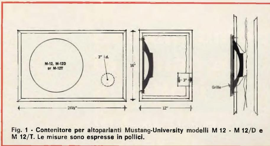
Fig. 1 - Contenitore per altoparlanti Mustang-University modelli M 12 - M 12/D e M 12/T. Le misure sono espresse in pollici.
