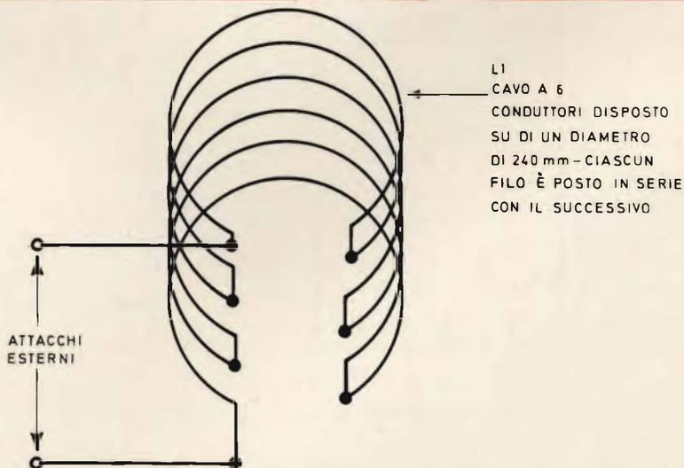
Fig. 3 - Dati costruttivi della bobina L1.
