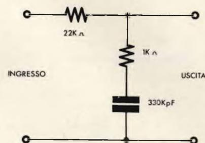
Fig. 1/f - Equalizzatore per vecchi 78 RPM -
