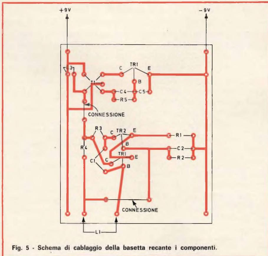
Fig. 5 - Schema di cablaggio della basetta recante i componenti.
