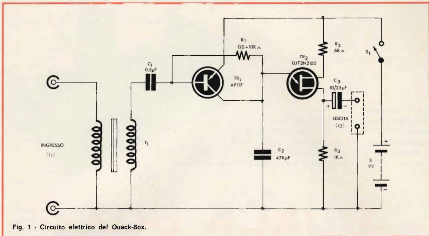
Fig. 1 - Circuito elettrico del Quack-Box.
