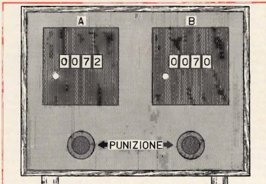
Fig. 6 - Metodo di realizzazione del dispositivo di conteggio, in modo da rendere facilmente disponibili per il giudice di gara i pulsanti di punizione, quelli di azzeramento, ed i totalizzatori.
