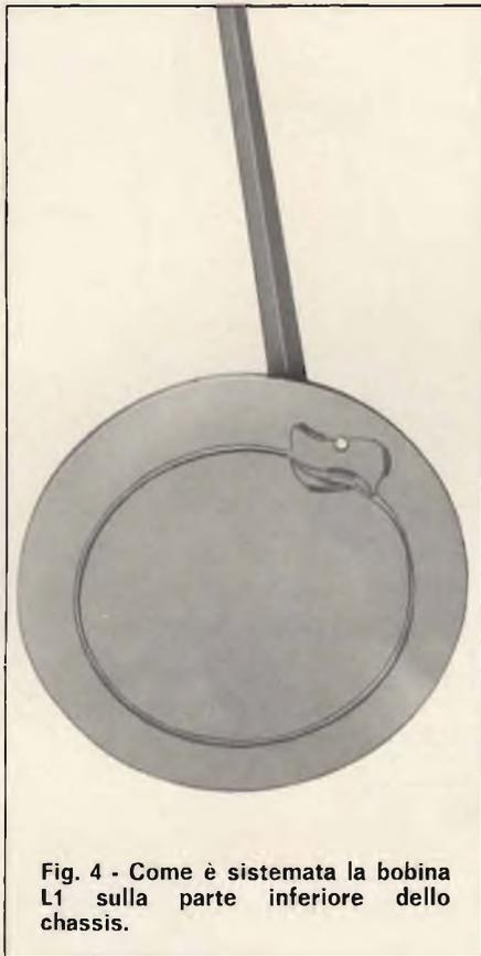
Fig. 4 - Come è sistemata la bobina L1 sulla parte inferiore dello chassis.
