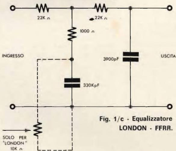
Fig. 1/c - Equalizzatore
