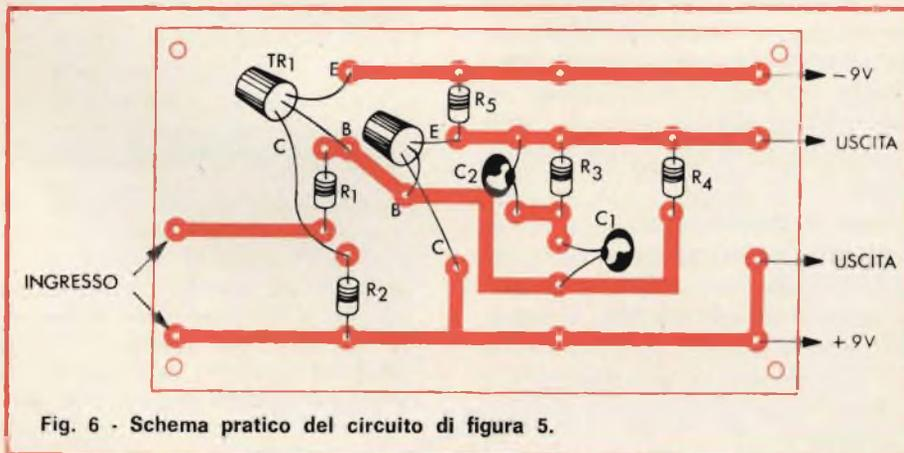
Fig. 6 - Schema pratico del circuito di figura 5.
