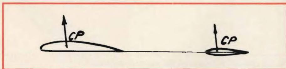
Fig. 4 - Stabilizzatore dimensionato in modo esatto.
