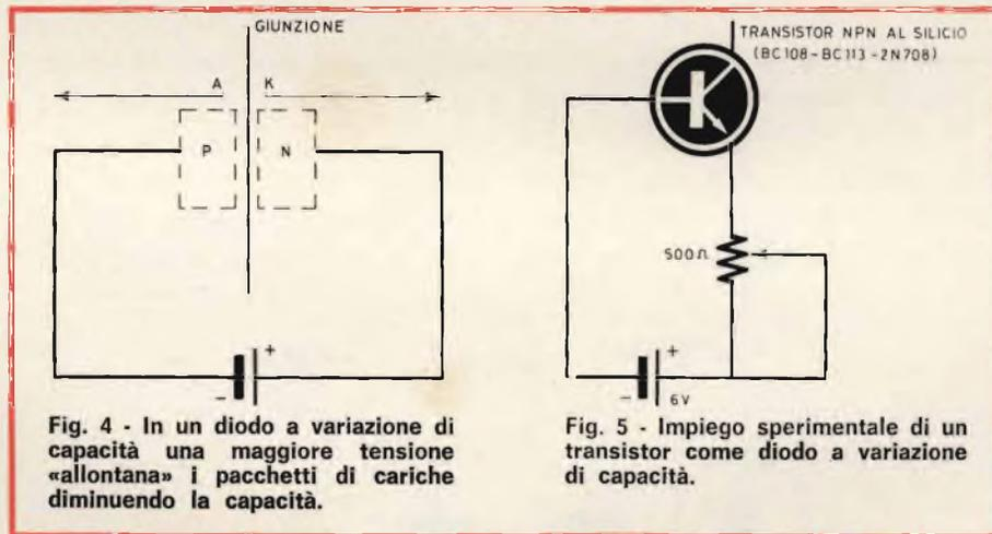
Fig. 4 - In un diodo a variazione di capacità una maggiore tensione «allontana» i pacchetti di cariche diminuendo la capacità.
