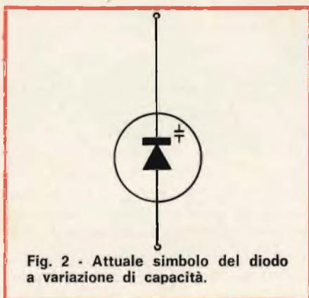
Fig. 2 - Attuale simbolo del diodo a variazione di capacità.
