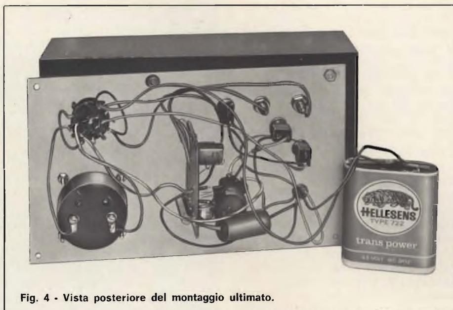
Fig. 4 - Vista posteriore del montaggio ultimato.
