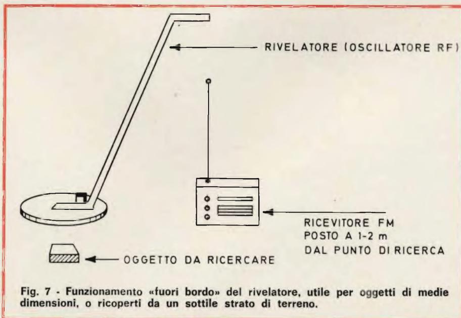
Fig. 7 - Funzionamento «fuori bordo» del rivelatore, utile per oggetti di medie dimensioni, o ricoperti da un sottile strato di terreno.
