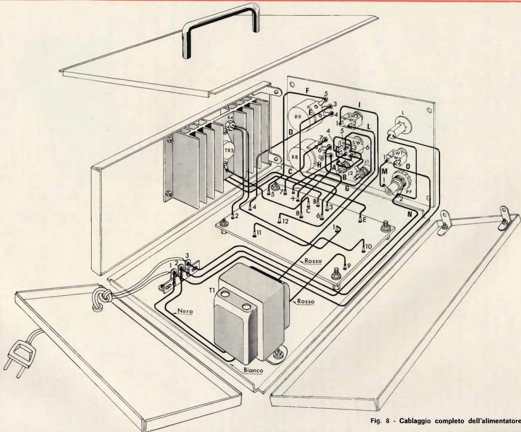
Fig. 8 - Cablaggio completo dell'alimentatore.
