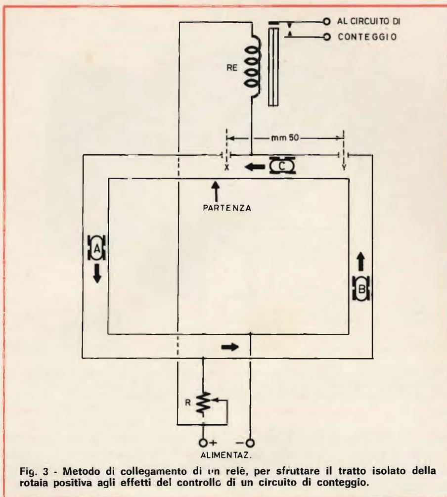
Fig. 3 - Metodo di collegamento di un relè, per sfruttare il tratto isolato della rotaia positiva agli effetti del controllo di un circuito di conteggio.
