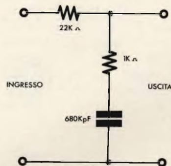
Fig. 1/g - Equalizzatore per vecchi 78 RPM
