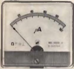
**Microamperometro a bobina mobile per «Termometro elettronico - UK 410»**
