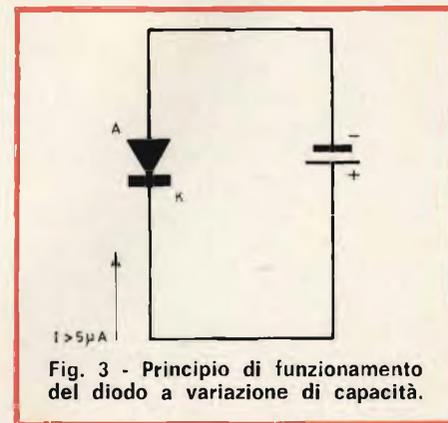
Fig. 3 - Principio di funzionamento del diodo a variazione di capacità.
