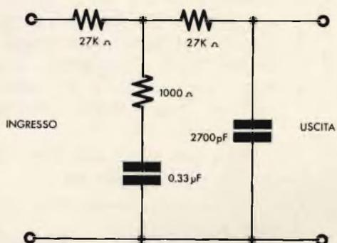
Fig. 1/b - Equalizzatore NAB - NARTB
