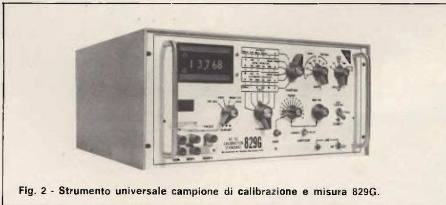
Fig. 2 - Strumento universale campione di calibrazione e misura 829G.
