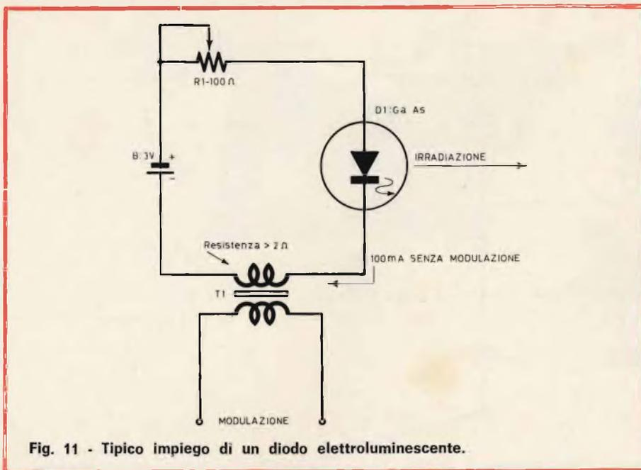
Fig. 11 - Tipico impiego di un diodo elettroluminescente.
