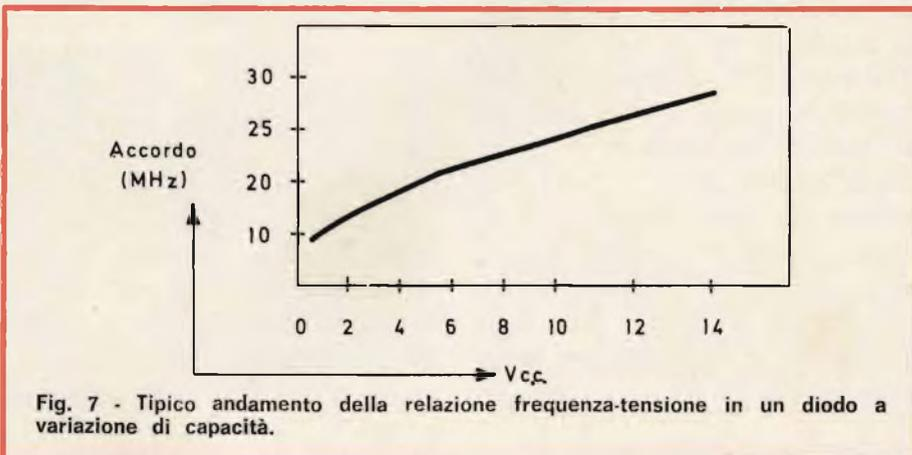
Fig. 7 - Tipico andamento della relazione frequenza-tensione in un diodo a variazione di capacità.
