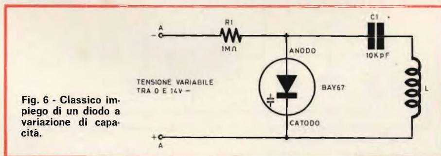
Fig. 6 - Classico impiego di un diodo a variazione di capacità.
