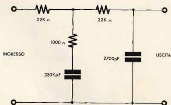
Fig. 1/e - Equalizzatore AES 33 RPM - 78 RPM «NUOVI».
