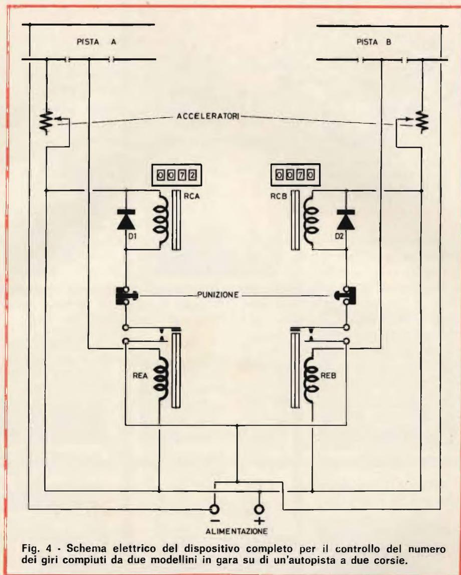
Fig. 4 - Schema elettrico del dispositivo completo per il controllo del numero dei giri compiuti da due modellini in gara su di un'autopista a due corsie.
