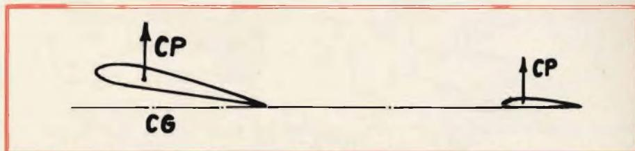
Fig. 3 - Stabilizzatore non dimensionato.
