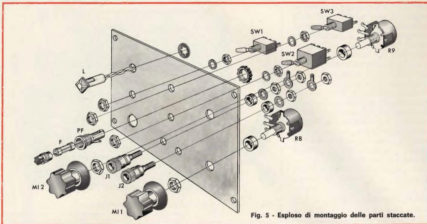
Fig. 5 - Esploso di montaggio delle parti staccate.
