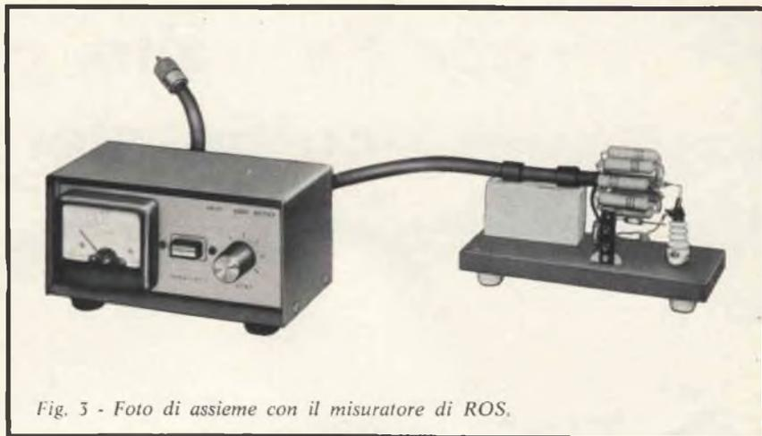
Fig. 3 - Foto di assieme con il misuratore di ROS.
