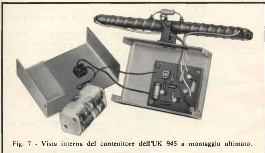
Fig. 7 - Vista interna del contenitore dell'UK 945 a montaggio ultimato.
