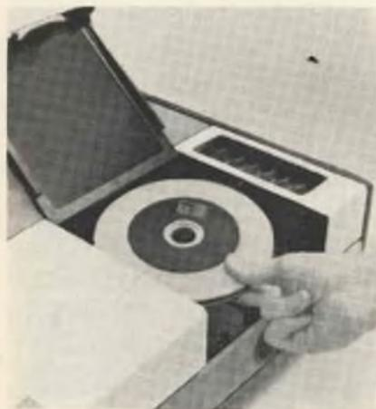
*Videocassetta usata nel sistema EVR inserita sull'asse dell'apparecchio che ne consente la riproduzione. Essa ha un diametro di 18 cm, uno spessore di 1,27 cm e, quando è interamente caricata, pesa 450 g.*
