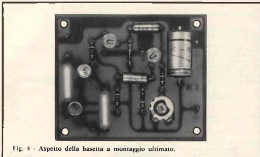
Fig. 4 - Aspetto della basetta a montaggio ultimato.
