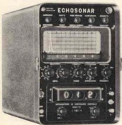
Fig. 8 - Apparecchio ECHOSONAR ad ultrasuoni della ditta Gilardoni con incorporato il misuratore di spessori di figura 9.
