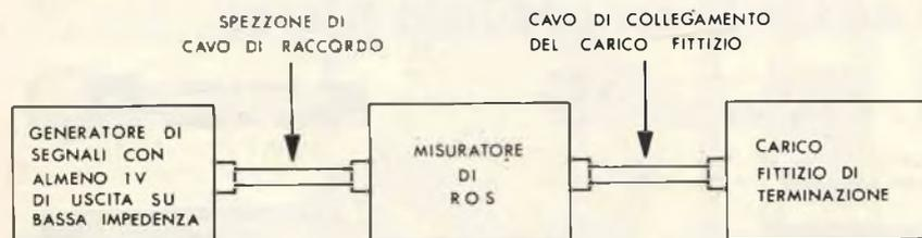
Fig. 2 - Disposizione schematica di misura del carico fittizio; viene alimentato da un generatore con l'aiuto di un misuratore di ROS (Rapporto di Onda Stazionaria) per la verifica del corretto adattamento di impedenza.
