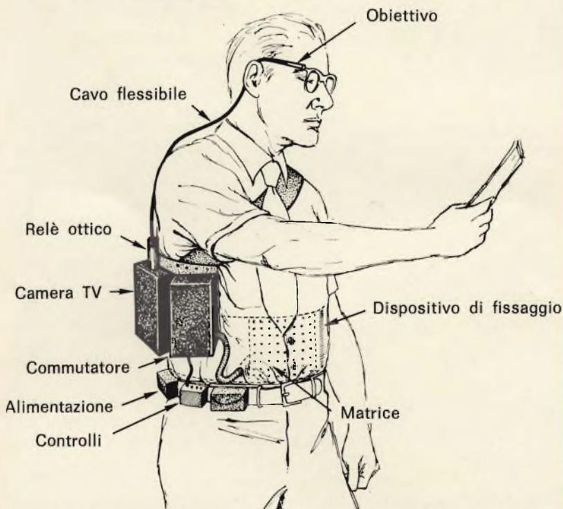
Fig. 9/b - Prototipo schematicizzato del sistema Schimmel. La quasi totalità del complesso presenta una montatura esteriore facilmente rimovibile. L'espedito nel suo complesso ha raggiunto un soddisfacente grado di perfezione; attualmente lo si sperimenta su scimpazé. Il team del Bronx conta di poter passare alla applicazione sugli esseri umani in meno di tre anni.
