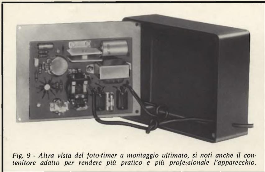
Fig. 9 - Altra vista del foto-timer a montaggio ultimato, si noti anche il contenitore adatto per rendere più pratico e più professionale l'apparecchio.
