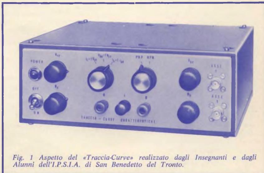
Fig. 1 Aspetto del «Traccia-Curve» realizzato dagli Insegnanti e dagli Alunni dell'I.P.S.I.A. di San Benedetto del Tronto.
