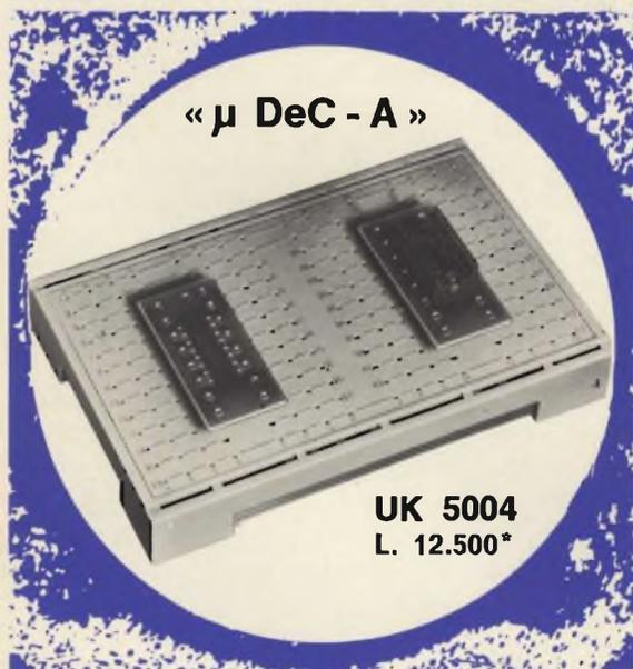
Il sistema DeC è stato realizzato per poter collegare diversi componenti elettronici senza dover ricorrere al saldatore. La disposizione lineare dei contatti permette di sistemare i componenti in modo da poterli facilmente sostituire in fase di progetto. Possono essere realizzati schemi con transistori C.I. in TO-5 oppure in DIL.
