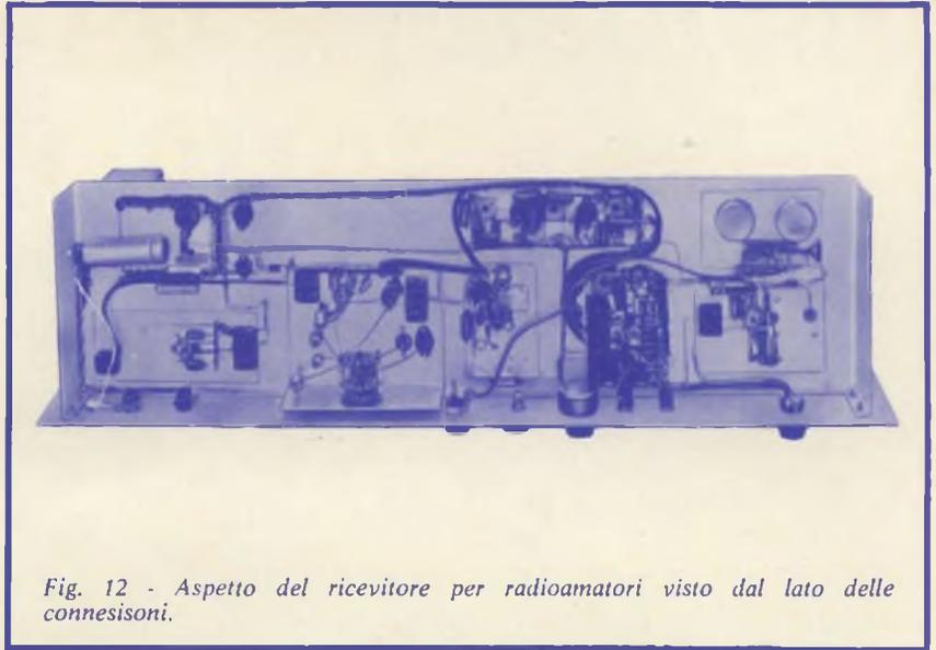
Fig. 12 - Aspetto del ricevitore per radioamatori visto dal lato delle connessioni.
