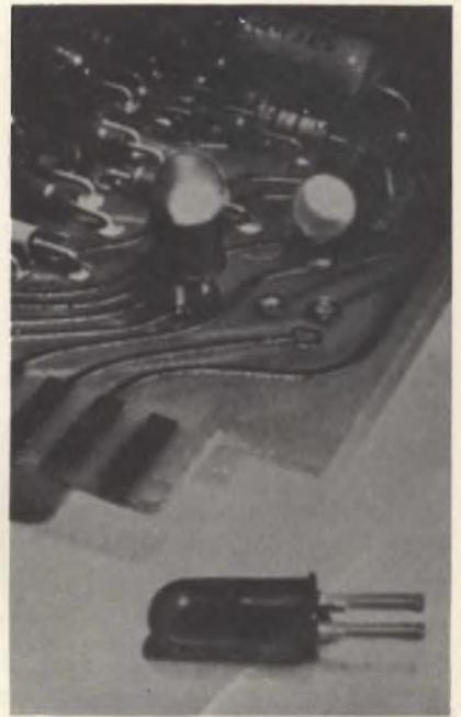
Fig. 11 - Foto illustrante l'aspetto della memoria opto-elettronica più semplice: si tratta di una lampada elettro-luminescente, abbinata ad un fotoconduttore.
