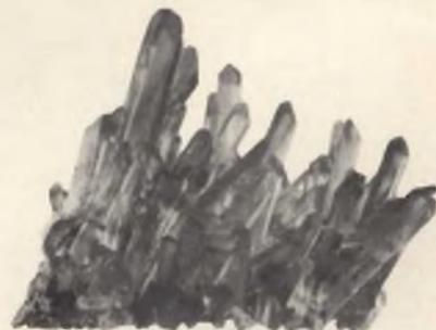
Fig. 1 - Geode di quarzo, dal quale si ricavano i cristalli per applicazioni radioelettriche.
