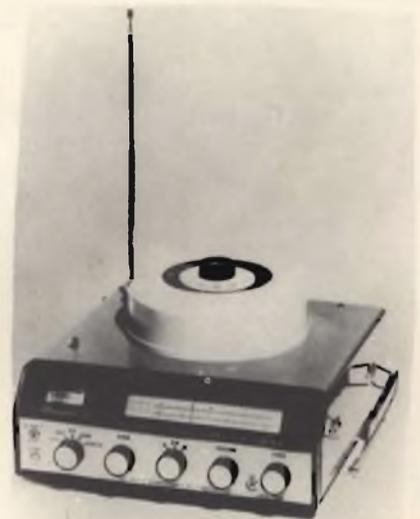
Fig. 8 - Radiogoniometro portatile automatico MICROMATIC 310 a transistori della FINDER.
