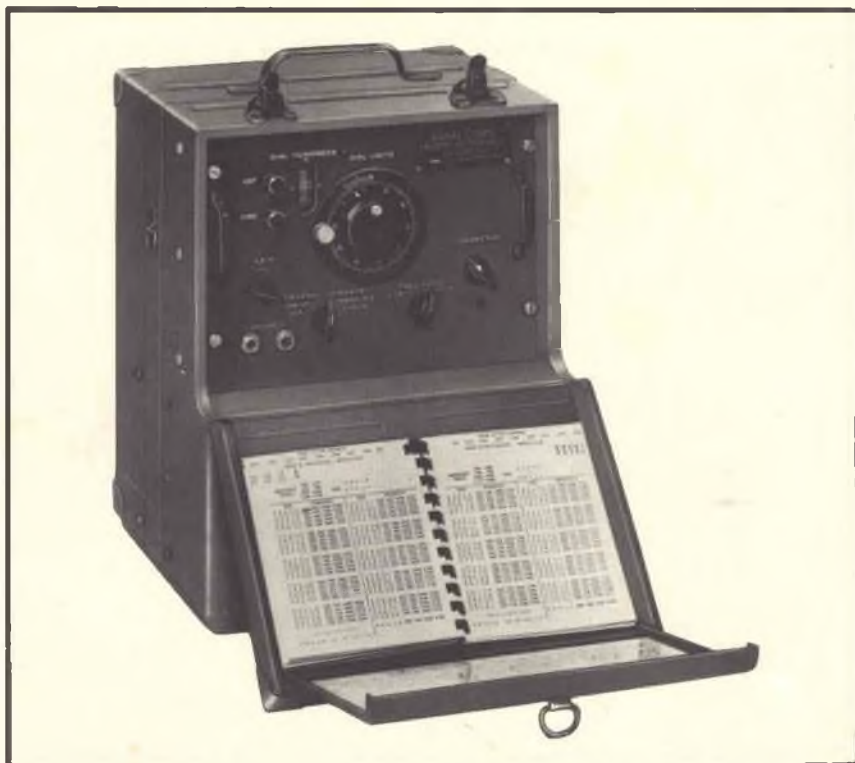
Fig. 1 - Fronte del pannello di comando del BC 221 modulato con lo sportello del libretto di taratura aperto.
