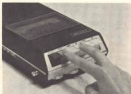
Fig. 2 - Per effettuare la registrazione è necessario premere contemporaneamente il tasto di registrazione e quello di avanzamento.
