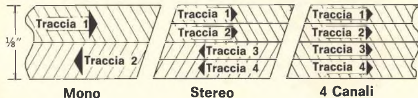
Fig. 8 - Sensi di registrazione dei diversi tipi di nastri magnetici.
