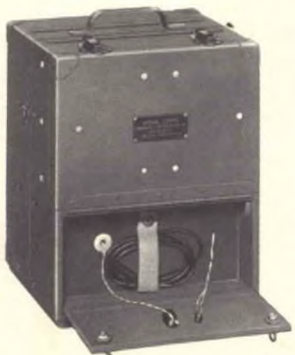
Fig. 3 - Fronte del BC 221 modulato con in vista l'alloggiamento disponibile per cavetti di collegamento o utensili eventuali.
