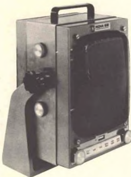
Fig. 1 - Apparecchio radar (ricevitore) per navigazione da diporto NOVA (FINDER) portata minima 18 m. portata massima 24 miglia.
