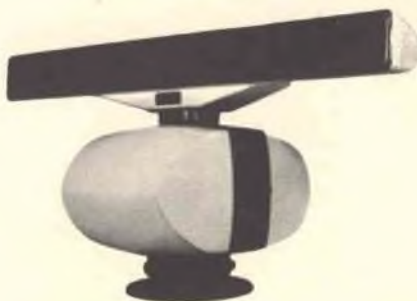
Fig. 2 - Antenna per radar NOVA (lunghezza 92 cm.) montata sopra il trasmettitore.
