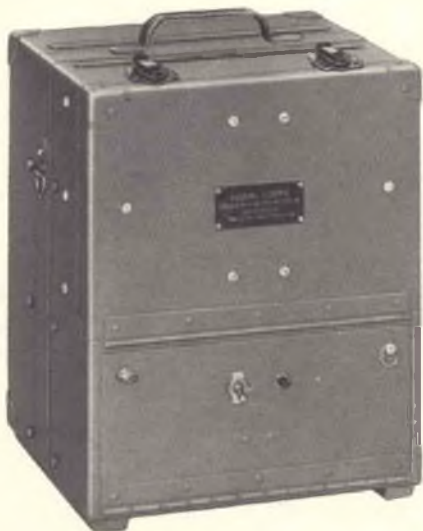
Fig. 2 - Vista frontale del BC 221, si noti l'interruttore di rete e la spia luminosa introdotti con l'alimentazione.
