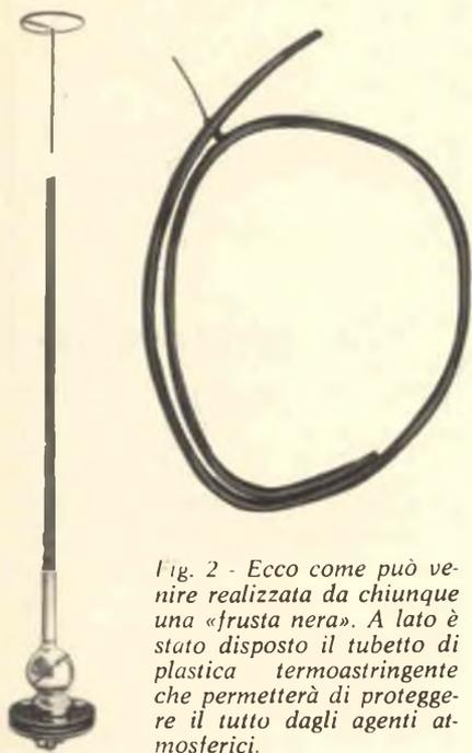
Fig. 2 - Ecco come può venire realizzata da chiunque una «frusta nera». A lato è stato disposto il tubetto di plastica termostringente che permetterà di proteggere il tutto dagli agenti atmosferici.
