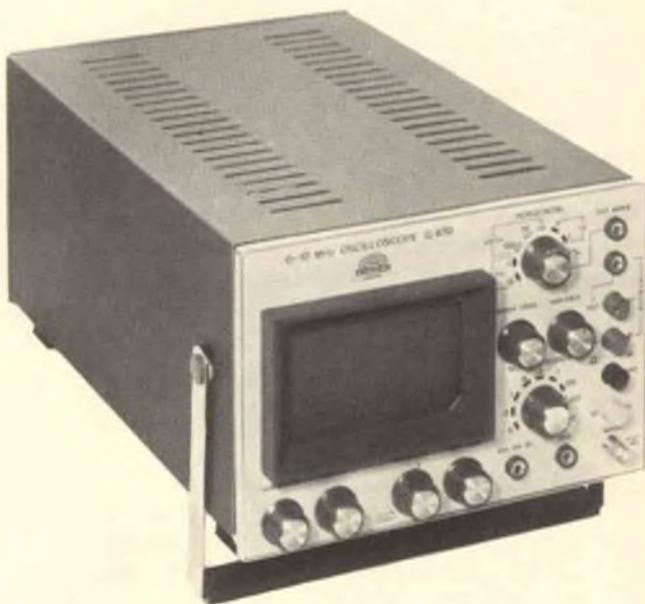
Questo è il nuovo Oscilloscopio UNAOHM G 470, particolarmente curato per la Tecnica TV in genere ed a colori. Si noti la compattezza dell'insieme e la semplicità e la funzionalità di disposizione dei comandi. La banda dell'amplificatore verticale si estende dalla continua ai 10 MHz.
