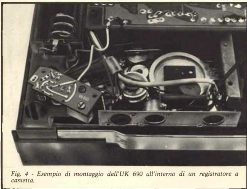
Fig. 4 - Esempio di montaggio dell'UK 690 all'interno di un registratore a cassetta.
