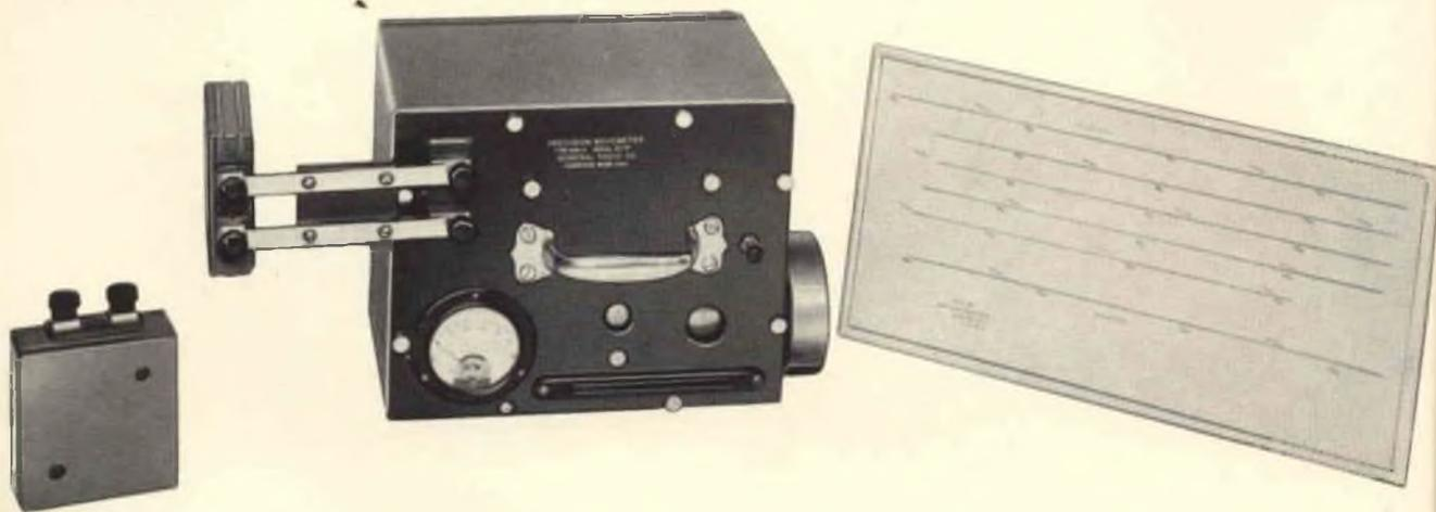
Fig. 3 - Foto dello strumento originale montato con una delle 6 bobine di dotazione collegate al link rigido metallico che permette con il serraggio dei morsetti la perfetta riproduzione «per commutazione manuale» dell'induttanza in gioco. Accanto sono riportati alcuni dei grafici ve n'è ovviamente uno per ogni banda e quindi bobina di lavoro.
