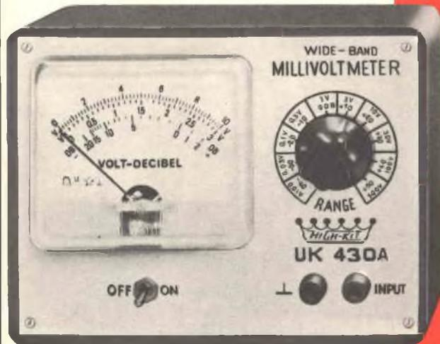
L'UK 430/A può essere usato per misure di rumore di fondo, di disturbo residuo, di alternata sugli alimentatori, per misure delle caratteristiche di frequenza e guadagno sugli amplificatori, per il rilievo di caratteristiche sul quadripoli attivi e passivi, come rivelatore esterno in misure con ponti a bassa e alta frequenza ecc.
