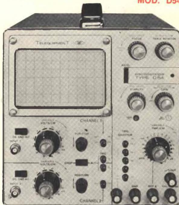
L'oscilloscopio Teleequipment Mod. D54 è interamente transistorizzato. Ha due canali verticali con sensibilità massima di 10 mV/cm, in una banda di frequenza fino a 10 MHz e una base dei tempi estremamente flessibile con 22 fattori di deflessione tarati fino a 200 ns/cm.
