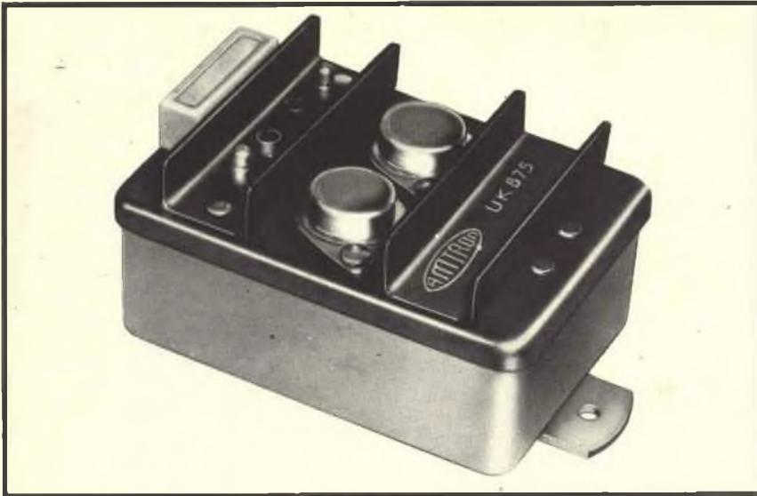
Fig. 3 - Dispositivo di accensione elettronica a scarica capacitiva per tutte le vetture di serie, anche di classe elevata, prodotto dalla AMTRON sotto forma di scatola di montaggio.
