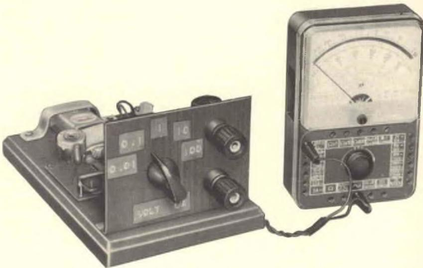
Fig. 1 - Foto frontale del millivoltmetro. Si ha una portata massima di soli 100 V ma lo strumento è prevalentemente destinato ormai alle prove su circuiti di bassa frequenza transistorizzati.
