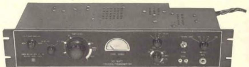
Fig. 1 - Vista frontale dei comandi del trasmettitore da 50 W della Millen.
