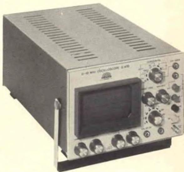
**Tempi di scansione:** da 100 ms/cm ad 1  $\mu$ s/cm in 5 scatti decimali. Due posizioni speciali permettono la scansione a  $\sim$  3 ms/cm ed a  $\sim$  10  $\mu$ s/cm per l'analisi di segnali TV rispettivamente a frequenza di quadro o di riga.
