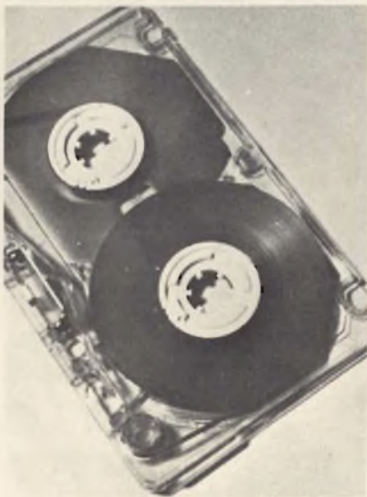
Fig. 3 - Foto illustrante uno dei sistemi per la realizzazione delle guide del nastro.
