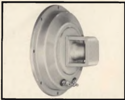
Fig. 1 - Altoparlante per frequenze medie (mid-range) Peerless (G.B.C. AA/3785-00) tipo GT-50MRC per accoppiamento con altoparlanti fino a 15 W, campo di frequenza 800 ÷ 7000 Hz, impedenza 8 Ω.
