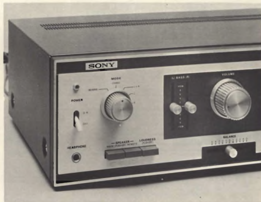
Il settore di «Modo», come si può vedere, consente d'invertire lo stereo, di far funzionare i due circuiti amplificatori in parallelo, o di far lavorare l'uno o l'altro circuito amplificatore. I tasti disposti sotto il selettore di modo permettono di selezionare gli altoparlanti e di mettere in servizio il circuito di correzione fisiologica.
