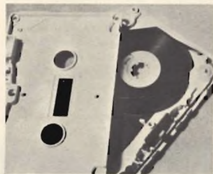
Fig. 1 - Aspetto tipico di una cartuccia, aperta per mettere in evidenza le due metà dell'involucro esterno.
