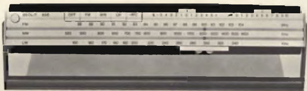
Fig. 6 - Aspetto del pannello superiore del radiorecettore Beolit 600. La sintonia è a cursore, come pure i comandi di tono e di volume. Una tastiera a cinque pulsanti permette di predisporre facilmente le funzioni che il ricevitore consente.
