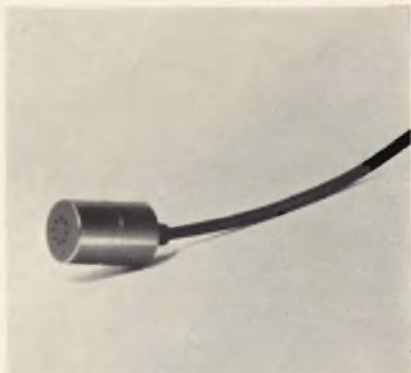
Fig. 5 - Microfono omnidirezionale «Electret Condenser» SONY ECM-50. Risposta di frequenza: 40 \div 14.000 Hz. Impedenza d'uscita: 50-250-600 \Omega \pm 20\% a 1000 Hz - Alimentazione: 1,5 V.
