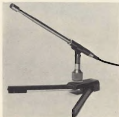
Fig. 6 - Microfono omnidirezionale «Electret Condenser» SONY ECM-51. Risposta di frequenza: 40 \div 14.000 Hz. Impedenza d'uscita: 250 \Omega \pm 20\% a 1000 Hz - Alimentazione: 1,5 V.
