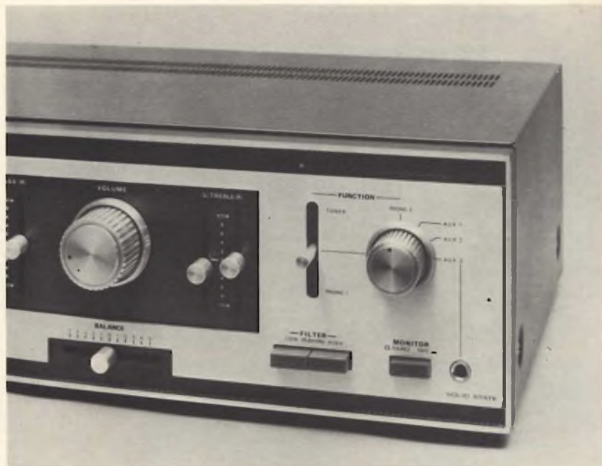
La selezione degli ingressi viene ottenuta attraverso una leva e una manopola. I filtri vengono azionati da due tasti disposti sotto la leva «tuner-phono 1», il tasto più a destra consente l'ascolto del nastro durante la registrazione.
