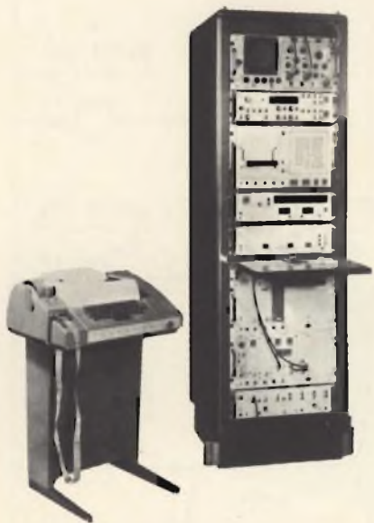
Fig. 5 - Apparecchio per il controllo dei circuiti integrati comandato da un calcolatore elettronico, in grado di eseguire 200 misure al secondo.
