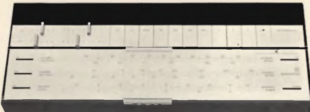
Fig. 3 - Aspetto del pannello frontale del Sinto-amplificatore Modello Beomaster 1200. I quattro comandi sono a cursore, e sono allineati con una pulsantiera che predispone l'apparecchio per i diversi tipi di impiego che esso consente. La sintonia viene regolata con la massima cura tramite un cursore con messa a punto di massima e micrometrica.
