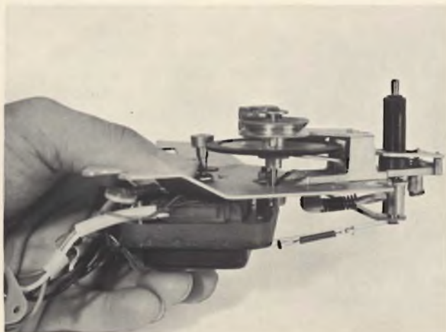
Fig. 2 - Fotografia illustrante le caratteristiche meccaniche di un motorino per giradischi di produzione B. & O. Sono da notare il supporto principale in fusione, e la semplicità dei meccanismi di trasmissione del movimento rotatorio, e di regolazione del rapporto.
