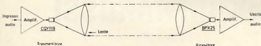
Fig. 1 - Schema a blocchi del sistema di comunicazione a raggi infrarossi descritto.
