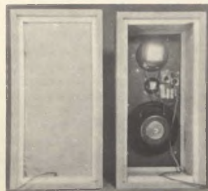
Fig. 6 - La cassa acustica, a sinistra, deve essere riempita con lana di vetro. A destra si vede la disposizione degli altoparlanti.
