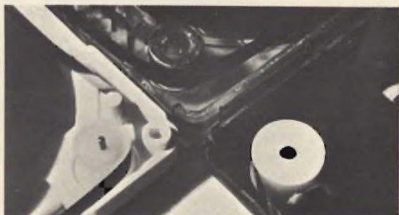
Fig. 5 - Tre diversi sistemi di fissaggio del rullo di guida: al centro è visibile un supporto fisso; a sinistra un rullo di plastica ruotante in un perno di acciaio; a destra un rullo di plastica ruotante in un perno di plastica.
