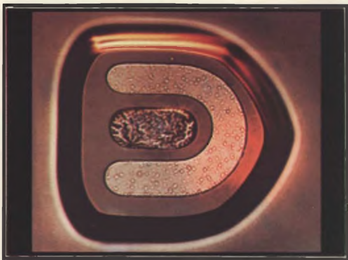
Fig. 25 - Transistore UHF al germanio realizzato in tecnica Mesa II.
