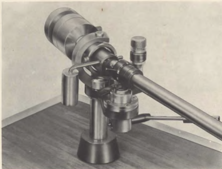
Particolare del braccio Sony PUA286. Le sue particolarità sono costituite dai dispositivi per la regolazione della forza d'appoggio e anti-skating.
