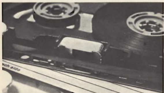
Fig. 7 - Esempio di schermo metallico disposto intorno al punto in cui il nastro passa davanti alla testina per evitare l'induzione di rumore di fondo e di segnali indesiderati.
