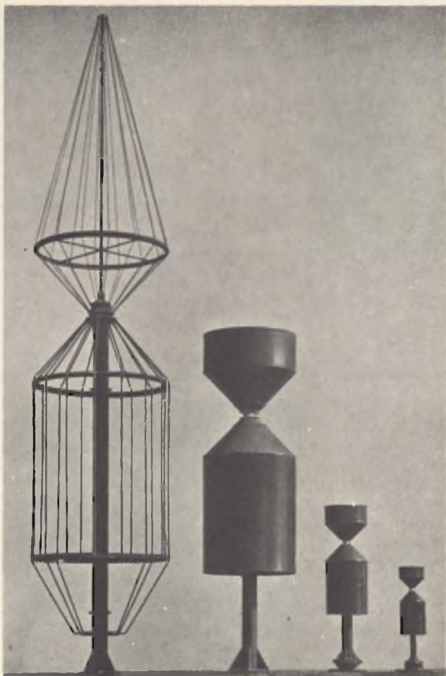
Fig. 1 - Antenne riceventi per VHF/UHF Rhode & Schwarz serie HA/73, per frequenze 30-120, 80-330 - 170-600 e 300-1000 MHz del tipo a polarizzazione orizzontale.
