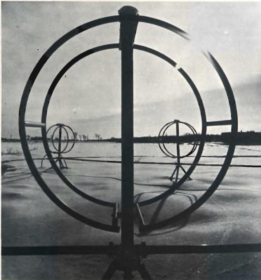
*Fig. 1 - Modernissima antenna aperiodica a quadro della HERMES ELECTRONICS LIMITED che mediante un preamplificatore a stato solido consente di coprire le gamme di radiodiffusione fra 2 e 32 MHz. Si tratta di un tipo di antenna che è destinato a sostituire, in ricezione, le antenne rombiche e quelle logperiodiche*
