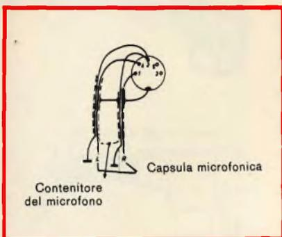
Fig. 12 - Altro possibile collegamento di un microfono stereo.
