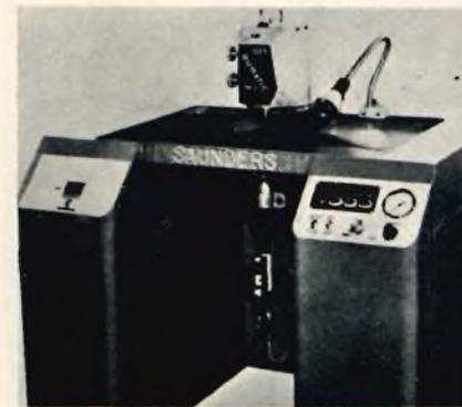
Fig. 2 - Fotografia illustrante la perforatrice Dumatic 603 Mk II, usata per la lavorazione dei circuiti stampati.
