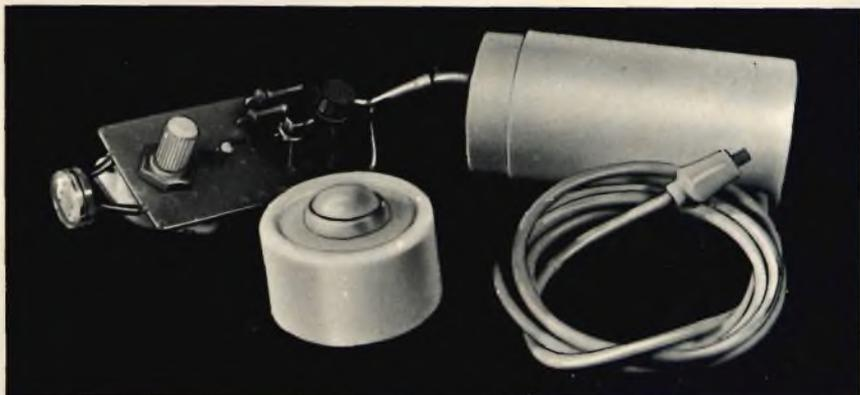
Fig. 4 - Sistemazione della bassetta in un involucro plastico per rullini fotografici.
