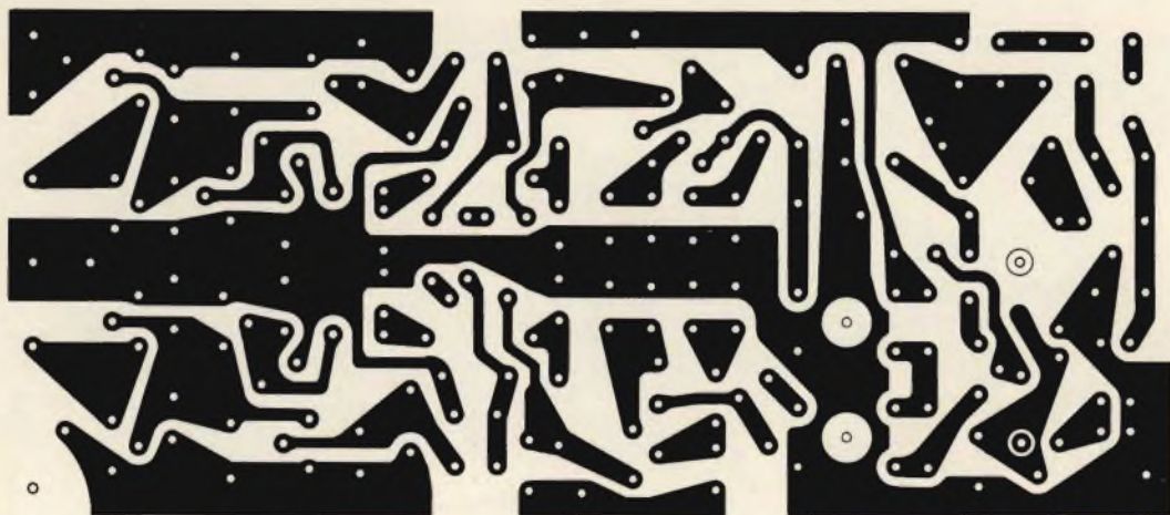
Fig. 8 - Circuito stampato del ricevitore visto dal lato rame e in scala 1 : 1.
