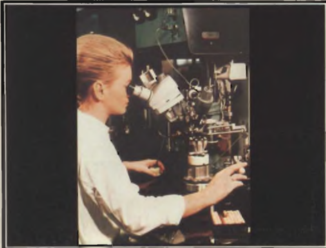
Fig. 51 - Circuito integrato a semiconduttori - Realizzazione dei collegamenti.
