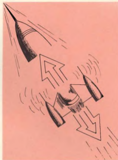
Fig. 5 - I razzi si muovono nell'aria e nello spazio «vuoto» in virtù del principio di azione e reazione.
