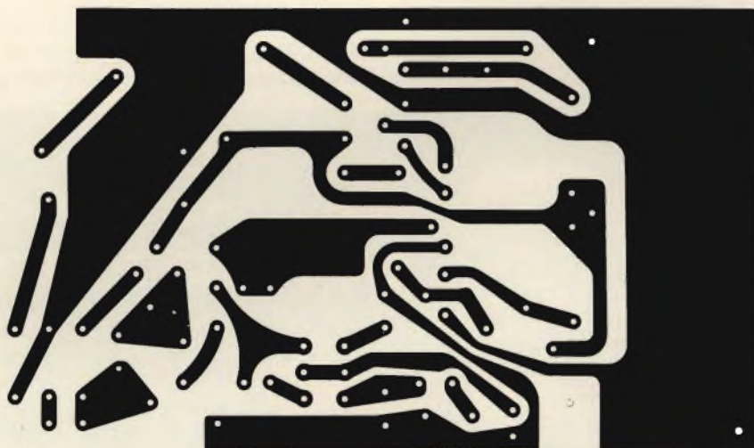
Fig. 7 - Circuito stampato del trasmettitore visto dal lato rame e in scala 1 : 1.
