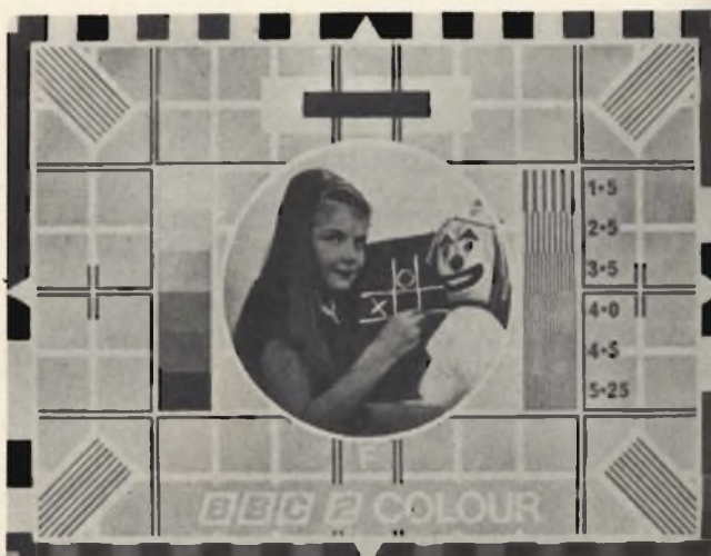
Fig. 2 - Aronoscopio per le emissioni in colore della British Broadcasting Corporation.
