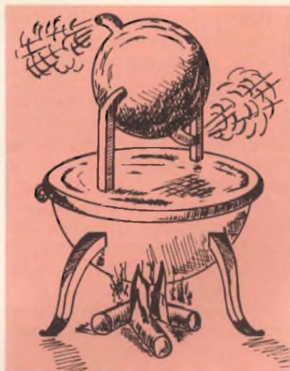
Fig. 7- Turbina a reazione costruita dagli antichi Greci.
