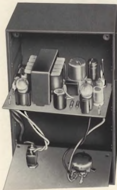
Fig. 3 - Aspetto dell'UK 880 a montaggio ultimato.
