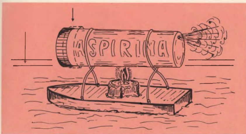
Fig. 9 - Così possiamo facilmente costruire un veicolo che si sposta in virtù del principio di azione e reazione.
