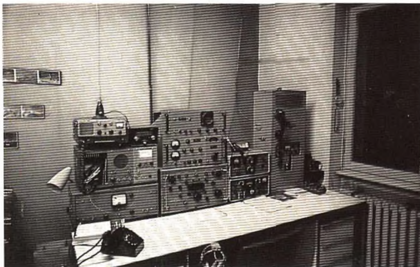
Fig. 6 - Ecco il banco di lavoro in onda ultracorta con cui opera di solito I2BFO. Si notino gli apparati professionali reimpiegati nella stazione, per la banda dei 144 MHz.
