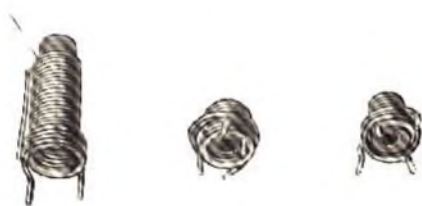
Fig. 7 - Foto illustrante tre tipi di bobine per le diverse gamme.
