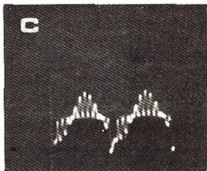
Fig. 17 - Rappresentazione delle forme d'onda dei segnali di un arcobaleno «gated», rilevabili con un oscilloscopio nella sezione di cromaticità.
