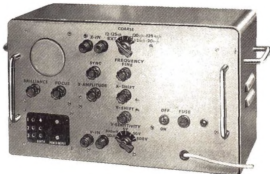
Fig. 2 - Tipico esempio di semplice oscilloscopio; le varie sezioni che lo compongono sono ampiamente descritte nel testo.
