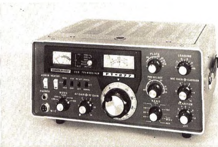
Fig. 8 - Fotografia del ricetrasmittitore per gamme radiomobili 3,5 - 30 MHz SOMMERKAMP FT-277, 38 transistori più tre tubi elettronici.
