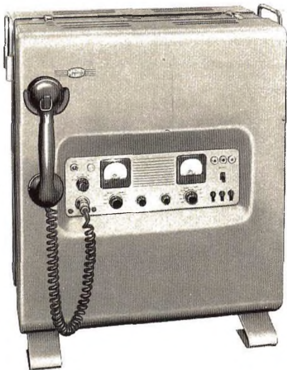
Fig. 4 - Ecco un altro apparato di recupero impiegato per il servizio quarzato in banda 144 MHz. La sua potenza di uscita è di 20 W.
