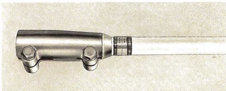
Fig. 4 - Antenna Kathrein Modello K 55272 per l'impiego nella banda 156 \div 162 MHz per la banda VHF adibita alle comunicazioni FM in mare. L'attacco terminale consente di «mettere a massa» in un punto opportuno il dipolo che permette un buon adattamento di impedenza nella banda considerata.
