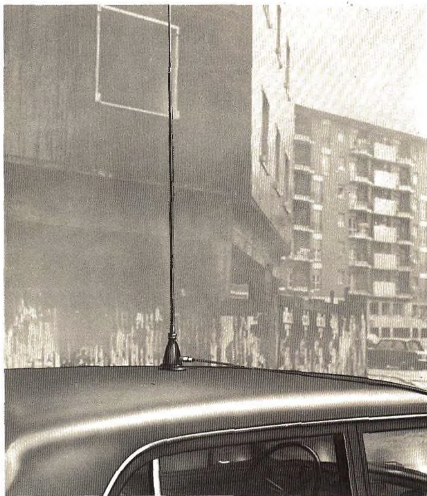
Fig. 5 - Antenna a base magnetica Kathrein Modello K 51132 operante con un tratto irradiante di lunghezza pari a 5/8 lambda e quindi di rendimento sensibilmente superiore alla normale antenna un quarto d'onda. E' possibile utilizzare anche l'Antenna Kathrein Modello K 50522, essa pure per i 144 ÷ 146 MHz.
