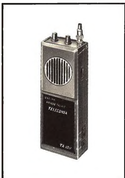
Fig. 2 - Rice-trasmittitore a due canali Sommerkamp TA101/F per la gamma dei due metri, ad alimentazione completamente indipendente e fornito di due quarzi per le frequenze di 145.00 e 145.15 MHz.
