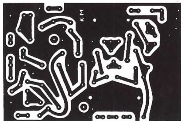
Fig. 3 - Circuito elettrico del trasmettitore miniatura per la gamma dei 2 m comprendente il circuito modulatore.
