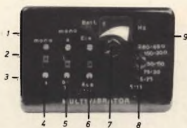
Fig. 9 - Comandi e prese del multivibratore.
