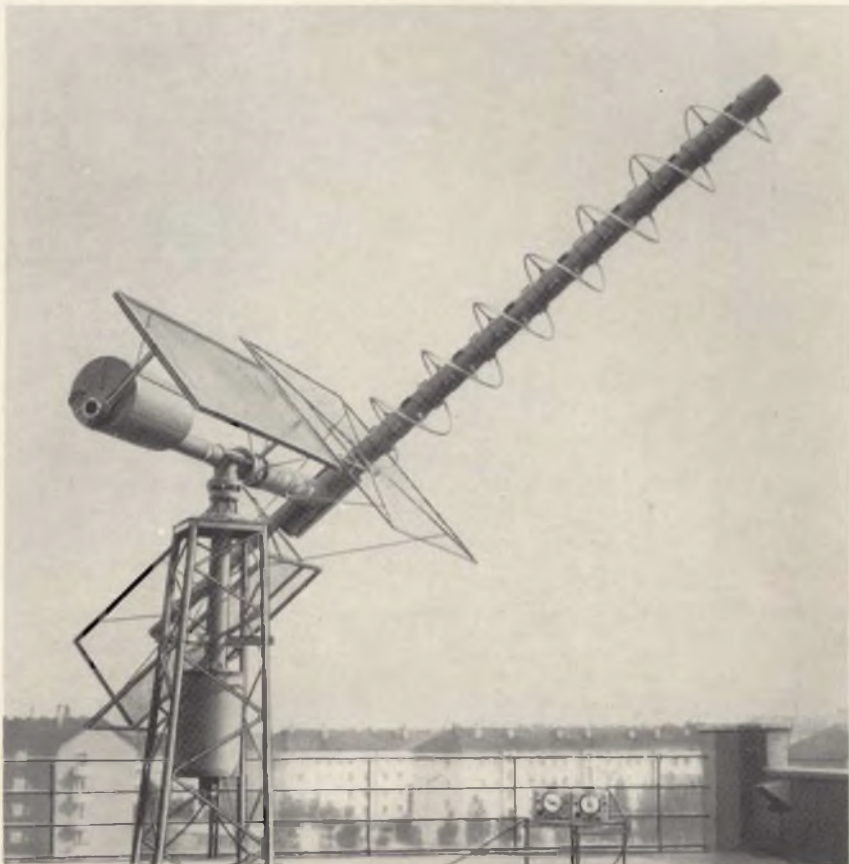
Fig. 3 - Antenna ad elica comandata a distanza per la gamma VHF ed eventualmente OC. Resistenza per l'acquisto da parte dei CB... infinita.
