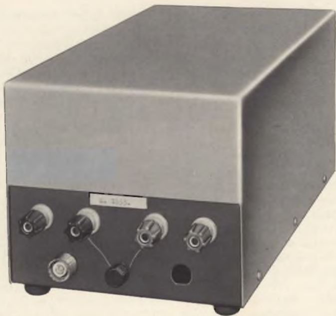
Fig. 5 - Vista posteriore dell'accoppiatore. Sono visibili i morsetti di collegamento ed il connettore coassiale di ingresso.
