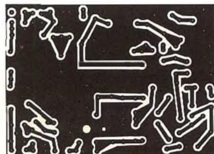
Fig. 2 - Circuito stampato relativo all'unità di trasmissione SSB visto dal lato rame.
