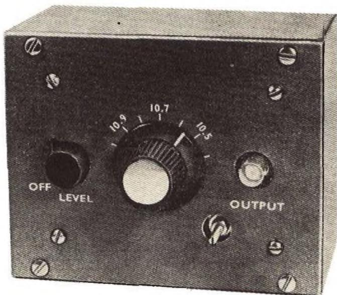
Fig. 1 - Foto del generatore campione nella sua custodia a montaggio ultimato.
