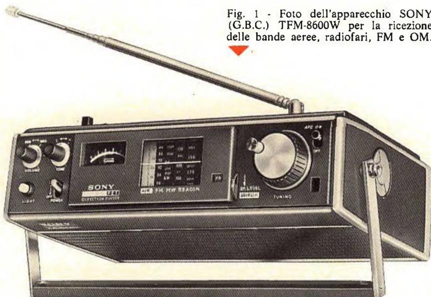
Fig. 1 - Foto dell'apparecchio SONY (G.B.C.) TFM-8600W per la ricezione delle bande aeree, radiofari, FM e OM.
