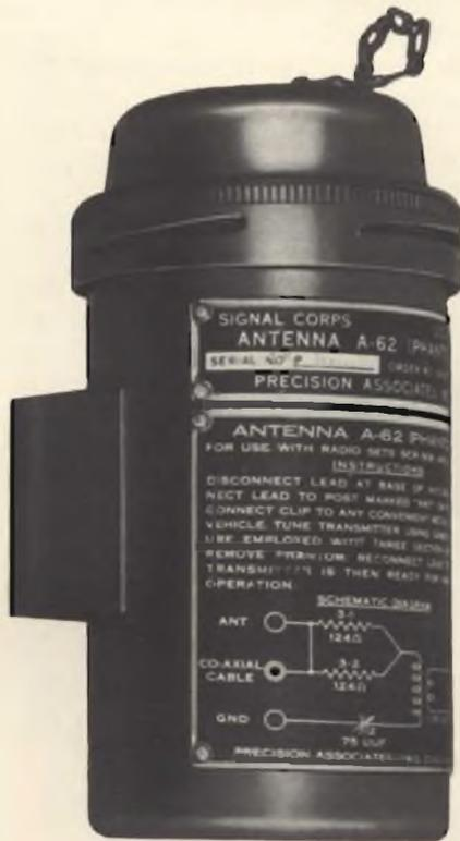
Fig. 1 - Contenitore per il carico d'antenna con il coperchio di protezione chiuso.
