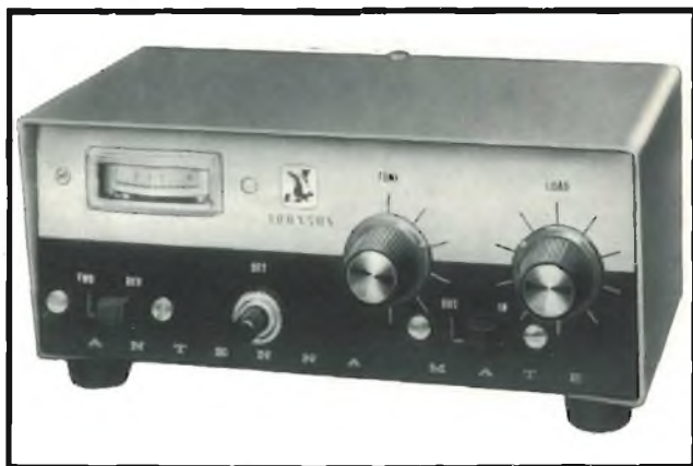
Fig. 6 - L'Antenna mate Johnson 250 per la misura del ROS e sua riduzione ai valori normali nella gamma CB (G.B.C. - TS/2589-4).
