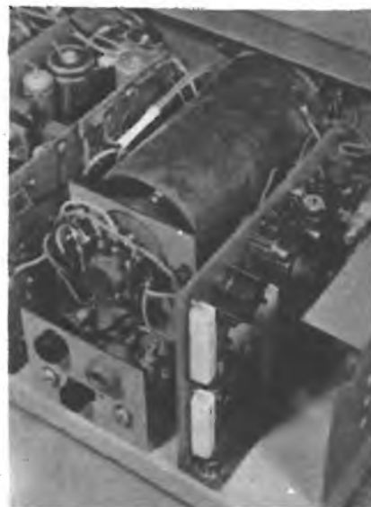
Fig. 4 - Vista posteriore con lo schermo del tubo e del commutatore S5.
