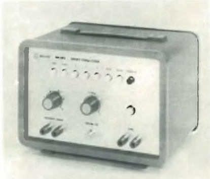
Fig. 3 - Codificatore per servizio di riparazione, allineamento manutenzione PM 6455 della Philips.
