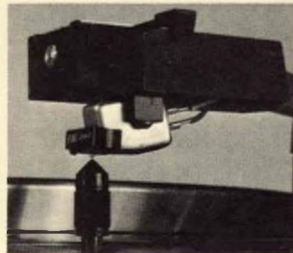
Fig. 4 - Comando che permette di correggere il tracking error cioè l'errore di tangenzialità.
