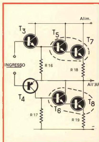
Fig. 2 - Con le potenze in gioco, è preferibile collegare i transistori di uscita (T7-T8) con uno stadio intermedio (T5-T6).
