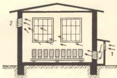
Fig. 6 - Locale per accumulatori con ventilazione convenzionale. 1 = entrata aria fresca, 2 = uscita aria viziata.
