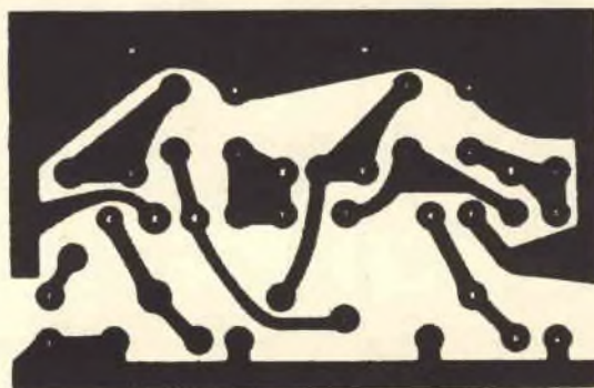
Fig. 3 - Circuito stampato per l'oscillatore di fig. 1 visto dal lato rame.
