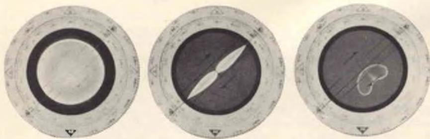
Fig. 7 - Tubo indicatore del radiogoniometro Kodon KS-321UA con indicazione di due rilevamenti (l'incertezza di 180° del rilevamento centrale è eliminata nel rilevamento di destra).
