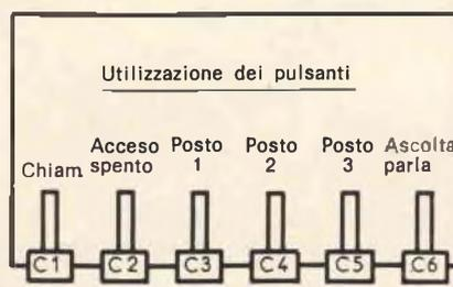
Fig. 4 - Disegno illustrante la funzione di ogni commutatore.
