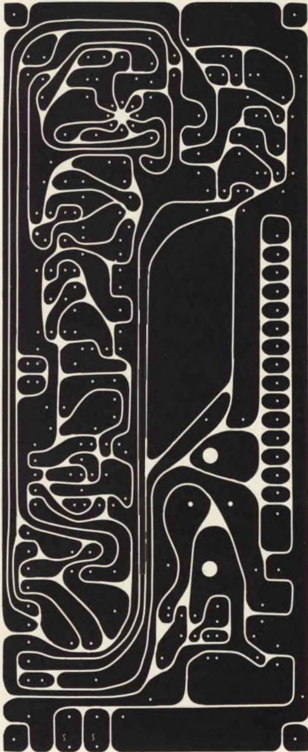
Fig. 10 - Circuito stampato visto dal lato rame. (scala 1 : 1)
