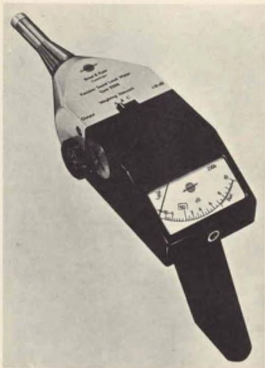
Fig. 4 - Aspetto di un fonometro di produzione Bruel & Kjaer. L'apparecchiatura di base è munita di un microfono piezoelettrico, funzionante nella gamma 20 e 10.000 Hz.
