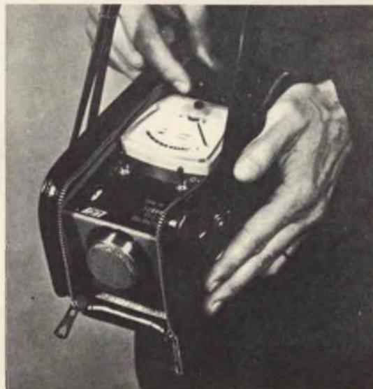
Fig. 5 - Ecco un altro fonometro, e precisamente il modello 1563 della General Radio. La gamma dinamica di questo strumento è compresa tra 40 e 150 dB.
