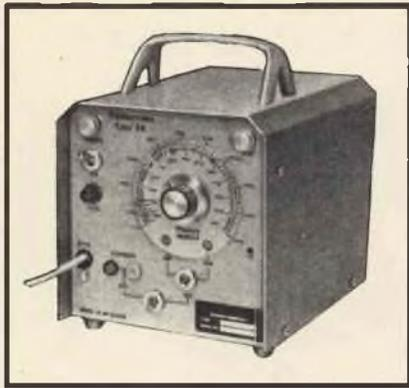
Fig. 12 - Stroboscopia della Belotti tipo 6 K, con lampada da 10 W, campo bagliori da 300 a 6.000 bagliori al minuto.
