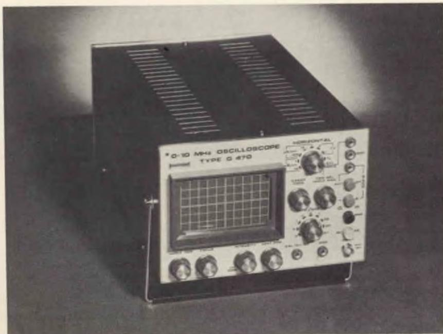
Fig. 2 - Oscilloscopio a larga banda UNAOHM G 470A particolarmente adatto per il servizio TV.
