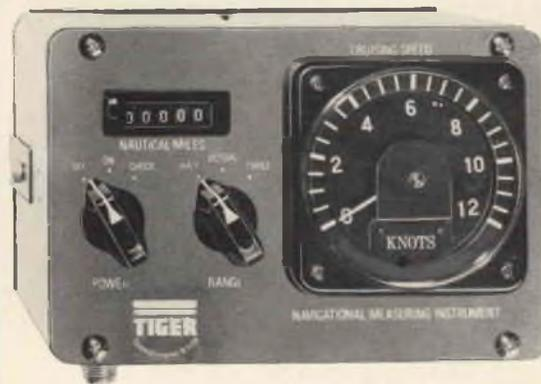
L'apparecchio è fornito in due versioni: una con scala per misure di velocità con scafi a vela, l'altra per scafi a motore.
