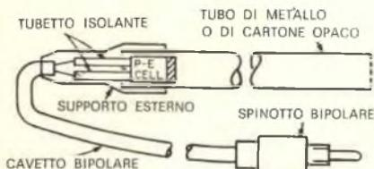
Fig. 5 - Metodo di allestimento di un dispositivo fotosensibile, consistente in una fotocellula ed in un tubo in materiale opaco. I due terminali della fotocellula vengono collegati ad uno dei quattro raccordi, mediante un cavetto bipolare provvisto di spinotto conforme al tipo di raccordo.
