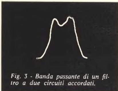
Fig. 3 - Banda passante di un filtro a due circuiti accordati.
