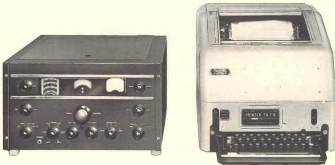
Fig. 1 - Due apparati «Surplus» più frequentemente utilizzati dai radioamatori per la ricezione di trasmissioni in telescrivente. A sinistra il famoso ricevitore della RCA a copertura continua da 500 kHz a 32 MHz AR88, a destra l'altrettanto famosa telescrivente americana TG7.
