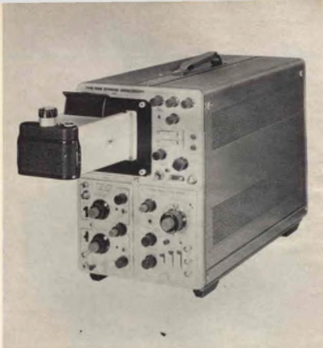
*Apparecchiatura Robot e sistema Polaroid per fotografie di oscillogrammi con finestra per l'osservazione diretta dello oscillografo.*
