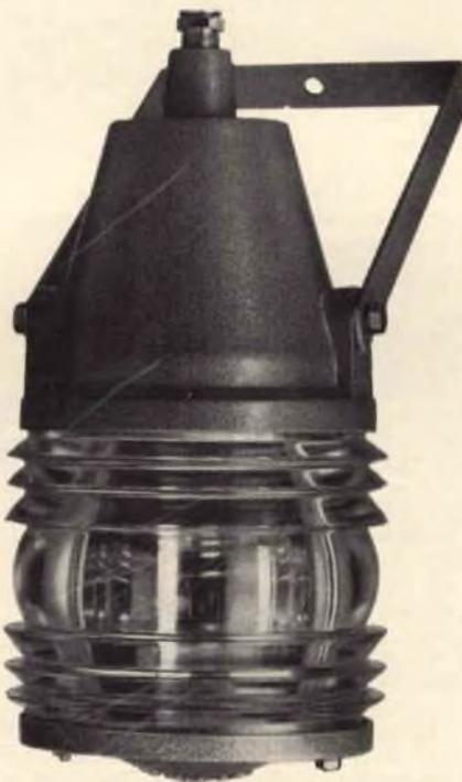
Fig. 5 - Proiettore per esterno della ditta POLLICE per illuminazione di sorveglianza, con ampia illuminazione orizzontale. La lente di Fresnel è circolare, cioè è costituita da un cilindro completo. L'illuminazione da 360° può essere ridotta a 240° e a 180° con riflettore interno.
