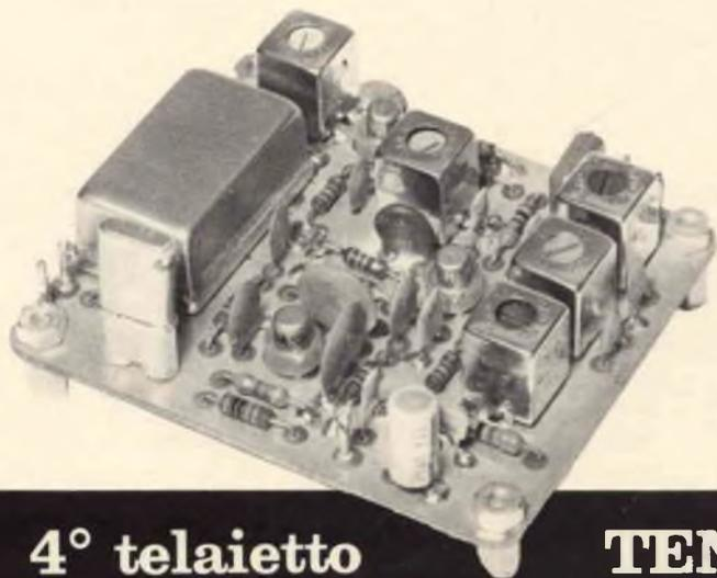
Fig. 1 - Vista di assieme del telaietto di Media Frequenza del ricevitore per FM della Tenko.
