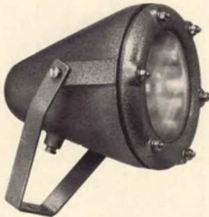
Fig. 4 - Proiettore subacqueo, o per esterni, della ditta POLLICE per lampade speculari da 150 W in vetro satinato. Corpo fuso in lega di alluminio, con schermo frontale in vetro infrangibile trasparente con doppia garanzia.
