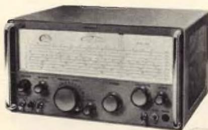
Fig. 6 - Ricevitore Eddystone per la gamma 300 kHz - 30 MHz.
