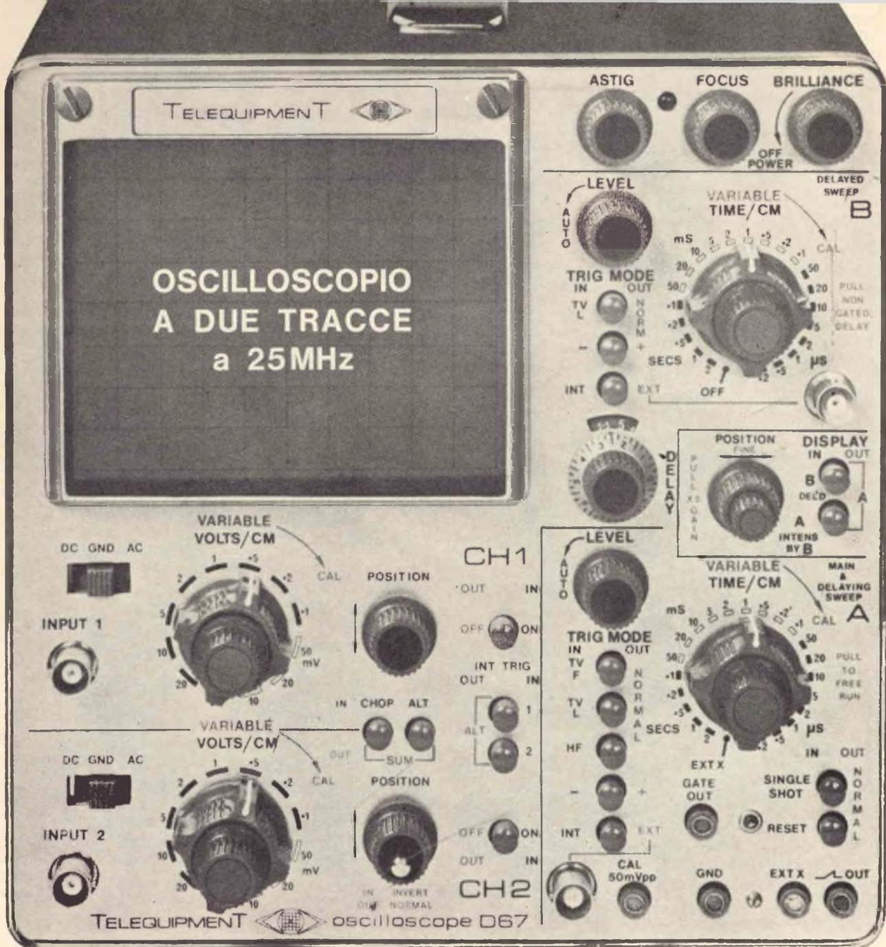
La caratteristica più interessante del nuovo oscilloscopio Telequipment modello D67 è il suo prezzo. Per molto meno di un milione di Lire esso offre due canali a 25 MHz di banda e sensibilità di 10 mV/cm con una precisione di misura di  $\pm 3\%$ .
