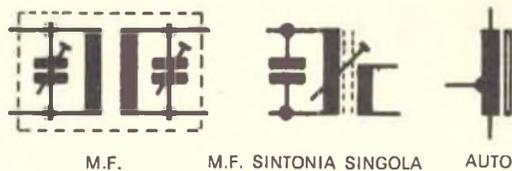
Fig. 17 - Tre diversi esempi di rappresentazione grafica dei trasformatori di media frequenza: il primo tipo a sinistra è munito di due circuiti accordati entrambi regolabili, il secondo presenta la possibilità di sintonia soltanto sul primario, ed il terzo consiste in un unico avvolgimento, munito di presa intermedia.
