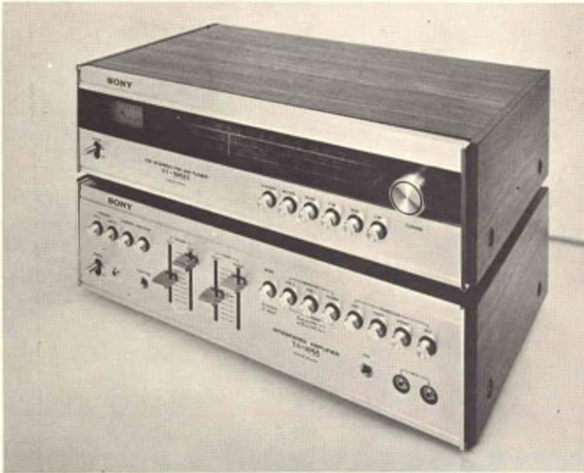
Sintonizzatore Sony mod. ST-5055 L (in alto) e amplificatore TA-1055. Gamme di ricezione: AM/FM. L'amplificatore ha una potenza di uscita di 23 + 23 W.
