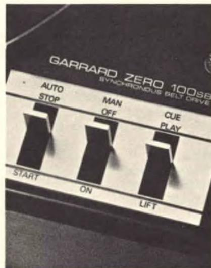
Fig. 7 - Particolare dei comandi a levetta del giradischi Zero 100 SB.
