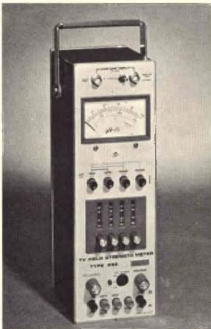
Fig. 1 - Aspetto del misuratore di campo tipo EP592 della UNAOHM.
