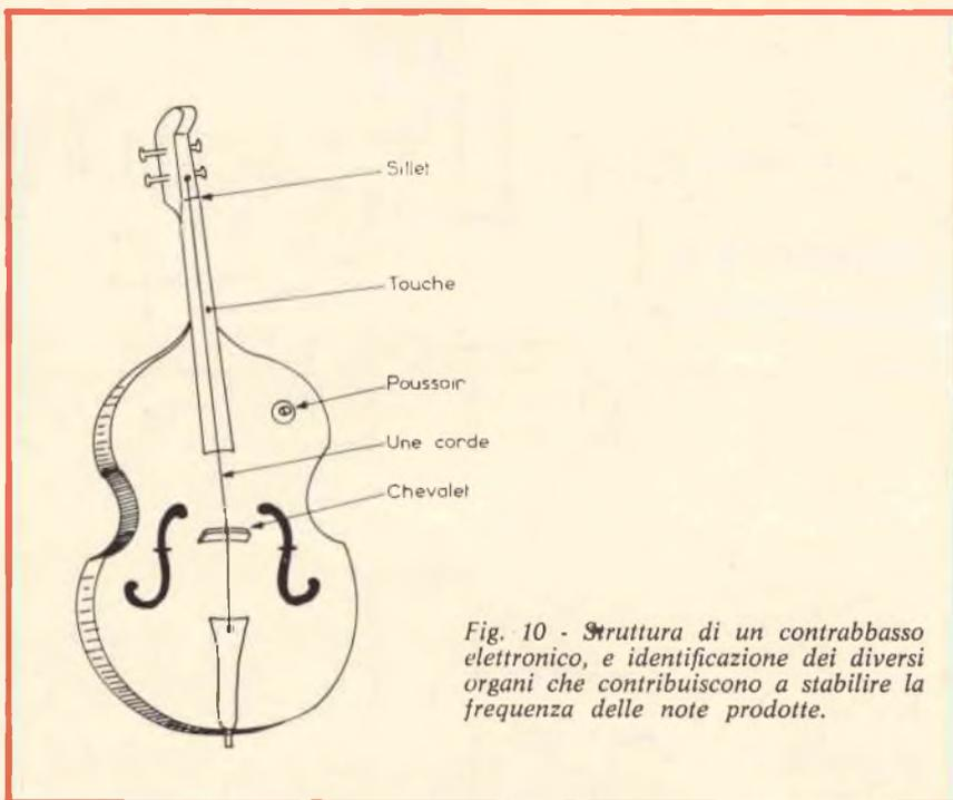
Fig. 10 - Struttura di un contrabbasso elettronico, e identificazione dei diversi organi che contribuiscono a stabilire la frequenza delle note prodotte.
