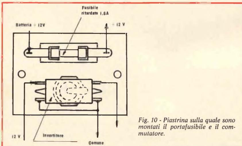
Fig. 10 - Piastrina sulla quale sono montati il portafusibile e il commutatore.
