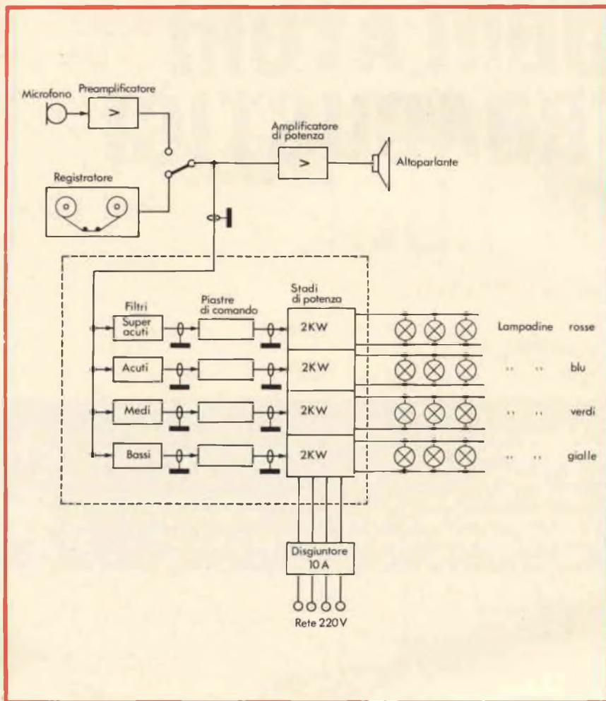
Fig. 2 - Ogni modulatore si compone di un blocco di potenza e di un gruppo di comando a distanza che si possono collocare su di un banco di regia.
