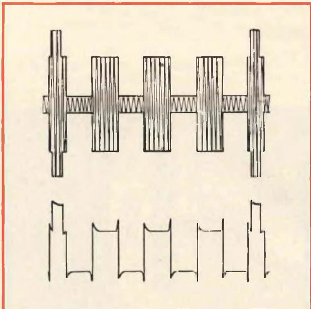
Fig. 3 - Sovraoscillazione (overshoot), in basso, dovuta ad imperfetta sintonia dell'audio. Questo fenomeno è noto con il termine di effetto cammeo.
