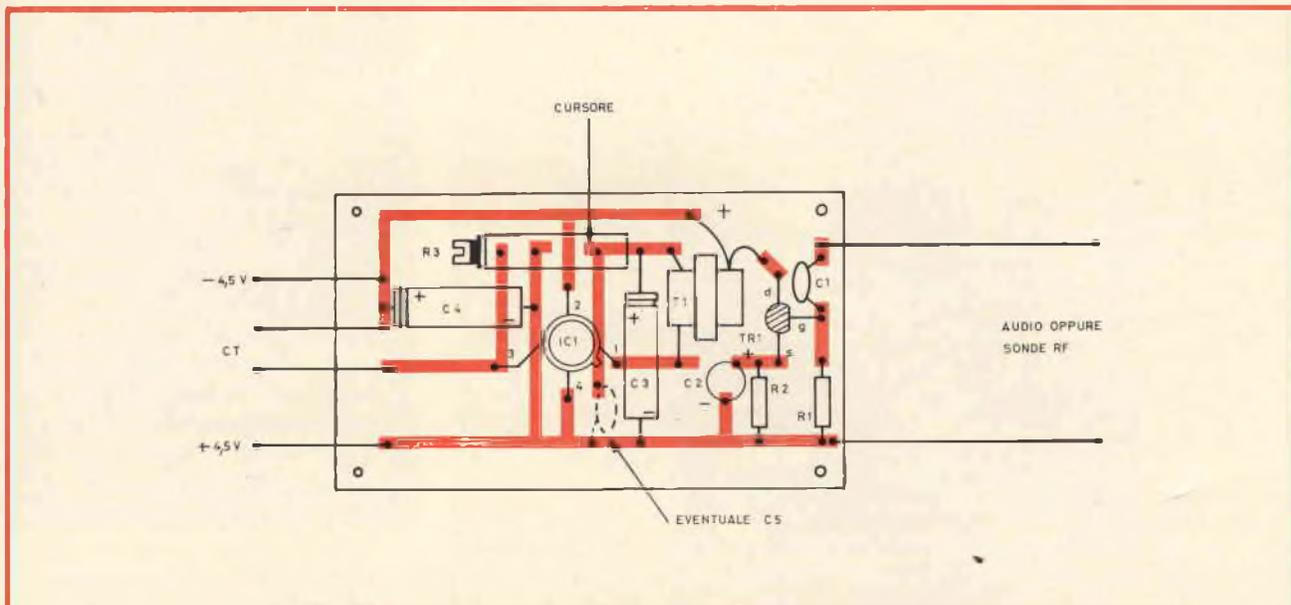
Fig. 9 - Disposizione dei componenti sul circuito stampato relativo allo schema elettrico di figura 6.
