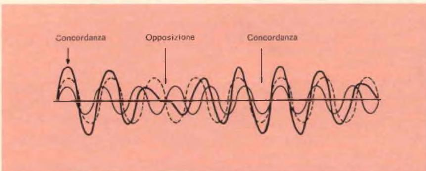
Fig. 6 - Composizione di due oscillazioni di frequenze vicine, la cui risultante mostra i battimenti.
