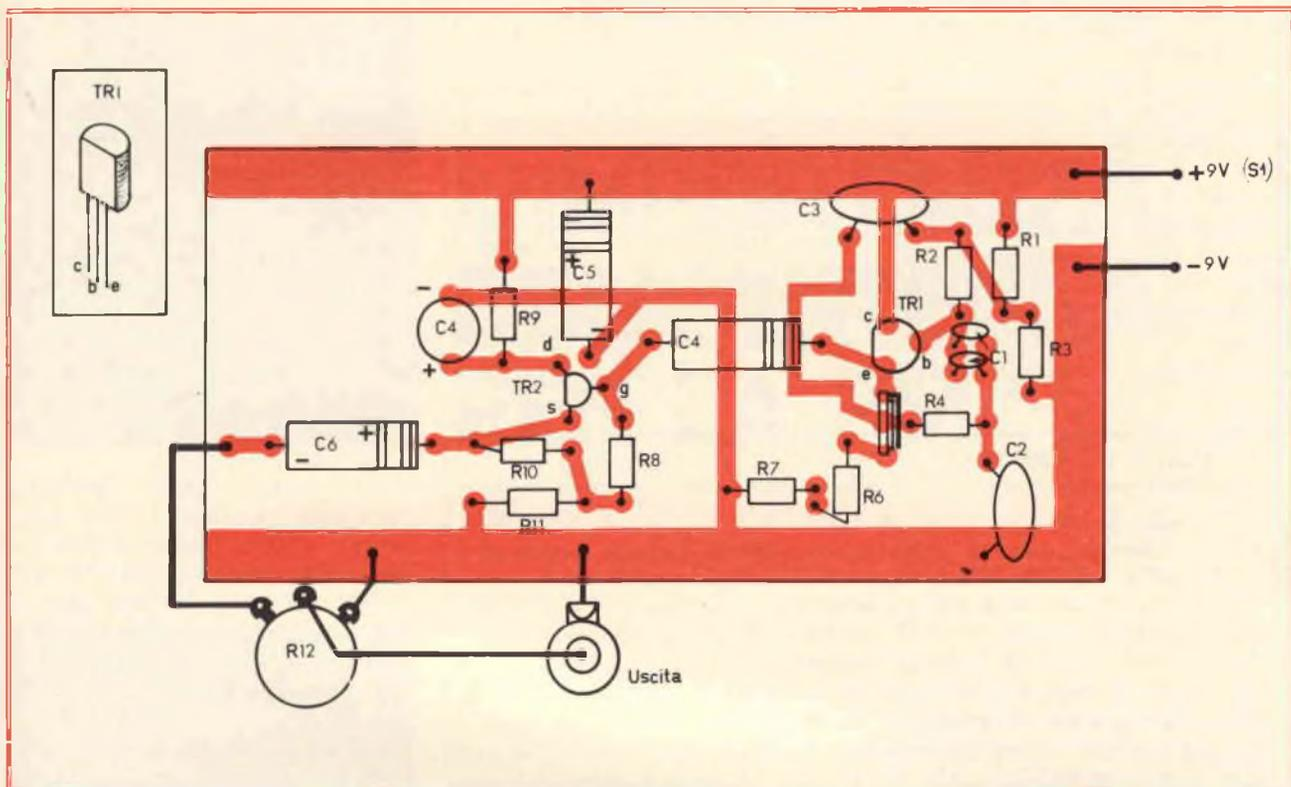
Fig. 7 - Vista dei componenti montati sul circuito stampato relativo allo schema elettrico di figura 6 e disposizione dei terminali del transistor TR1.
