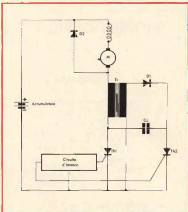
Fig. 4 - Comando di velocità per mezzo di un trasformatore di carico.
