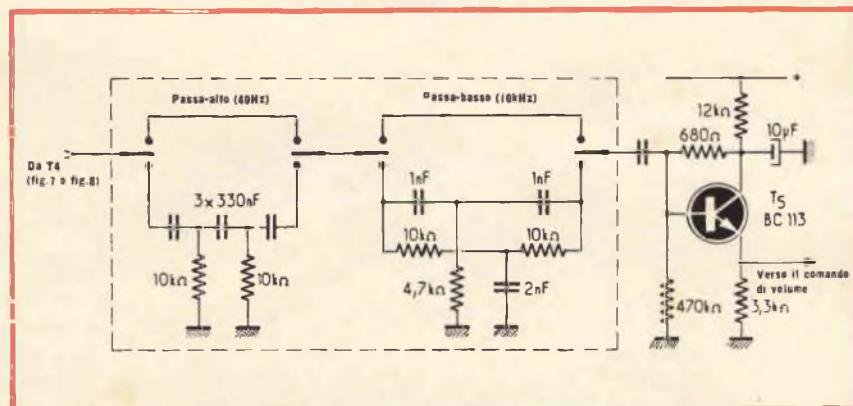
Fig. 9 - Circuito di filtro passa-alto e passa-basso a taglio netto (da 12 a 18 dB per ottava).
