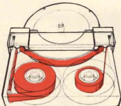
Una volta completamente inserito nell'apparato il nastro magnetico è a contatto con la ruota portatestine. Due guide assicurano un preciso movimento del nastro.
