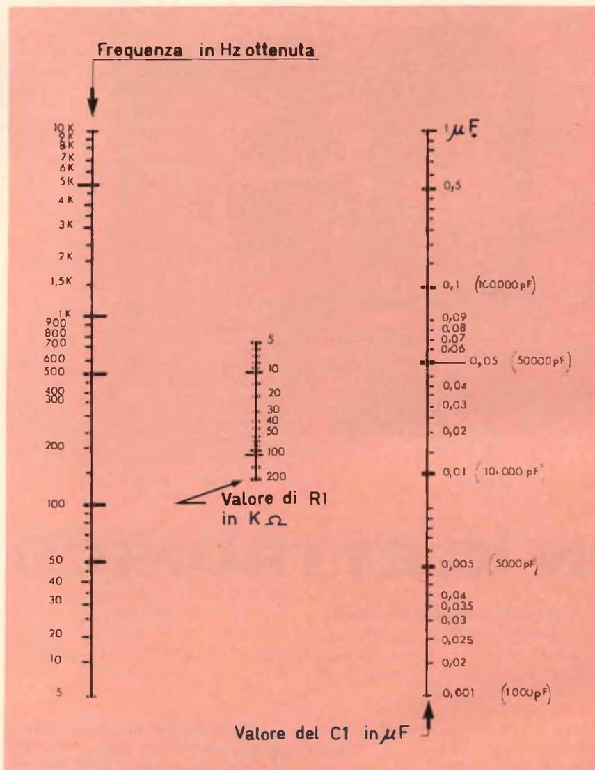
Fig. 2 - Nomogramma per il calcolo di C1 ed R1.
