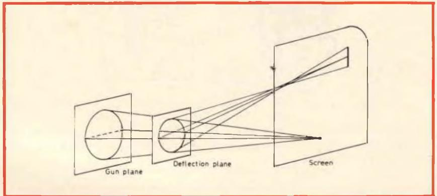
Fig. 5-A - Un raggio circolare da un campo astigmatico viene portato ad una linea di focalizzazione presente sullo schermo.
