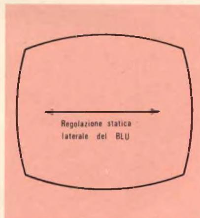
Fig. 2/b - Lo scorrimento prodotto dal magnete laterale del blu che è necessario per poter ottenere la convergenza su un solo punto anziché ai vertici di un triangolo.
