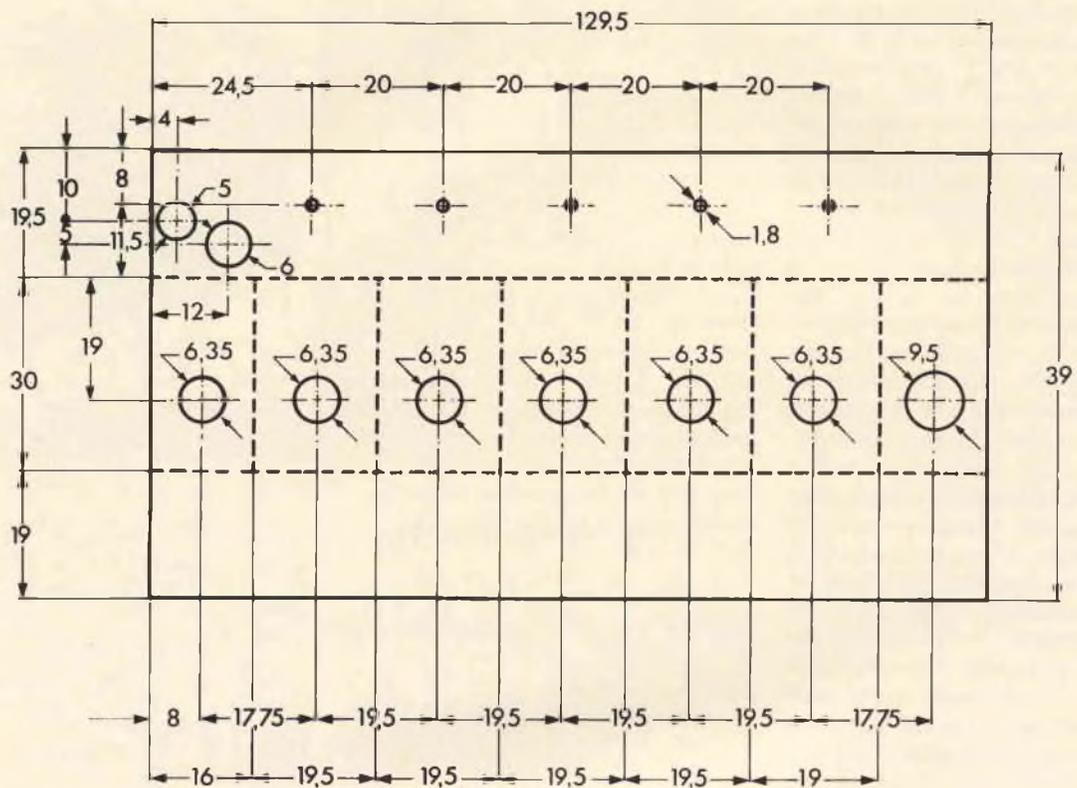
Fig. 7 - Telaio quotato dell'attenuatore di uscita R.F.
