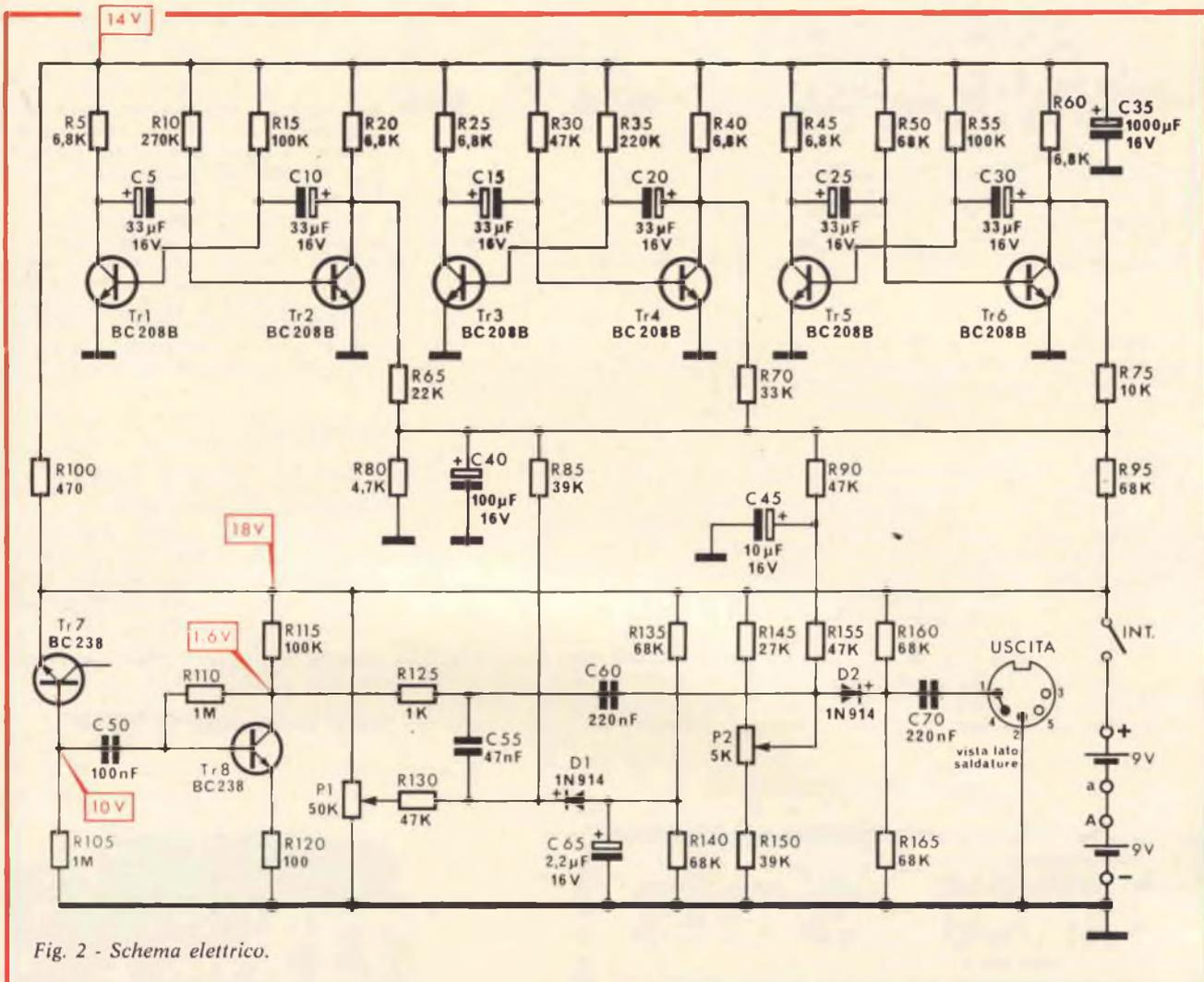
Fig. 2 - Schema elettrico.
