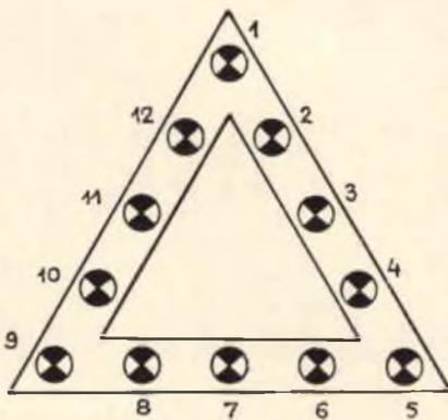
Fig. 6 - Esempio di disposizione delle lampadine sul triangolo di segnalazione.
