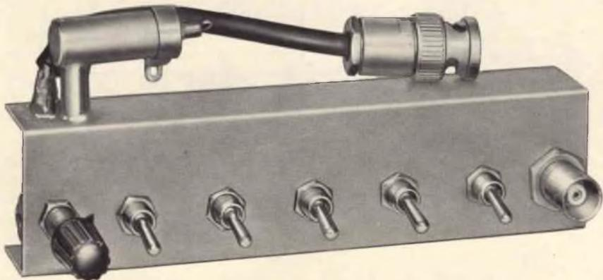
Fig. 10 - Vista frontale dell'attenuatore di uscita R.F. a realizzazione ultimata.
