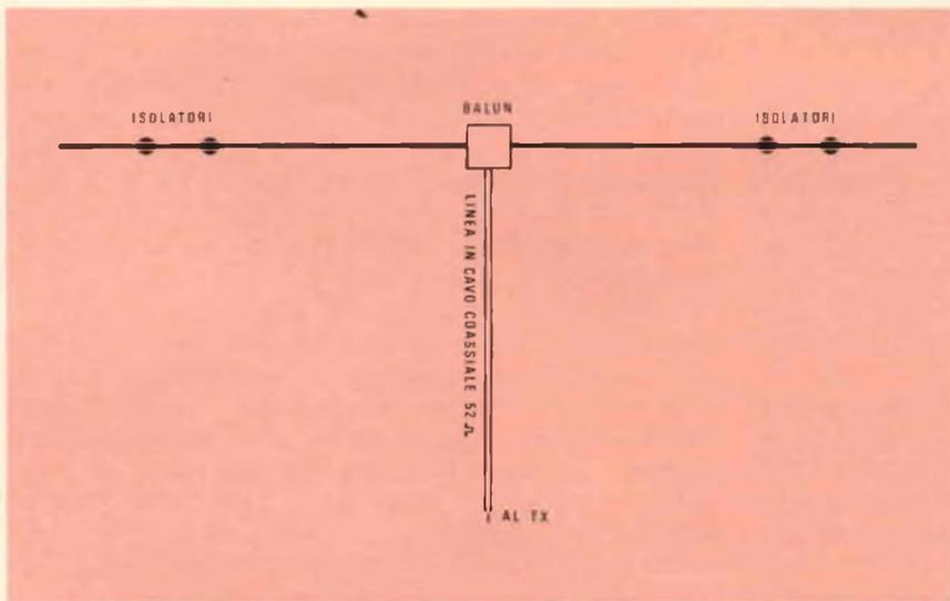
Fig 1 - Sistema di antenna filare in cui il balun è stato installato sulla sommità.
