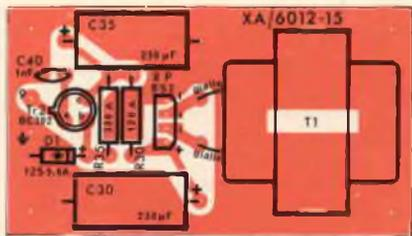
Fig. 6 - Serigrafia del circuito stampato dell'alimentatore.
