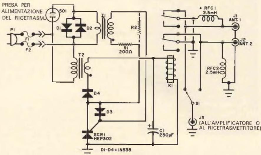
Fig. 1 - Il dispositivo di protezione contro i fulmini prevede l'impiego di due antenne. E' consigliabile alimentare il dispositivo tramite una presa bipolare munita di doppio fusibile, per ottenere un ulteriore effetto protettivo.
