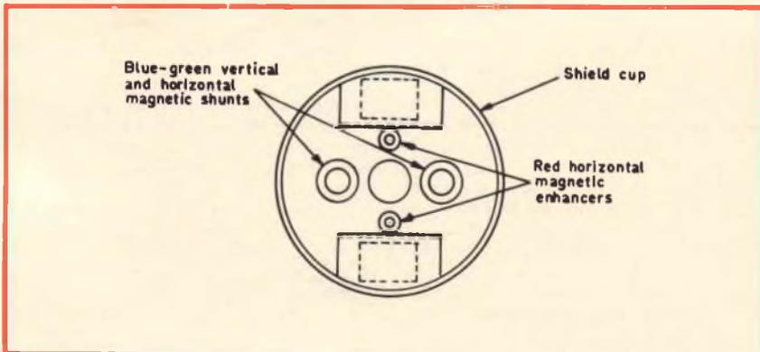
Fig. 8 - Veduta frontale del cannone elettronico di precisione in linea, illustrante la posizione degli «shunt» magnetici.
