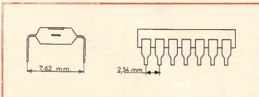
Fig. 1 - Dimensioni d'ingombro di un circuito integrato in contenitore «dual in line».
