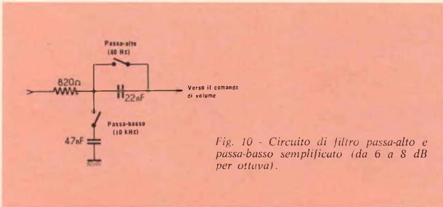
Fig. 10 - Circuito di filtro passa-alto e passa-basso semplificato (da 6 a 8 dB per ottava).
