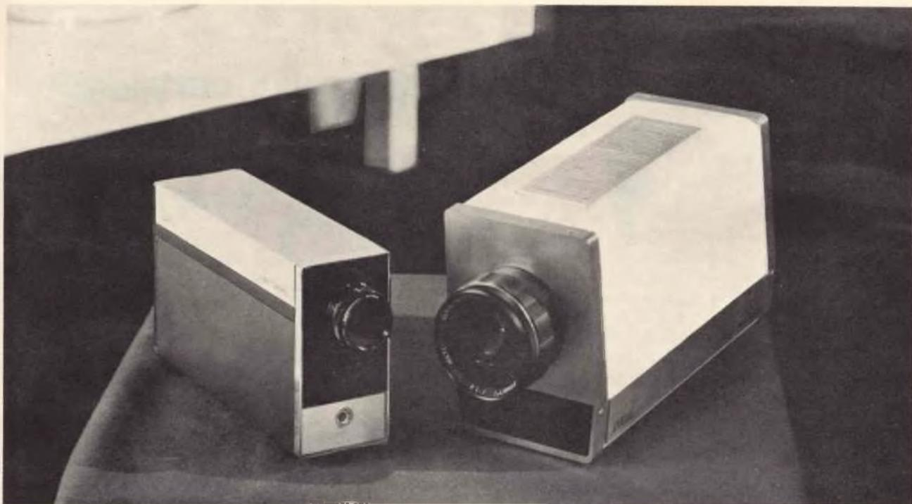
Fig. 6 - Telecamera monocromatica usata con l'apparato SVMT (a sinistra). Telecamera cromatica che impiega un solo tubo vidicon (a destra).
