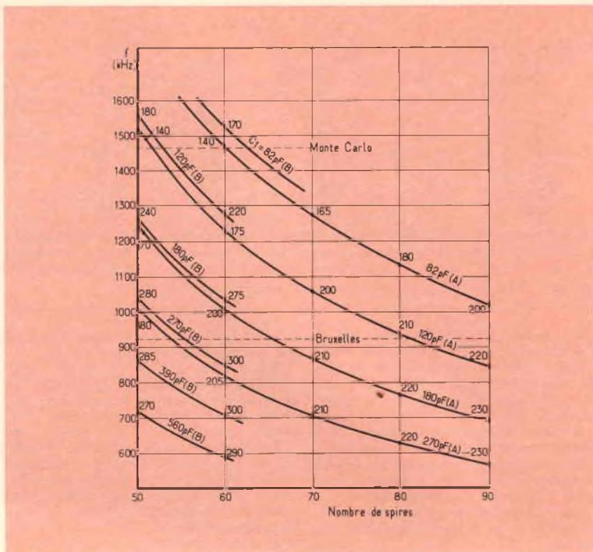
Fig. 2-D - Grafico illustrante le relazioni che intercorrono tra la frequenza di sintonia in kHz ed il numero delle spire, mediante il quale è possibile modificare le caratteristiche del circuito di accordo, in modo da consentire la ricezione di emittenti funzionanti su varie frequenze.
