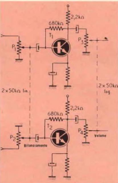
Fig. 12 - Variante del controllo di bilanciamento riportata in fig. 11.
