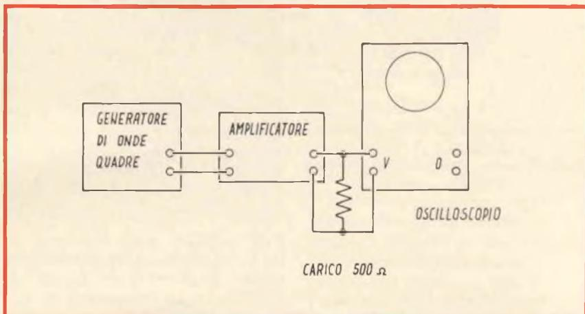
Fig. 9 - Disposizione strumentale per il controllo della curva di risposta di un amplificatore mediante generatore di segnali ad onda quadra.
