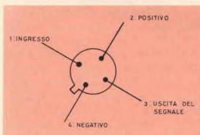
Fig. 6/a - Disposizione dei terminali del circuito integrato TAA263.
