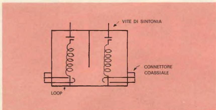
Fig. 11 - Due risonatori accoppiati capacitivamente tramite un'apertura nello schermo centrale di separazione.
