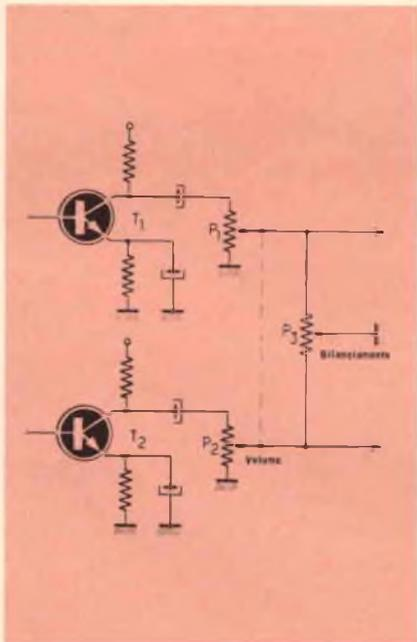
Fig. 13 - Circuito pratico di un controllo di bilanciamento.
