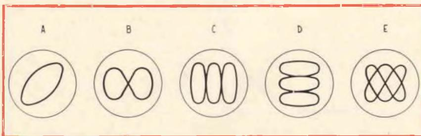
Fig. 1 - Figure di Lissajous relative a differenti rapporti in frequenza.
