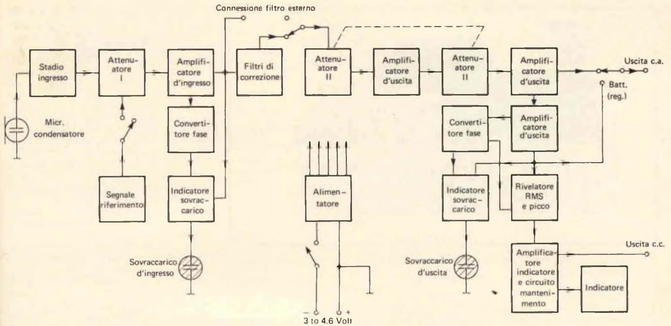
Fig. 5 - Schema a blocchi del fonometro di precisione tipo 2209.
