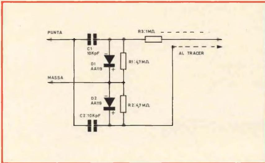
Fig. 4 - Schema elettrico di una sonda «picco-picco» per RF con maggiore sensibilità.
