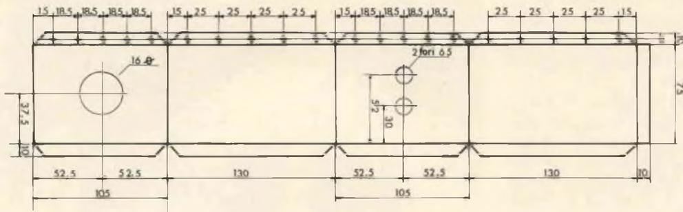
Fig. 5 - Sviluppo laterale del contenitore del dummy load. Nel disegno non sono riportati i fori di fissaggio delle piastre con le resistenze. Tutti i fori filettati sono da 3 mm di diametro.
