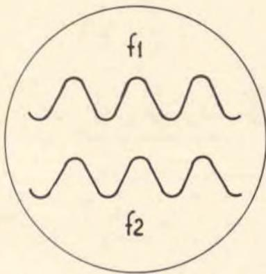
Fig. 3 - Tracce relative a due frequenze, come si può osservare sullo schermo di un oscilloscopio a doppia traccia oppure sullo schermo di un oscilloscopio a traccia singola con commutatore elettronico.
