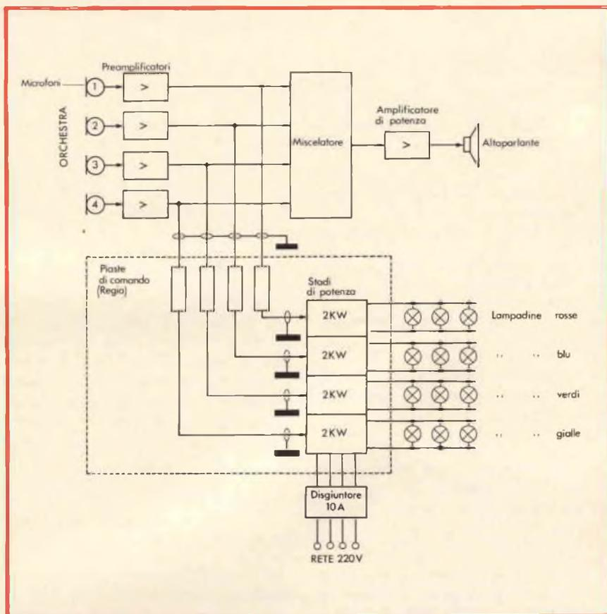
Fig. 1 - Schema di principio: in generale si utilizzano quattro modulatori, ognuno dei quali comanda un gruppo di lampade dello stesso colore.
