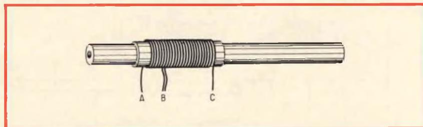
Fig. 2-A - Struttura della bobina di antenna, costituita da un unico avvolgimento con presa intermedia, praticato su di un tubetto di materiale isolante che scorre sul nucleo in ferrite.
