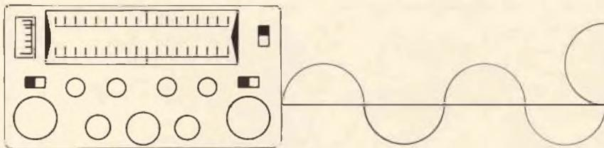
Fig. 2 - Quando i valori d'impedenza dell'antenna, dell'uscita del trasmettitore e della linea sono perfettamente identici non esiste alcun fenomeno perturbatorio ed il rendimento della linea è del 100%.
