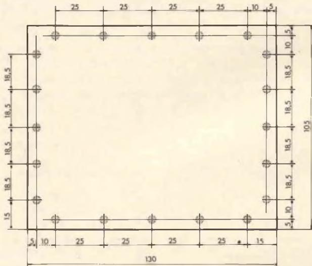
Fig. 6 - Coperchio del contenitore del dummy load. Tutti i fori sono da 3 mm di diametro.
