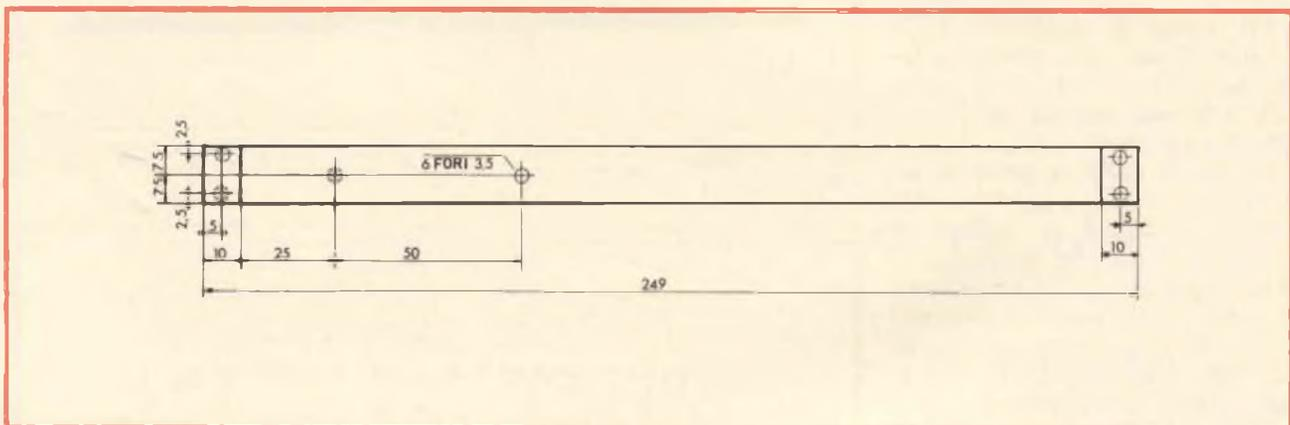
Fig. 12 - Longheroni di ottone che servono a reggere il trasformatore, le pile e il carico fittizio.
