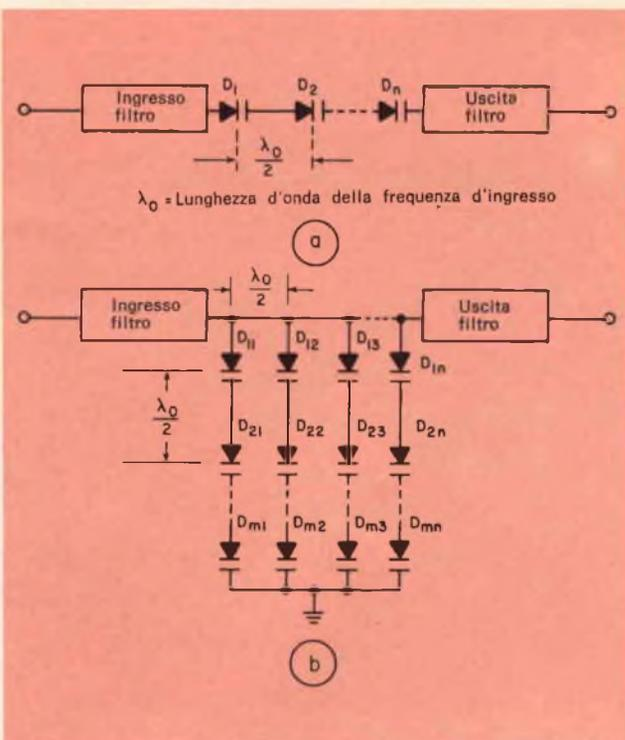
Fig. 1 - La potenza dei diodi varactor può essere aumentata con una disposizione in serie (a) od in parallelo (b) di singoli diodi. Le prestazioni possono inoltre essere incrementate nel caso di diodi montati in un unico contenitore come nella tecnica multi-chip.
