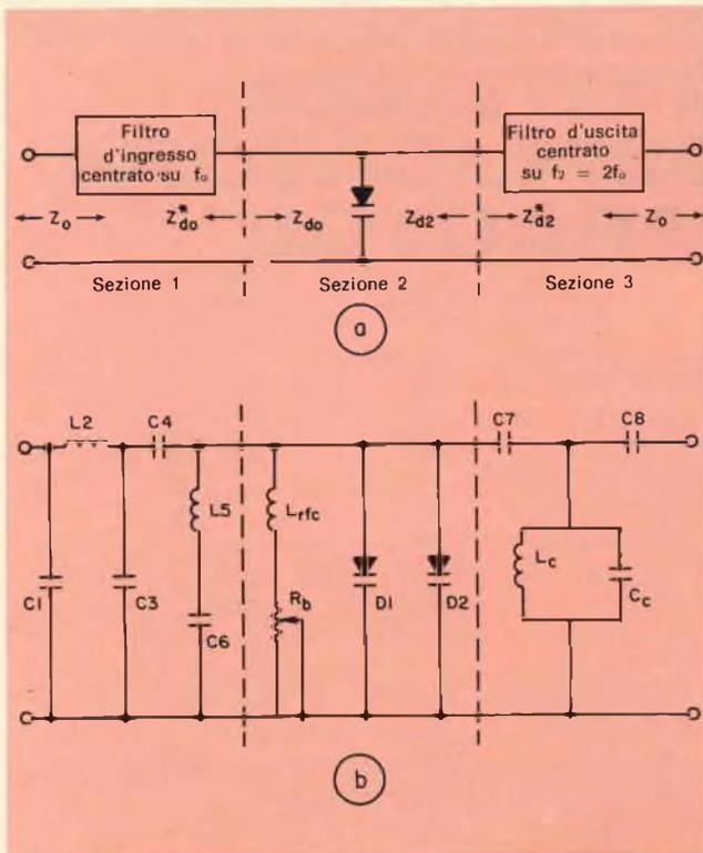
Fig. 2 - Qualunque progetto di moltiplicatore può essere ridotto ad una combinazione diodi-filtri (a). Per il moltiplicatore duplicatore da 80 W il circuito equivalente è rappresentato con elementi discreti (b). I condensatori  $C_1$  e  $C_8$  permettono l'accoppiamento ingresso diodi. Il filtro di uscita è del tipo a cavità.
