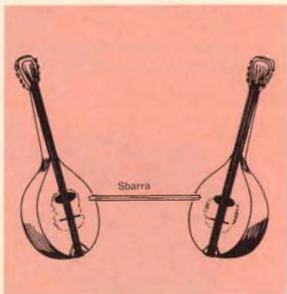
Fig. 8 - Il collegamento tra sorgente e risonatore può anche essere di natura meccanica. Per esempio due mandolini accoppiati da un sbarra.
