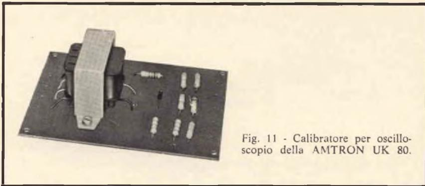
Fig. 11 - Calibratore per oscilloscopio della AMTRON UK 80.
