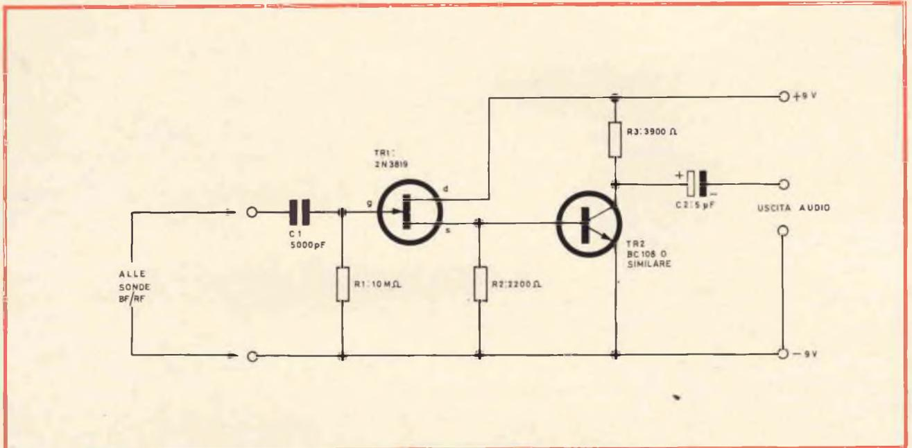
Fig. 1 - Schema elettrico fondamentale del «tracer».
