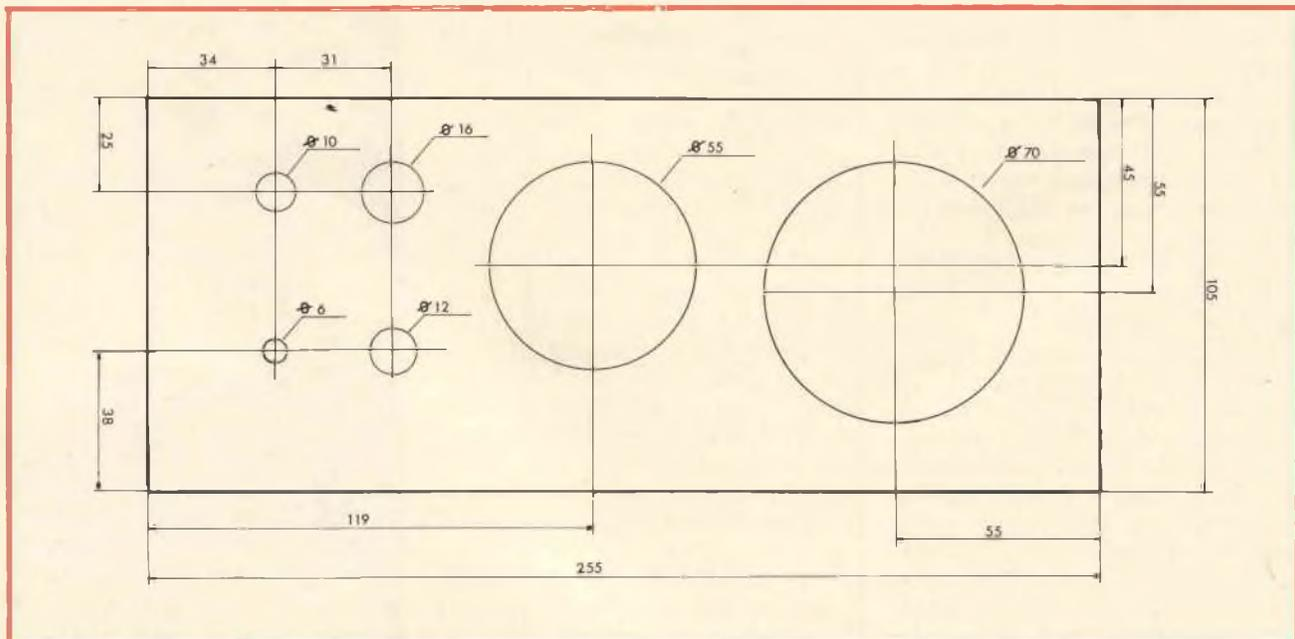
Fig. 4 - Piano di foratura del pannello frontale in scala 1 : 2.
