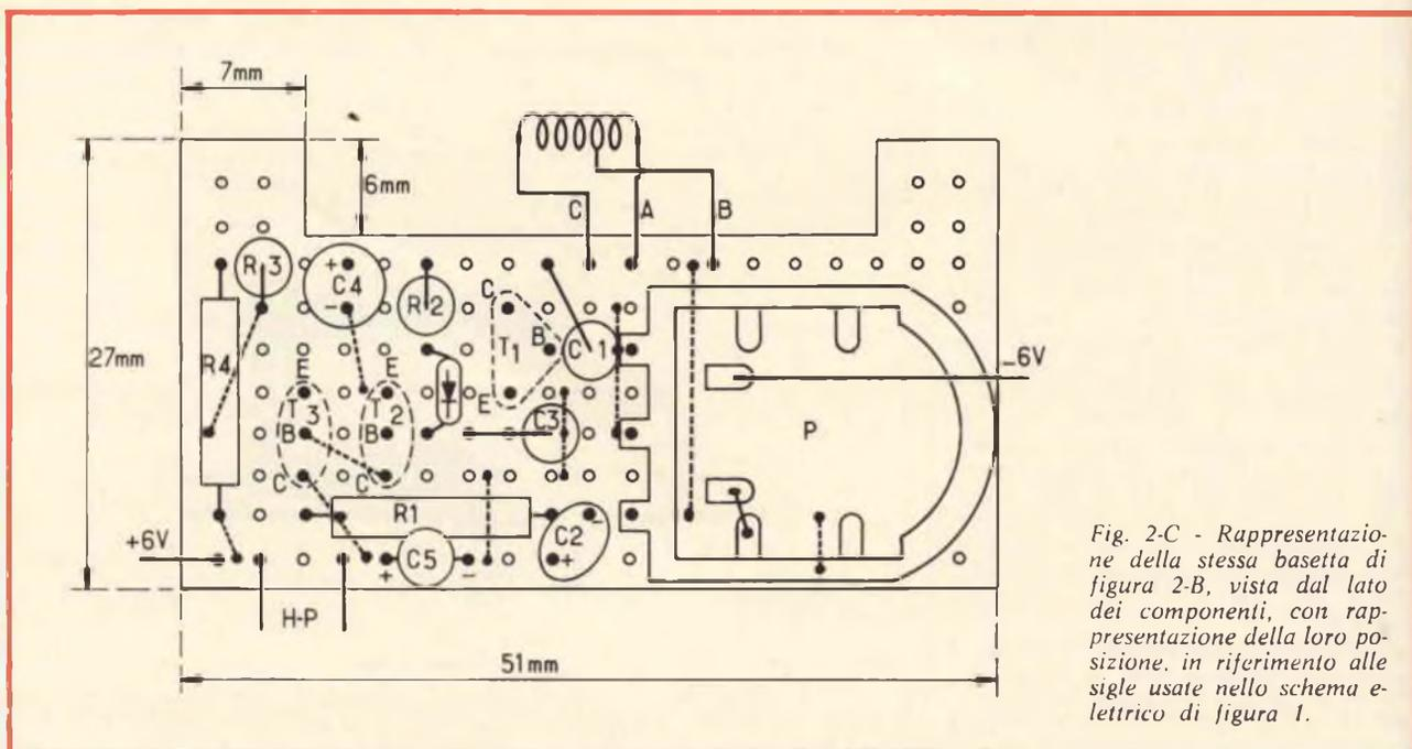
Fig. 2-C - Rappresentazione della stessa basetta di figura 2-B, vista dal lato dei componenti, con rappresentazione della loro posizione, in riferimento alle sigle usate nello schema elettrico di figura 1.
