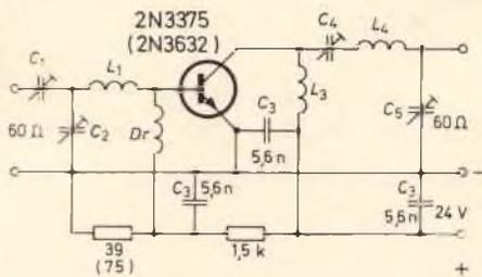
Fig. 3 - Schema del circuito dell'amplificatore lineare.
