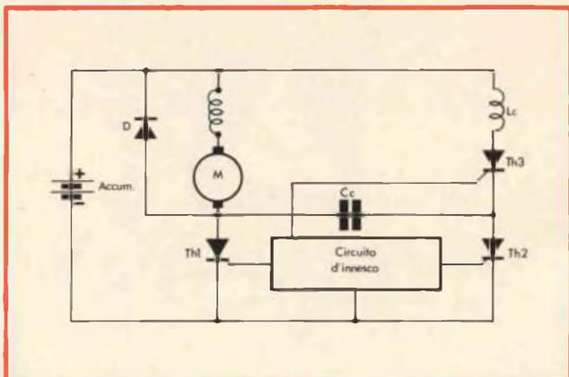
Fig. 3 - Comando di velocità per mezzo di un carico induttivo.
