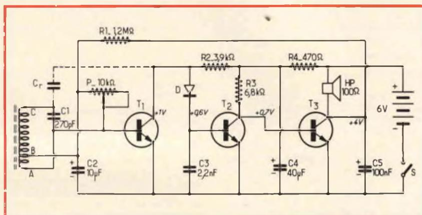
Fig. 1 - Schema elettrico del ricevitore elementare a tre stadi, destinato alla ricezione di un particolare tipo di trasmissione effettuata in Francia. Dimensionando opportunamente il circuito accordato — tuttavia — questo ricevitore può essere usato anche per la ricezione delle normali emittenti ad onde medie, con accordo a frequenza fissa.
