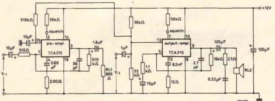
Fig. 2 - Esempio di applicazione pratica del circuito integrato TCA 210 in un sistema interfonico.
