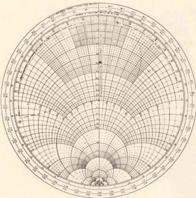
Fig. 3 - Il calcolo degli elementi di accoppiamento d'ingresso  $C_4$  ed  $L_5$  può essere condotto, con l'aiuto del diagramma di Smith, in forma grafica. Per l'avvio del calcolo occorre conoscere  $Z_A$ , valore di impedenza pari alla metà di quella del diodo.
