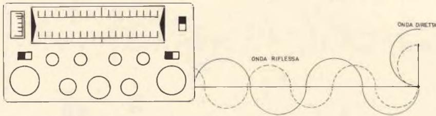
Fig. 3 - Se l'antenna non rimane nella frequenza di emissione, cioè quando la sua impedenza è diversa da quella d'uscita del trasmettitore e da quella del cavo, l'energia AF non viene totalmente irradiata dall'antenna perché una parte ritorna attraverso il cavo (onda riflessa) nello stadio finale del trasmettitore.
