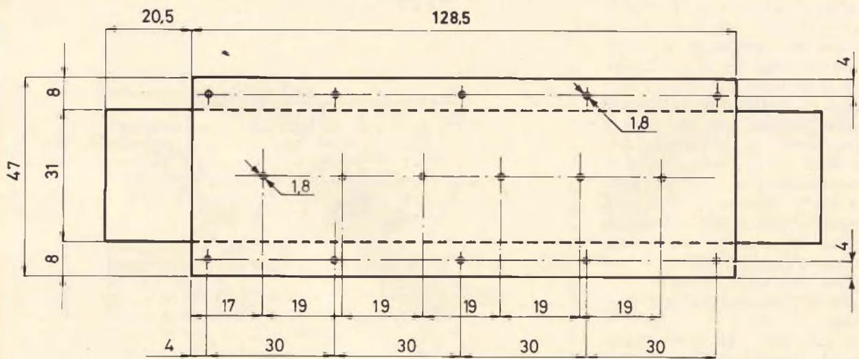
Fig. 8 - Scatola schermante dell'attenuatore di uscita R.F.
