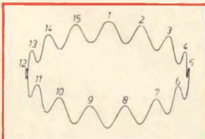
Fig. 7 - Traccia relativa ad una base dei tempi ellittica ( $f_1/f_2 = 15$ ).
