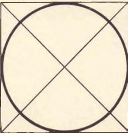
Fig. 4 - Figura relativa alla traccia di due tensioni alternate aventi identica ampiezza ottenute con l'impiego di una base dei tempi circolari.
