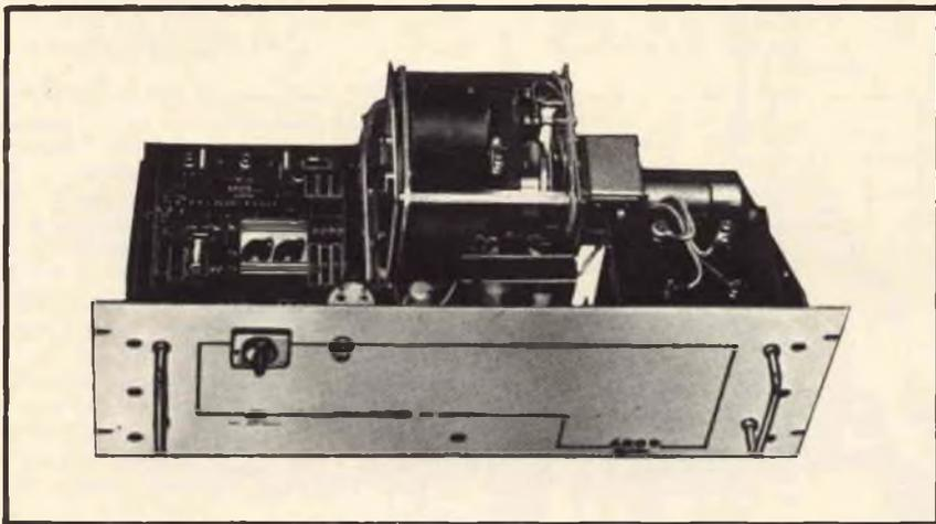
Fig. 8 - Unità stabilizzatrice da 2,5 VA 220 V  $\pm$  15% e 220 V  $\pm$  1% realizzata dalla ditta AROS.
