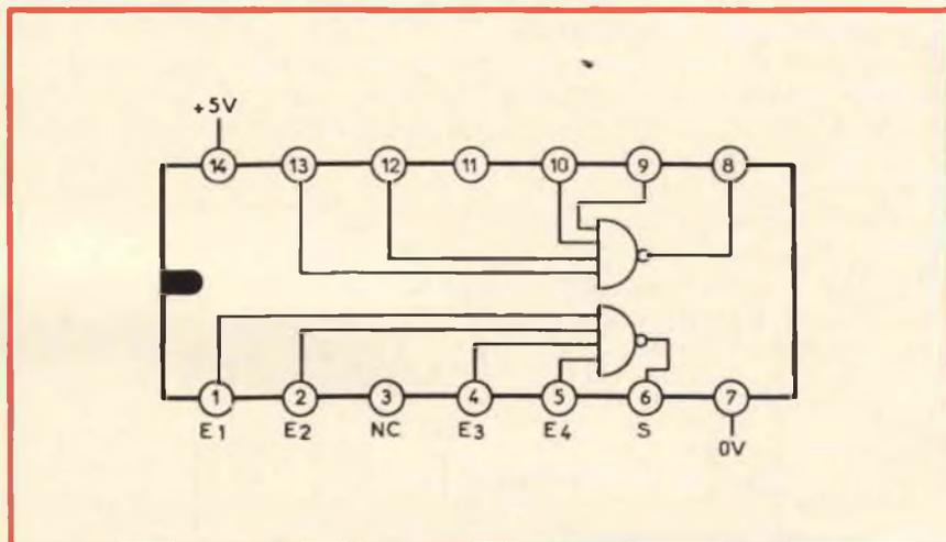
Fig. 4 - Schema elettrico interno del circuito integrato SN7413N.
