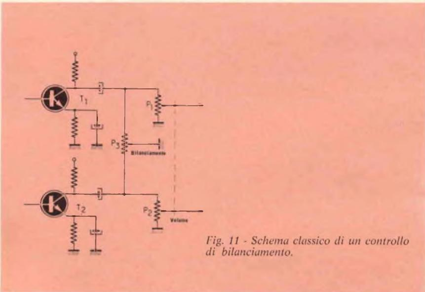
Fig. 11 - Schema classico di un controllo di bilanciamento.
