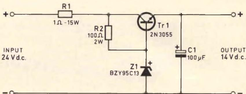
Fig. 3 - Riduttore di tensione elettronico 24 Vc.c. / 14 Vc.c. AMTRON UK 602 per l'uso di apparecchi radio alimentati a 12 V a bordo di autotreni, camion e autobus.
