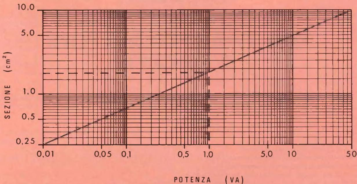
Fig. 1 - Grafico mediante il quale viene semplificato il calcolo della sezione del nucleo, in centimetri quadrati, in funzione della potenza primaria, espressa in volt/ampère. Una volta individuato il valore della potenza sulla scala inferiore, si segue la retta verso l'alto fino ad incontrare la diagonale. Dal punto di intersezione, si segue la retta orizzontale verso sinistra, fino a leggere sulla scala verticale il valore della sezione.
