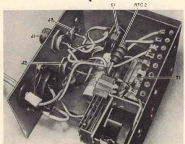
Fig. 2 - Fotografia illustrante la tecnica di montaggio dei componenti, che risulta assai più facile se i bordi inferiori del telaio metallico vengono piegati verso l'esterno, durante le operazioni di allestimento. La sezione «A» di questa figura e la sezione «B» illustrano l'apparecchio montato visto da due diverse posizioni, per chiarire la tecnica di montaggio della maggior parte dei componenti.
