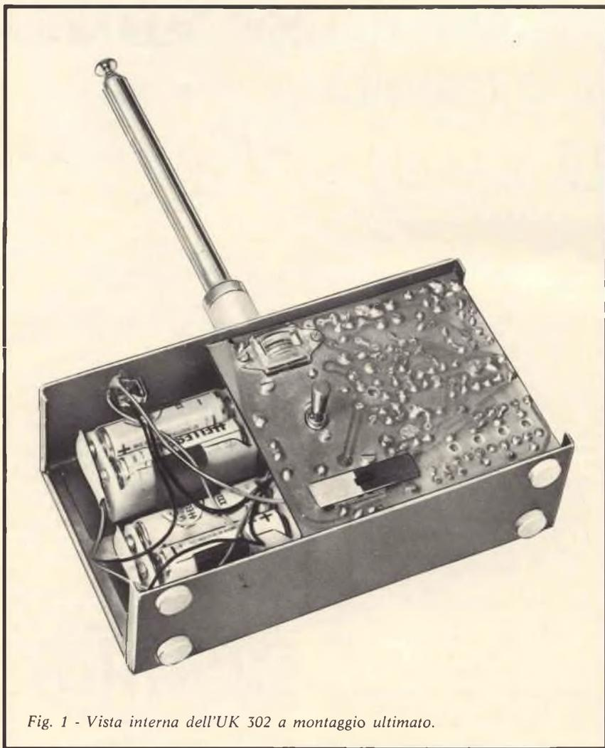
Fig. 1 - Vista interna dell'UK 302 a montaggio ultimato.
