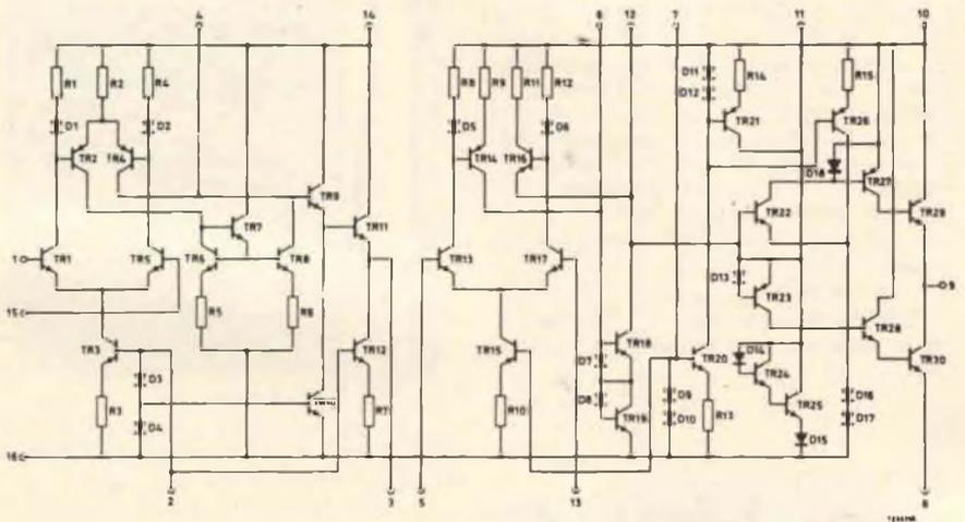
Fig. 1 - Schema elettrico del circuito integrato per interfonici PHILIPS - TCA 210.
