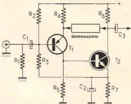
Fig. 4 - Schema di principio di uno stadio di preamplificazione equipaggiato di un transistor P-N-P e di un N-P-N.
