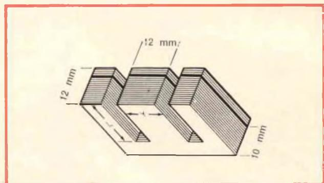
Fig. 2 - Esempio tipico di pacco lamellare sul quale è possibile avvolgere un piccolo trasformatore di uscita. La riga in neretto evidenzia la parte in eccesso che può essere eliminata per ridurre la sezione effettiva del nucleo.
