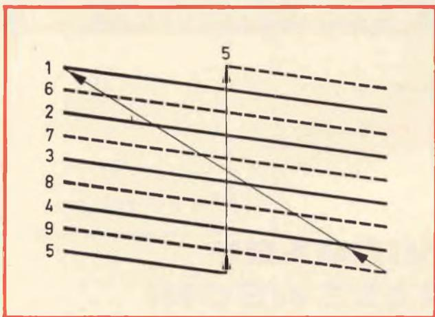
Fig. 2 - Esempio pratico di interlacciatura delle righe del quadro pari con le righe del quadro dispari che consente di ottenere una migliore stabilità d'immagine.
