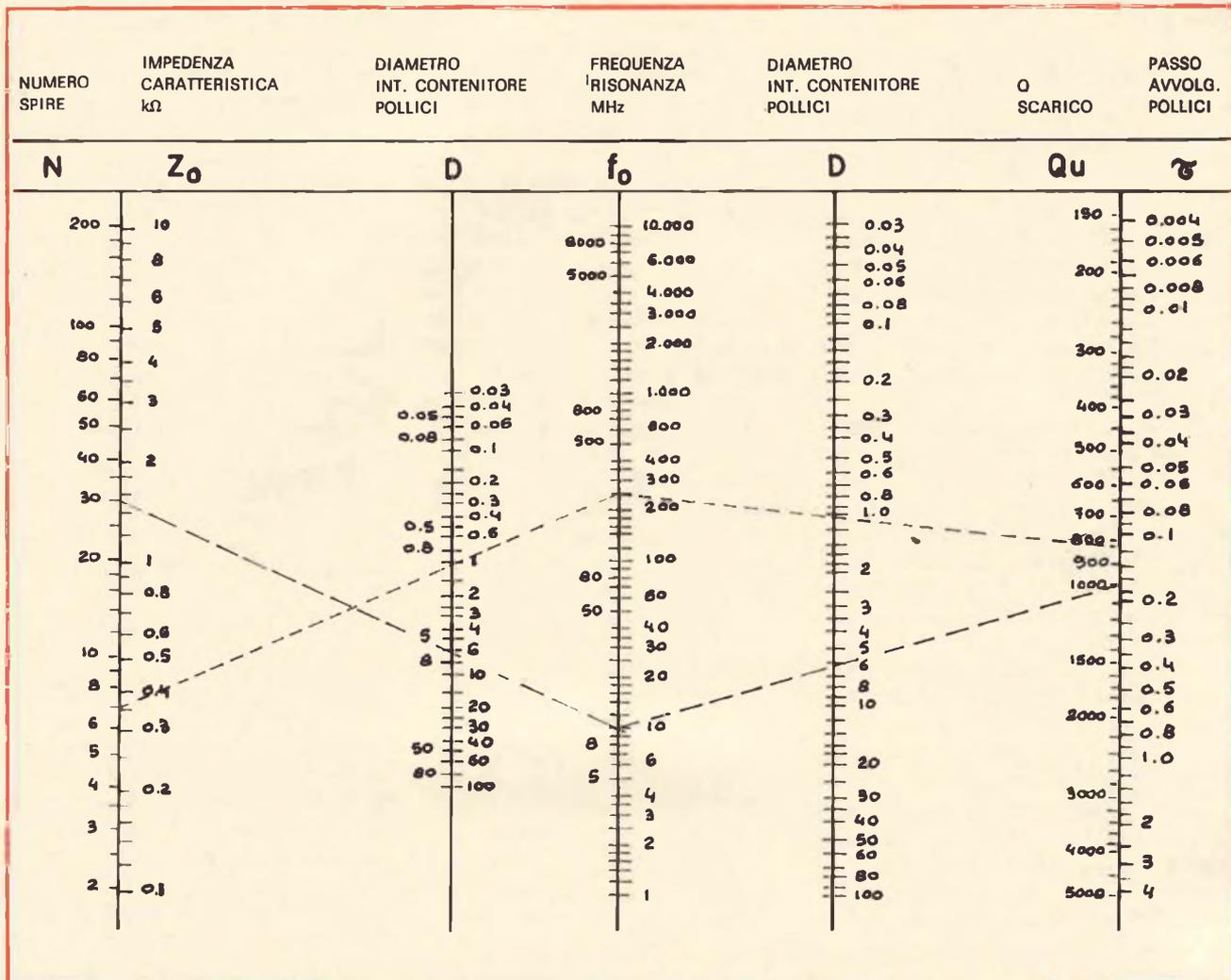
Fig. 4 - Nomogrammi per il calcolo dei filtri ad elica.
