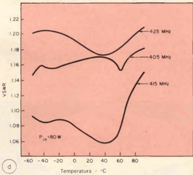
Fig. 4 - La misura dei risultati del moltiplicatore mette in evidenza una funzione lineare ingresso-uscita della potenza (a), una larghezza di banda a  $-1$  dB pari al 14% di (b). E' possibile l'esercizio a temperature oltre  $80^\circ\text{C}$  della piastra base (c) mentre il VSWR (rapporto onde stazionarie) si mantiene al disotto del valore 1,22 per temperature comprese tra  $-60$  e  $90^\circ\text{C}$ .
