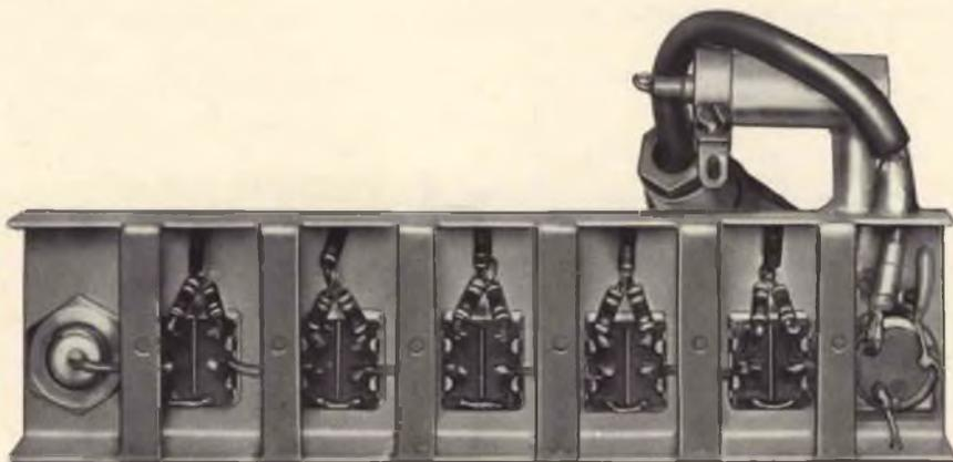
Fig. 9 - Vista interna del prototipo dell'attenuatore di uscita R.F.
