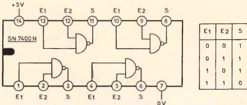
Fig. 3 - Circuito interno del circuito integrato SN7400N con relativa tavola della verità.
