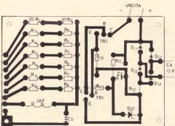
Fig. 14 - Disposizione dei componenti sul circuito stampato.
