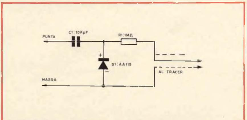
Fig. 3 - Schema elettrico di un rivelatore per impieghi generali, attivo fino a circa 40 MHz.
