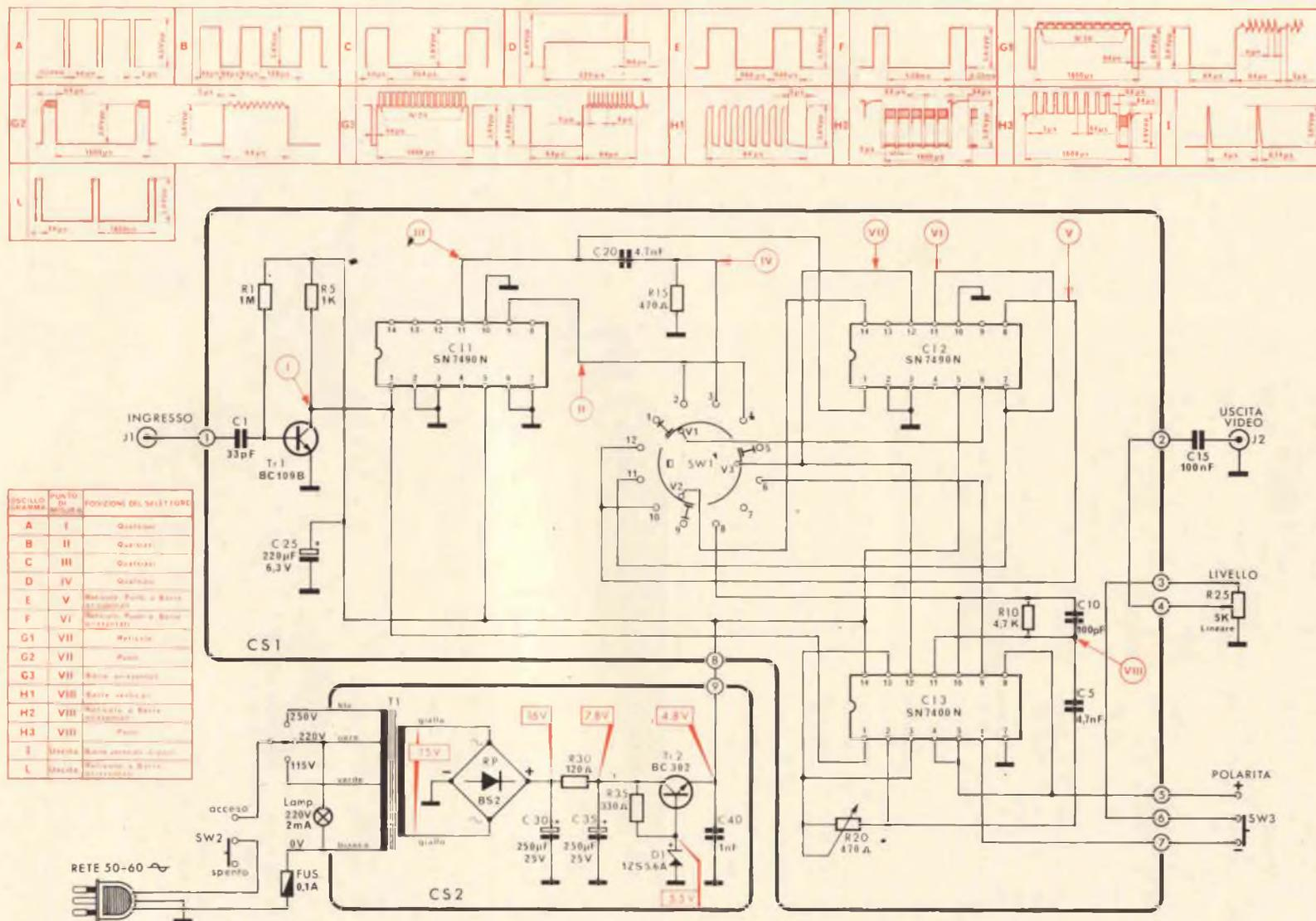
Fig. 3 - Schema elettrico.
