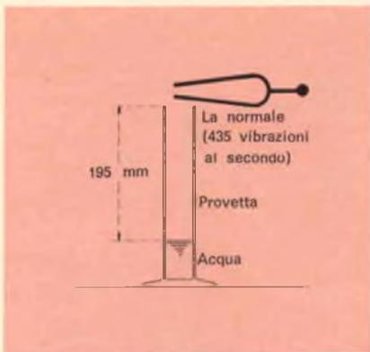
Fig. 10 - Esempio di risonanza in quarto d'onda.
