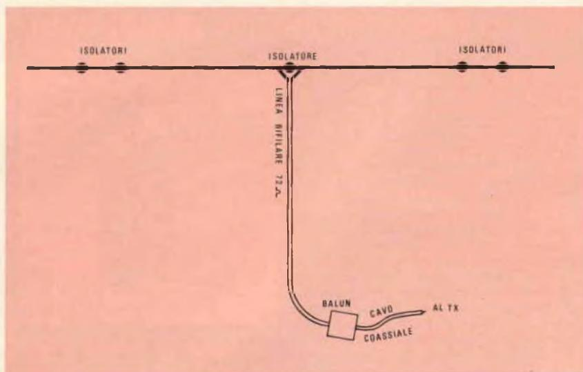
Fig. 3 - Antenna con balun installato al termine della linea di alimentazione con discesa in twin feed line da  $72 \Omega$ .
