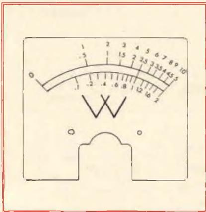
Fig. 16 - Scala del Wattmetro.
