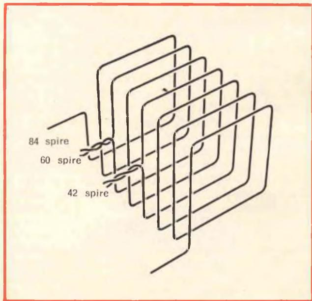
Fig. 4 - Metodo di applicazione di prese intermedie lungo un unico avvolgimento. Se la sezione del filo rimane costante, è sufficiente ripiegare il cavo ed intrecciarlo. Se invece la sezione del conduttore deve essere variata, occorre effettuare una saldatura in corrispondenza di ciascuna presa.
