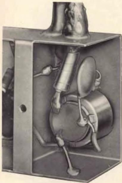
Fig. 13 - Particolare dell'attenuatore potenziometrico e della rivelazione del segnale R.F.
