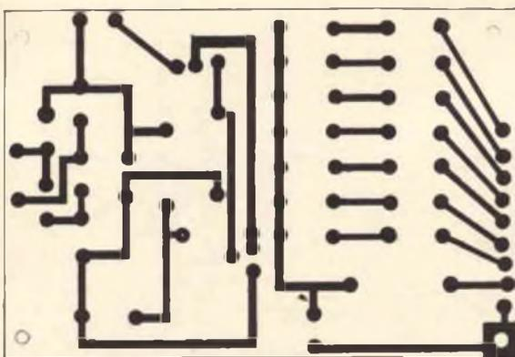
Fig. 13 - Circuito stampato visto dal lato rame. Il disegno è in scala 1:2.
