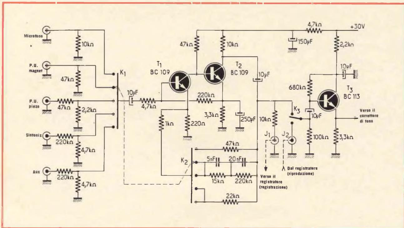
Fig. 6 - Esempio pratico di preamplificatore con stadio P-N-P/N-P-N. Gli ingressi ad alto livello fanno capo direttamente al commutatore  $k_1$ .
