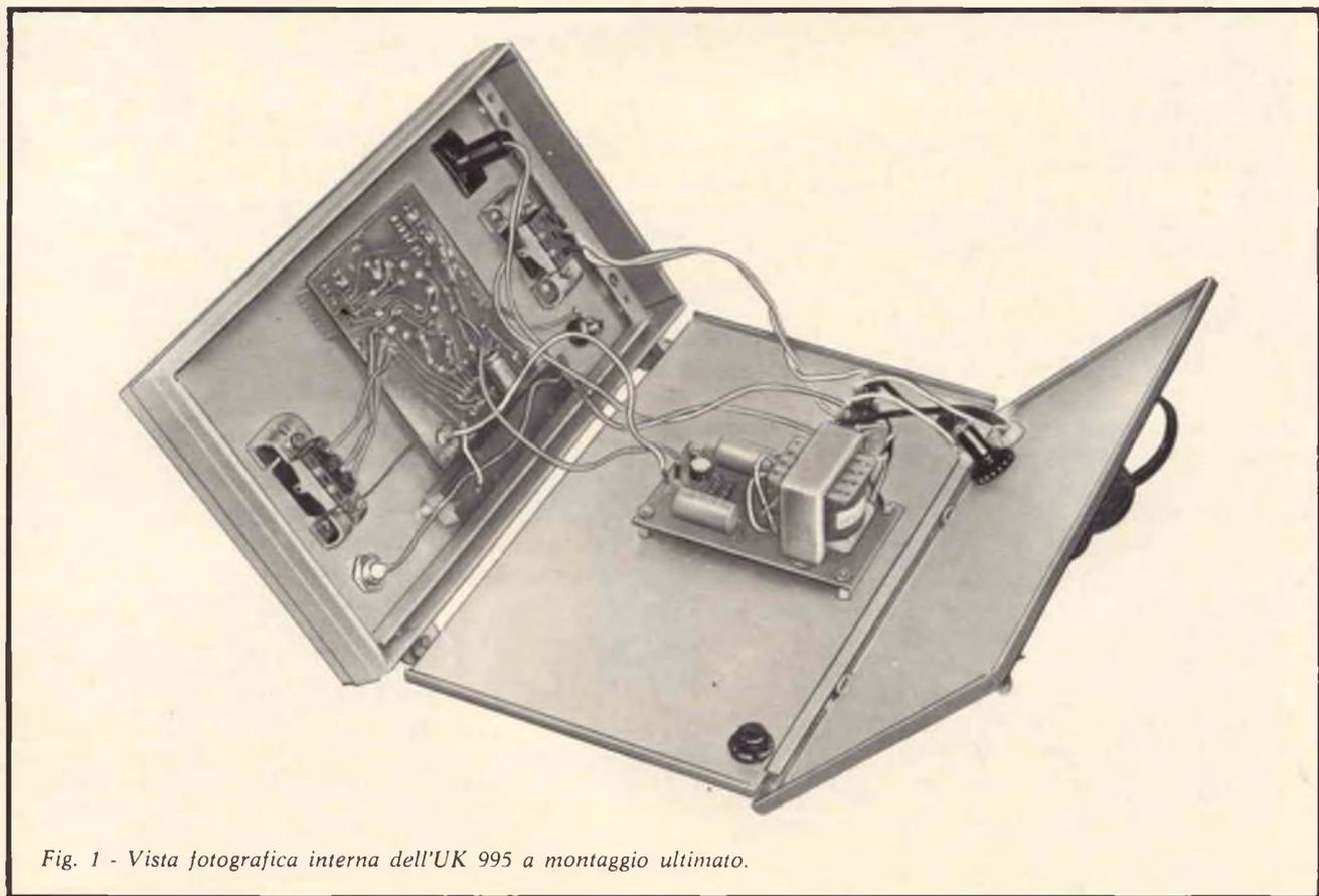
Fig. 1 - Vista fotografica interna dell'UK 995 a montaggio ultimato.
