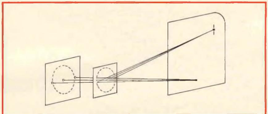
Fig. 5-B - Tre raggi presenti sull'asse orizzontale di un grosso fascio elettronico vengono sempre fatti convergere ad opera del campo astigmatico di deflessione.
