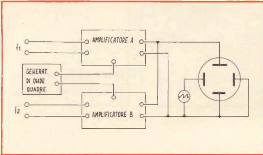
Fig. 2 - Schema di principio di un commutatore elettronico per ottenere due tracce sullo schermo in un oscilloscopio a singola traccia.
