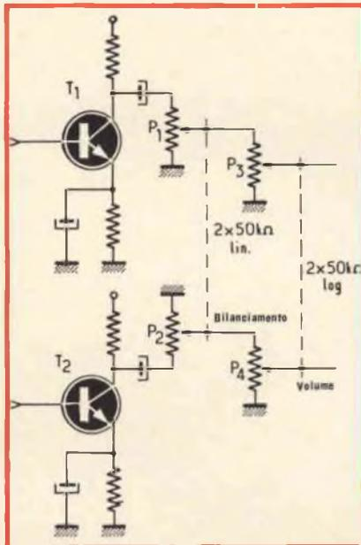
Fig. 14 - Variante migliorata del comando di bilanciamento riportato in fig. 13.
