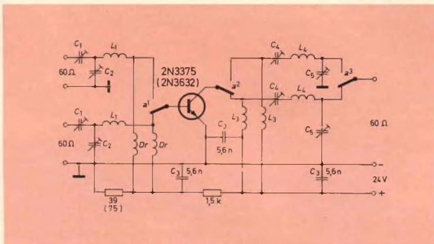
Fig. 4 - Esempio di circuito per la commutazione a relè della banda 2 ÷ 10 m.
