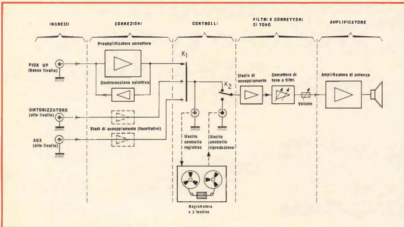
Fig. 2 - Schema a blocchi di un preamplificatore-correttore in cui si effettua una distinzione fra i livelli delle diverse sorgenti di modulazione.
