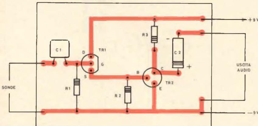
Fig. 8 - Disposizione dei componenti sul circuito stampato relativo allo schema elettrico di figura 1.
