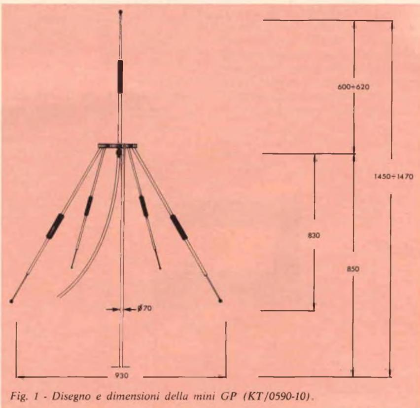
Fig. 1 - Disegno e dimensioni della mini GP (KT/0590-10).
