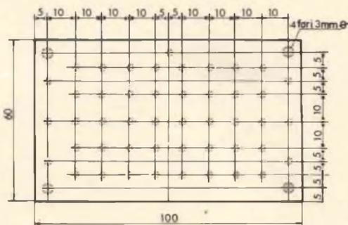
Fig. 7 - Supporto per le resistenze di carico. Tutti i fori sono da 1,5 mm di diametro.
