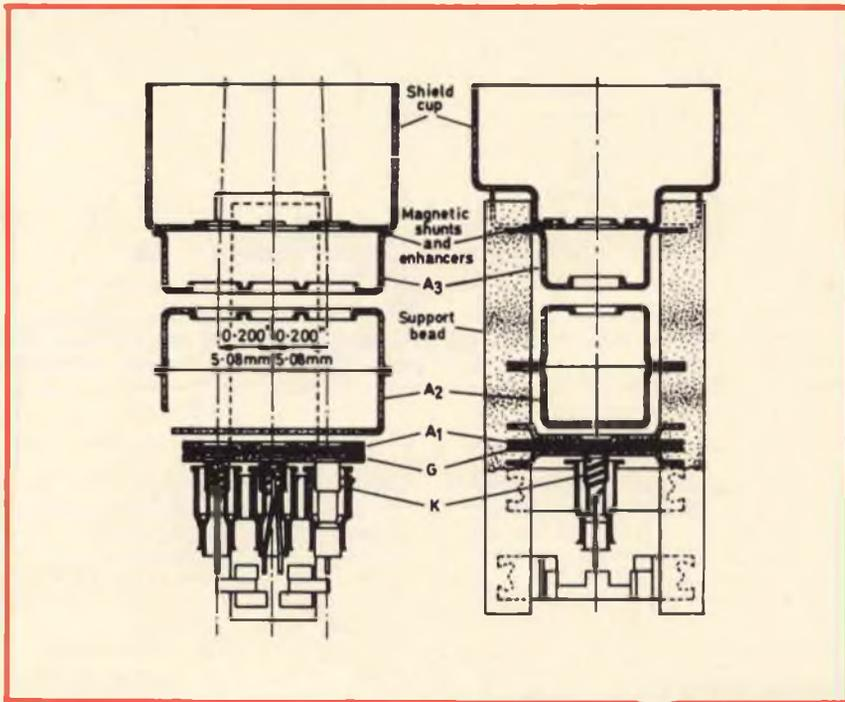
Fig. 7 - Struttura interna di un cannone di precisione del tipo in linea, rappresentato in sezione trasversale.
