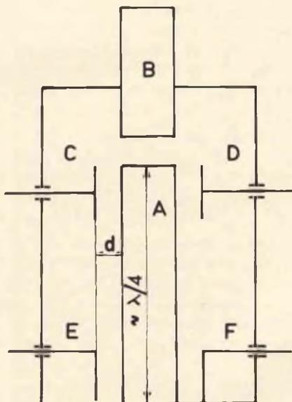
Fig. 1 - Filtro passa banda in cavità.
