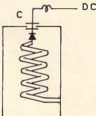
Fig. 7 - Altro sistema di sintonia del filtro che impiega un diodo varicap.
