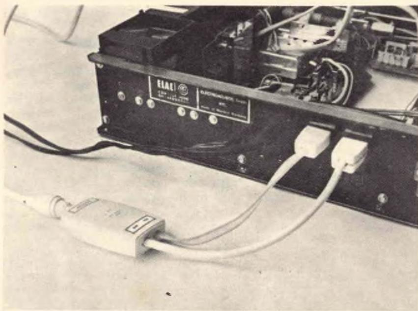
Fig. 2 - Uso di un demiscelatore-adattatore di impedenza necessario per separare i segnali a modulazione di ampiezza da quelli a modulazione di frequenza da una discesa comune. Le due uscite vanno collegate agli appositi ingressi del sintonizzatore.
