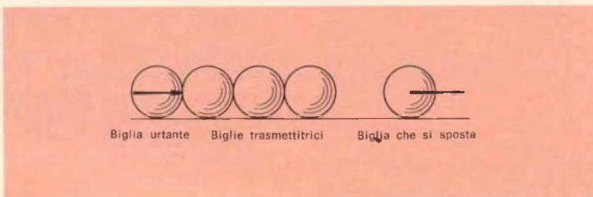
Fig. 1 - L'energia posseduta dalla biglia urtante viene trasmessa all'ultima biglia della fila senza che le altre si muovano.
