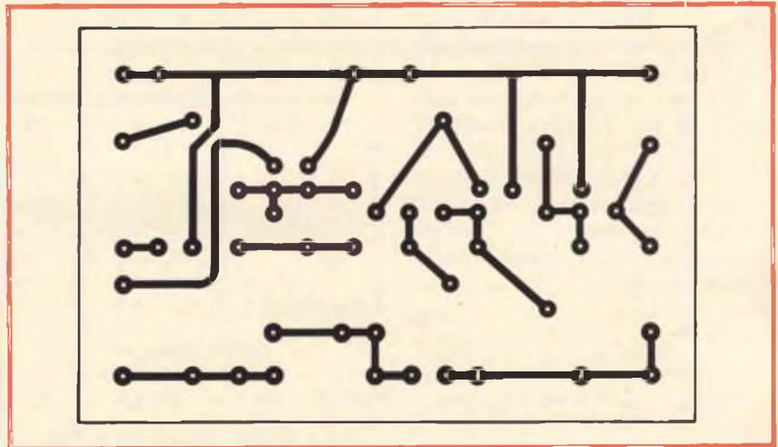
Fig. 3 - Circuito stampato del ricevitore reflex a tre transistori.
