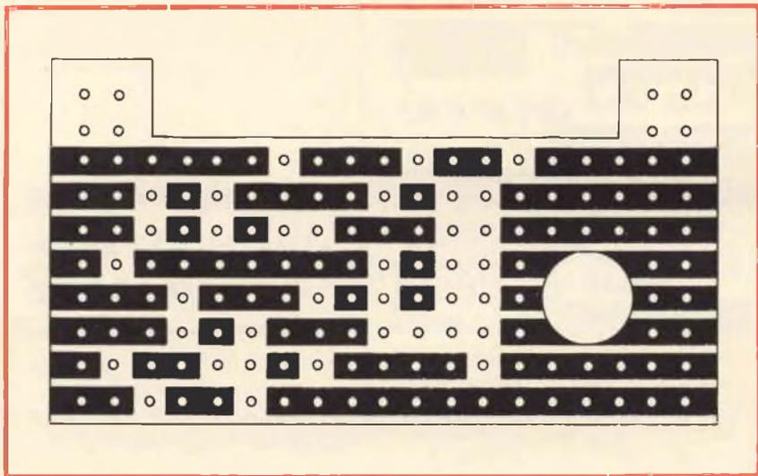
Fig. 2-B - Realizzazione della basetta di supporto mediante una piastrina «Veroboard», alla quale occorre conferire la forma perimetrica illustrata, eliminando alcuni tratti delle tracce di rame.
