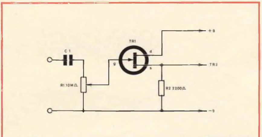
Fig. 2 - Circuito di controllo della sensibilità del «tracer».
