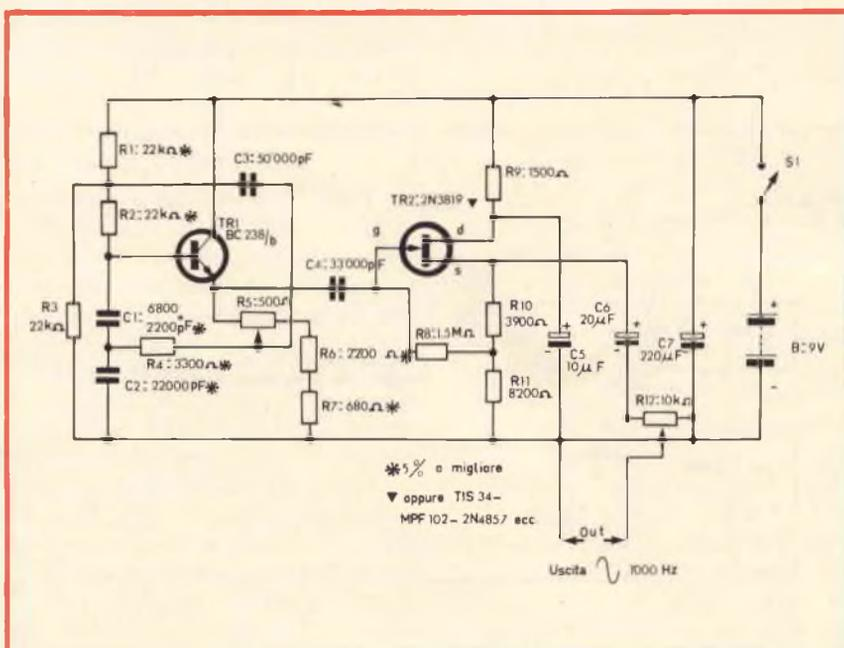
Fig. 6 - Schema elettrico del diapason elettronico.
