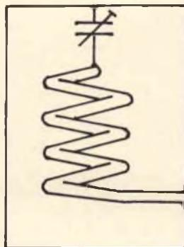
Fig. 6 - Sintonia del filtro ottenuta con un compensatore.
