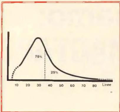
Fig. 3 - Questo grafico mostra il risultato di esperimenti condotti impiegando un buon RVM. Solo il 25% degli apparecchi TV impieganti un buon RVM necessita di regolazioni frequenti.
