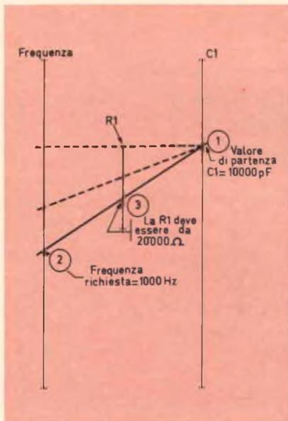
Fig. 2a - Esempio d'impiego del nomogramma.
