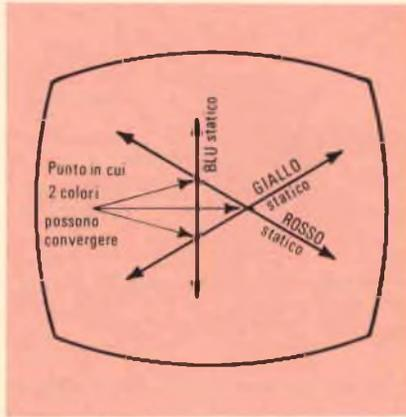
Fig. 2/a - Gli scorrimenti dei quadri rossi, verdi, e blu prodotti dai magneti di regolazione statica montati sul gruppo di regolazione principale.
