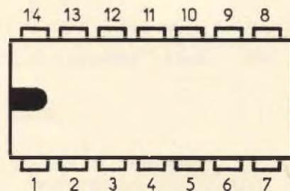
Fig. 2 - Numerazione dei piedini del circuito integrato.
