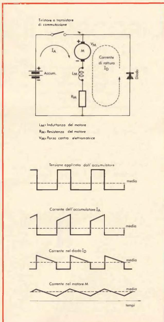
Fig. 1 - Principio di comando di velocità di un motore a corrente continua tramite la modulazione in ampiezza degli impulsi.
