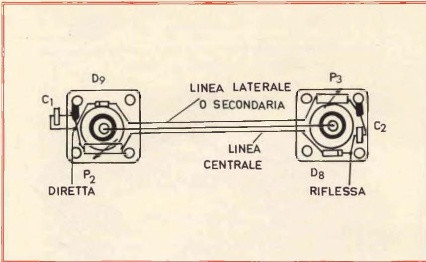
Fig. 15 - Montaggio pratico delle linee del rosmetro.
