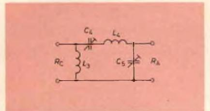
Fig. 2 - Schema del circuito d'ingresso.
