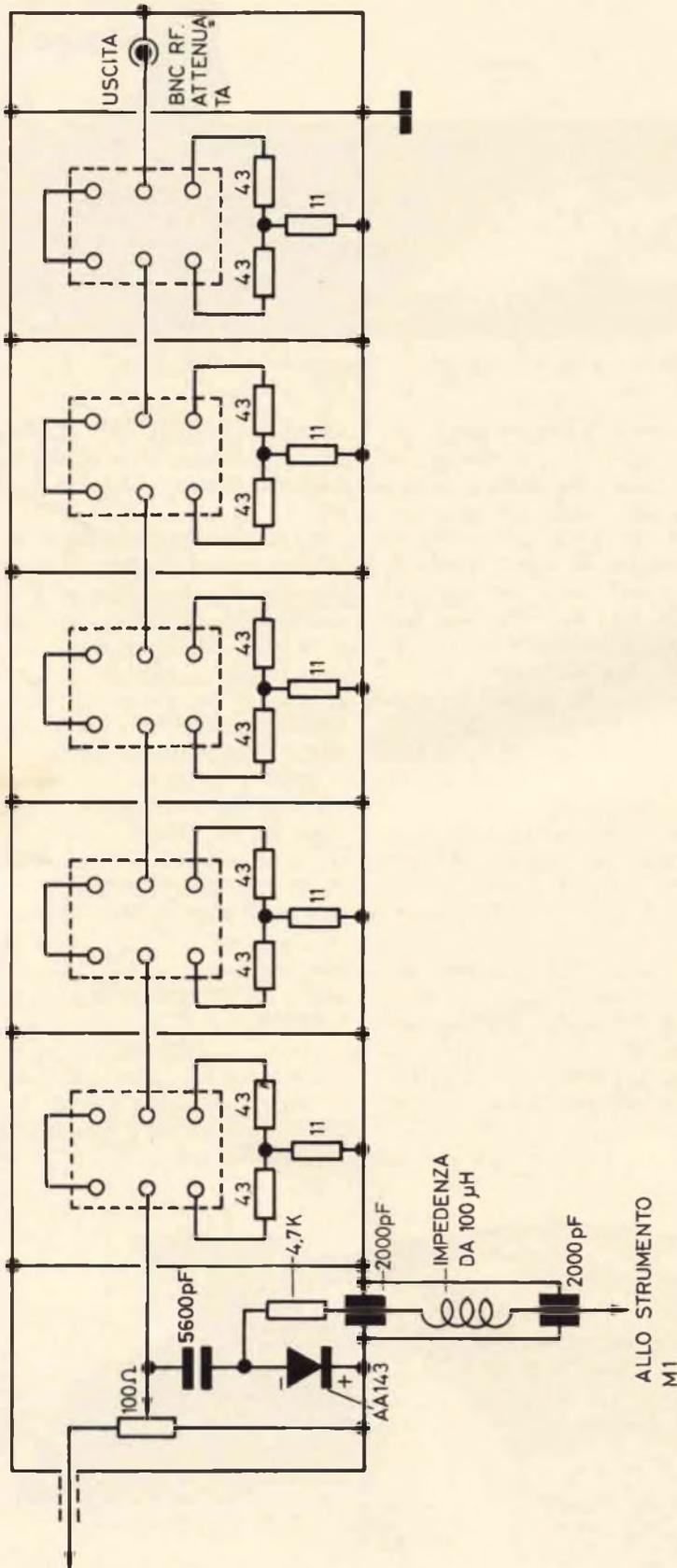
Fig. 11 - Schema elettrico dell'attenuatore a 5 passi da 20 dB l'uno con uscita a 50 Ω.
