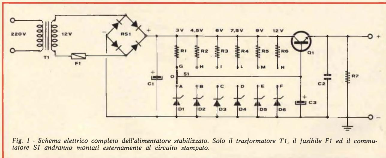
Fig. 1 - Schema elettrico completo dell'alimentatore stabilizzato. Solo il trasformatore T1, il fusibile F1 ed il commutatore S1 andranno montati esternamente al circuito stampato.
