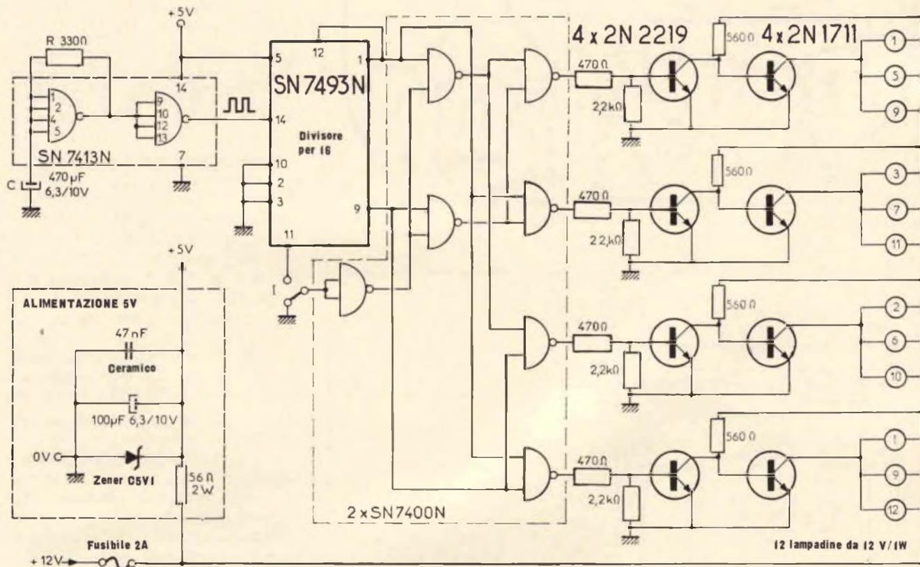
Fig. 7 - Schema elettrico del circuito lampeggiatore. I resistori sono da 1/4 W. Le lampadine sono da 12 V/1 W. Il fusibile è da 1,6 A ritardato. Il commutatore è di tipo unipolare.
