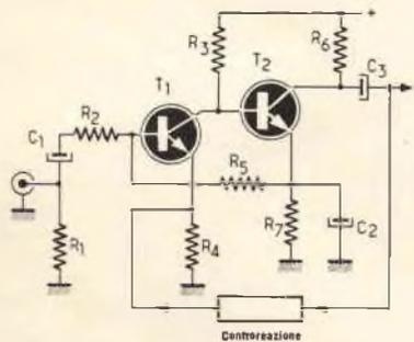
Fig. 3 - Schema di principio di uno stadio di preamplificazione impiegante due transistori N-P-N.
