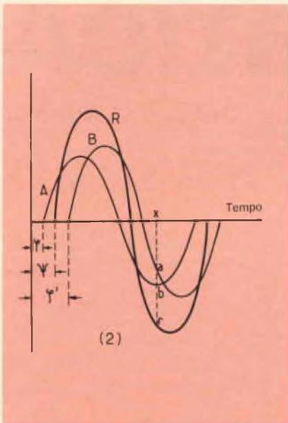
Fig. 4 - Composizione di due oscillazioni A e B della stessa frequenza ma con diversa fase.
