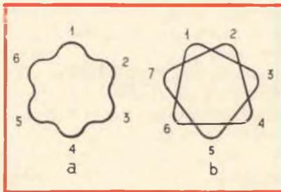
Fig. 6 - Tracce che si osservano sullo schermo di un oscilloscopio con base dei tempi circolare.
