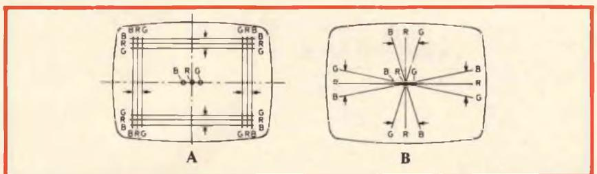
Fig. 6 - In «A» è illustrato l'effetto di convergenza (indicato dalle frecce) mano a mano che il giogo viene spostato orizzontalmente a sinistra a partire da una posizione errata di destra. In «B» è rappresentato l'effetto sulla convergenza, mano a mano che il giogo viene spostato verticalmente verso l'alto.
