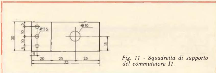
Fig. 11 - Squadretta di supporto del commutatore II.
