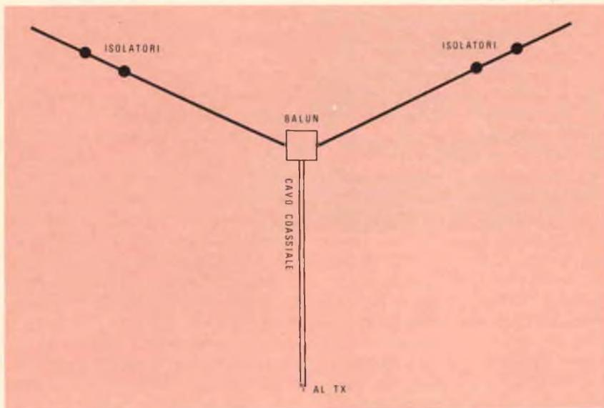
Fig. 2 - Il disegno mostra come in effetti l'antenna della fig. 1, montando il balun con cavo coassiale, assuma una forma diversa.
