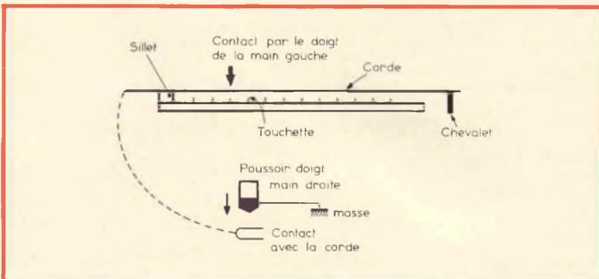
Fig. 9 - Metodo di determinazione della frequenza delle note esercitando la pressione su di una corda, in modo da stabilire il contatto elettrico con una barretta trasversale.
