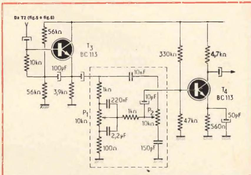
Fig. 7 - Circuito per il controllo dei toni bassi e dei toni acuti basato su circuiti passivi.
