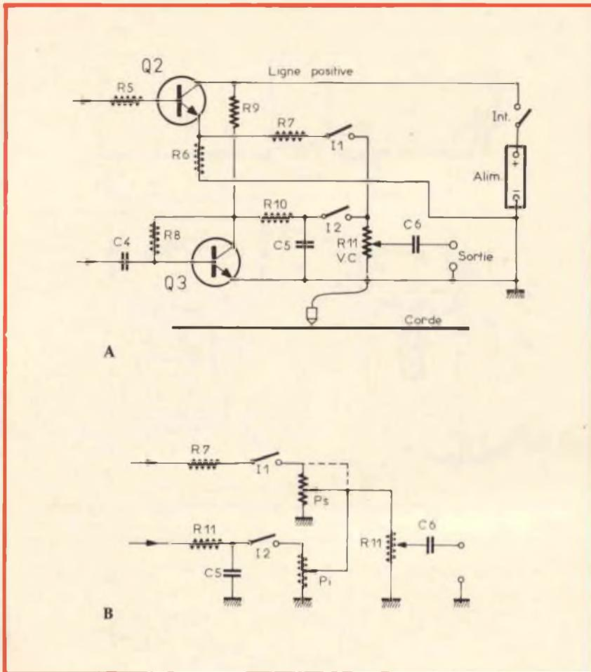
Fig. 12 - La sezione «A» di questa figura rappresenta lo schema elettrico dell'ingresso del dispositivo elettronico la cui frequenza di funzionamento viene controllata direttamente attraverso le corde dello strumento che viene reso elettronico con l'aggiunta del dispositivo descritto. In «B» è illustrato il metodo, basato sull'impiego di due potenziometri, mediante i quali è possibile attribuire a piacere la prevalenza in uscita di due diversi tipi di segnali.
