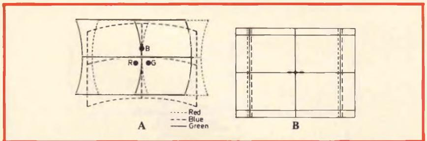
Fig. 4 - In «A» è illustrato l'andamento fondamentale dell'errore di convergenza di un cinescopio a maschera forata con cannone a «delta». In «B» è invece illustrato un esempio degli errori di convergenza che si riscontrano nel cinescopio Trinitron della Sony.
