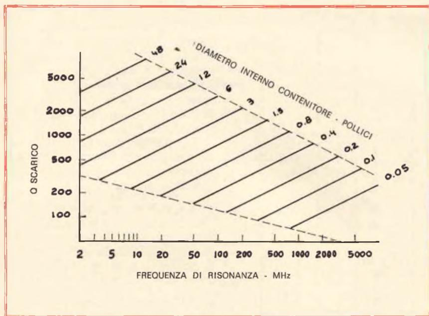
Fig. 3 - Q scarico dei risonatori ad elica ( $Q_u$ ).
