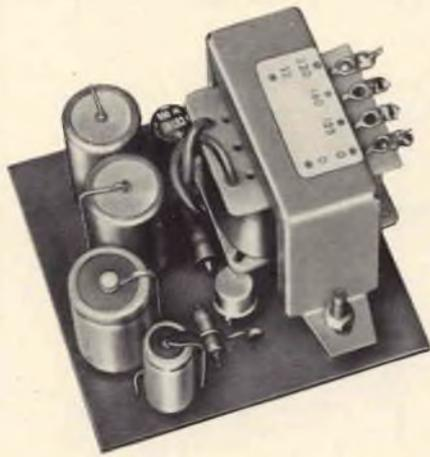
Fig. 4 - Prototipo dell'alimentatore montato su circuito stampato.
