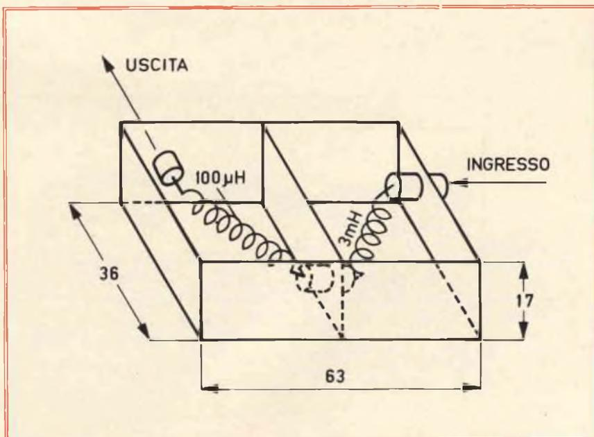
Fig. 6 - Custodia schermante del filtro sul + 10 V.
