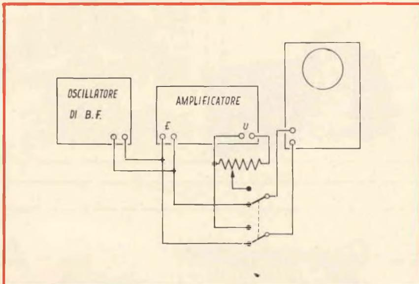
Fig. 8 - Collegamenti degli strumenti per eseguire il controllo della curva di risposta di un amplificatore.
