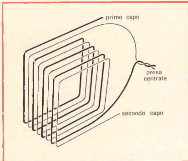
Fig. 3 - Metodo di allestimento di un avvolgimento con presa centrale, con la tecnica «bifilare». L'avvolgimento viene realizzato con un filo doppio, dopo di che la fine di uno degli avvolgimenti viene collegata all'inizio dell'altro. I due capi rimasti liberi costituiscono gli estremi dell'intero avvolgimento.
