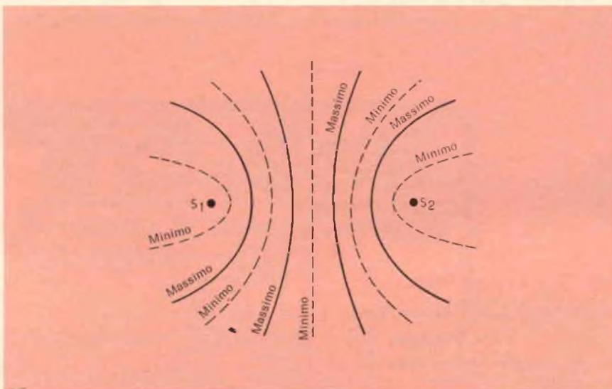
Fig. 5 - Frange di interferenza generata da due sorgenti identiche S1 ed S2.
