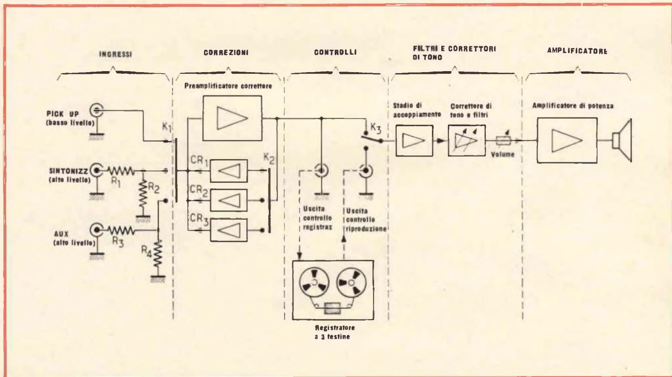
Fig. 1 - Schema a blocchi di un preamplificatore-correttore in cui tutti i segnali di modulazione passano per lo stadio di ingresso.
