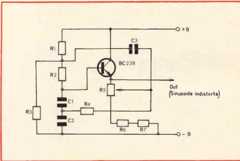
Fig. 5 - Schema elettrico di un altro oscillatore.
