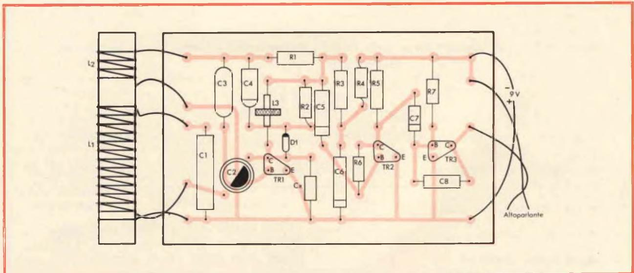
Fig. 4 - Montaggio dei componenti sul circuito stampato.
