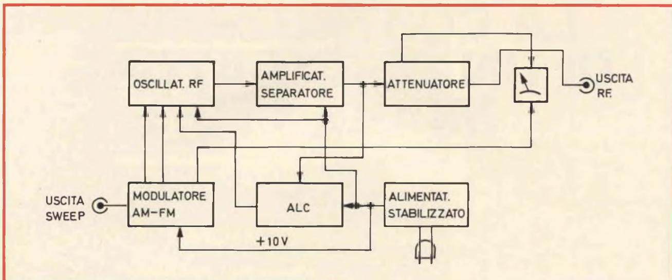
Fig. 1 - Schema a blocchi del generatore di segnali allo stato solido.
