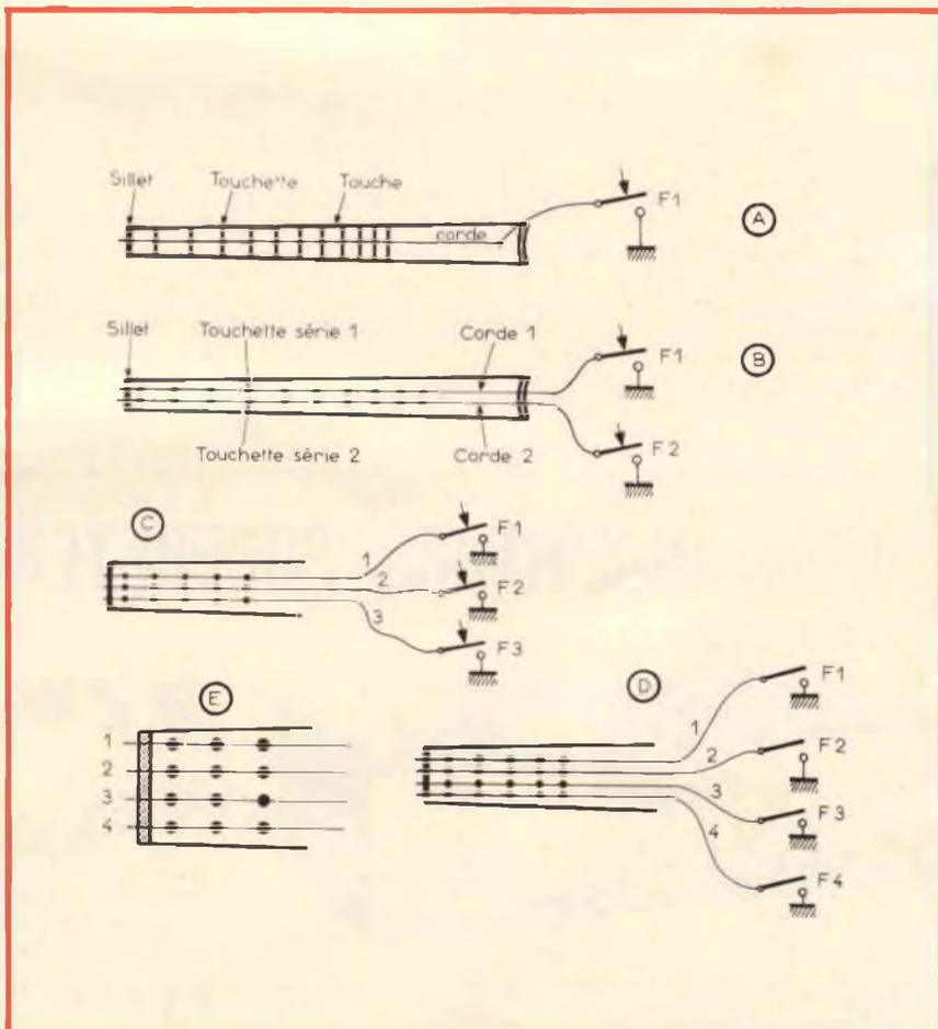
Fig. 11 - Cinque diversi metodi per ottenere la chiusura del circuito negli strumenti monocorda o a corde multiple a seconda delle caratteristiche del circuito di ingresso nel dispositivo elettronico che funge da generatore.
