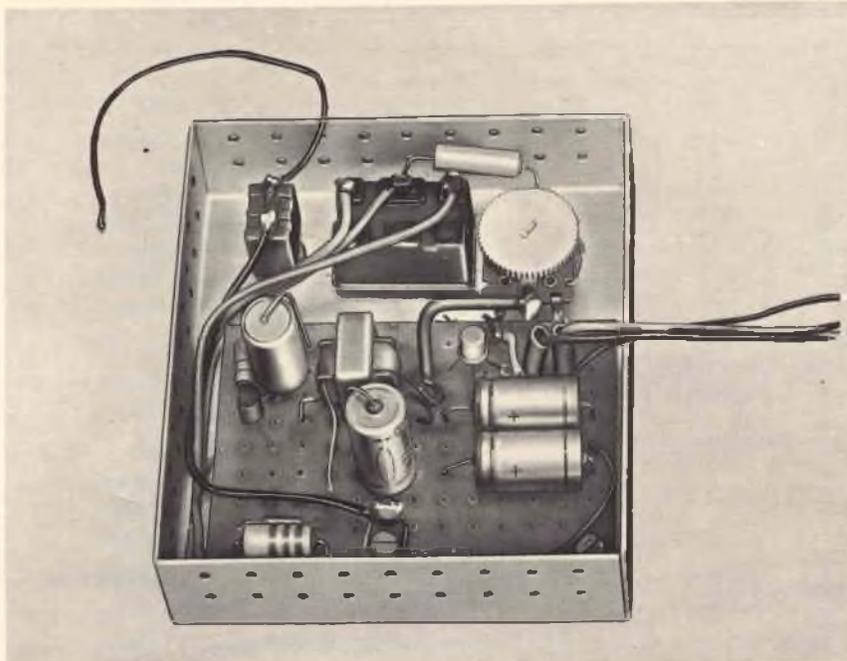
Fig. 10 - Vista interna del prototipo del «signal tracer» a realizzazione ultimata.
