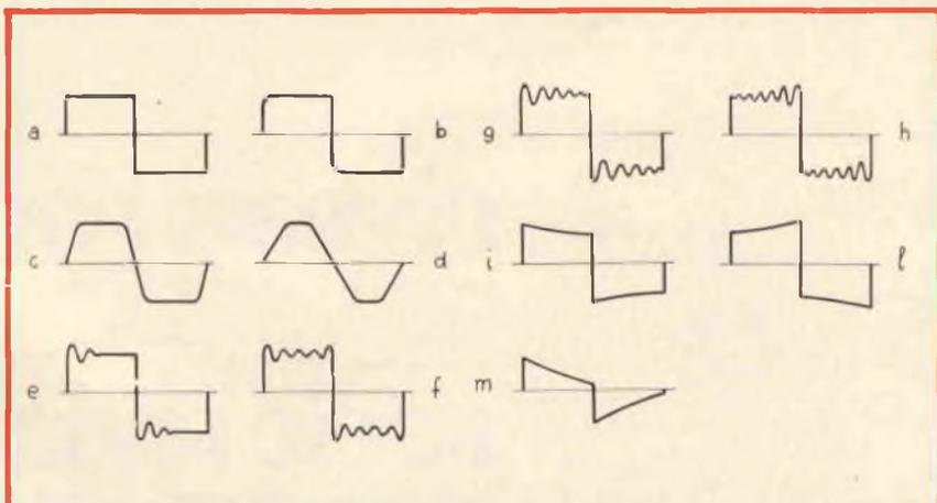
Fig. 10 - Oscillogrammi relativi alla curva di risposta di un amplificatore di bassa frequenza con il generatore di segnali ad onda quadra (vedere testo).
