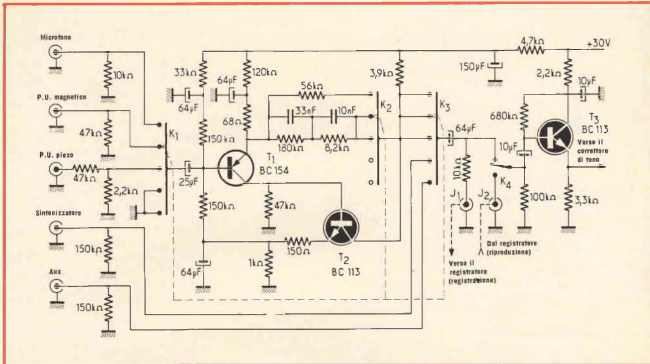
Fig. 5 - Esempio pratico di preamplificatore con stadio P-N-P/N-P-N. L'ampiezza dei segnali delle diverse sorgenti di modulazione viene dosata per mezzo di attenuatori potenziometrici selezionati con il commutatore  $K_1$ .
