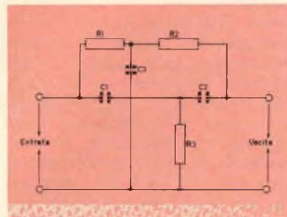
Fig. 1 - Schema classico di un filtro a «Doppio T». Rapporti per il normale funzionamento: R1 = valore uguale a R2. C1 = valore uguale a C2. C3 = valore doppio rispetto a C1 o C2. R3 = un decimo di R1 o R2.
