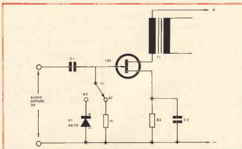
Fig. 7 - Variante al circuito di figura 6 che esclude l'impiego delle sonde RF.
