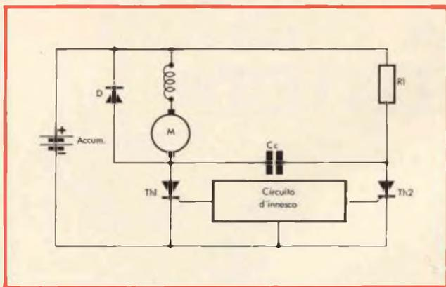
Fig. 2 - Comando di velocità per mezzo di un carico resistivo.
