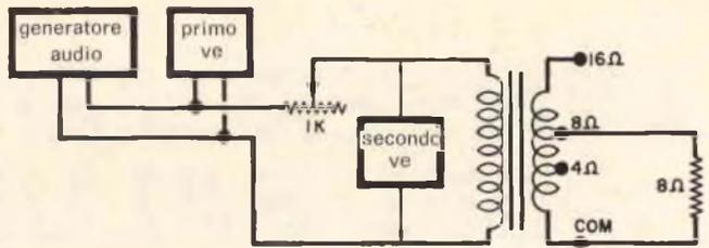
*Fig. 5 - Disposizione degli strumenti di misura (ve) per effettuare il collaudo di un trasformatore a realizzazione ultimata. Durante la prova descritta, al secondario deve essere applicato un carico di valore adatto.*
