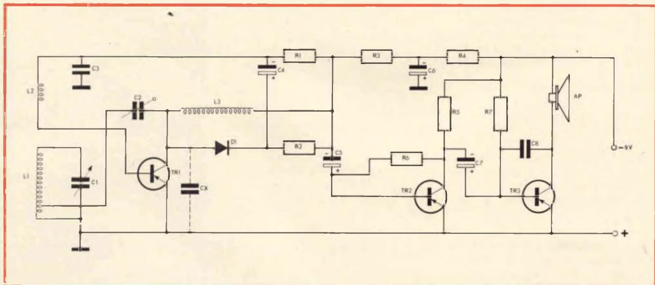
Fig. 1 - Schema elettrico del ricevitore reflex a tre transistori.
