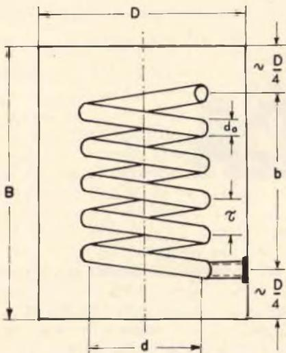
Fig. 2 - Aspetto tipico di un risonatore ad elica in versione semplificata.
