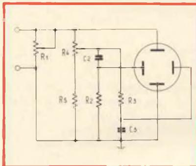
Fig. 5 - Schema di principio del circuito relativo ad una base dei tempi circolare.
