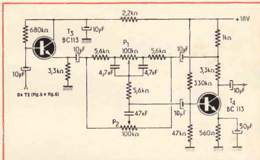
Fig. 8 - Circuito per il controllo dei toni bassi e dei toni acuti, di tipo Baxandall, impiegante una rete di controreazione.
