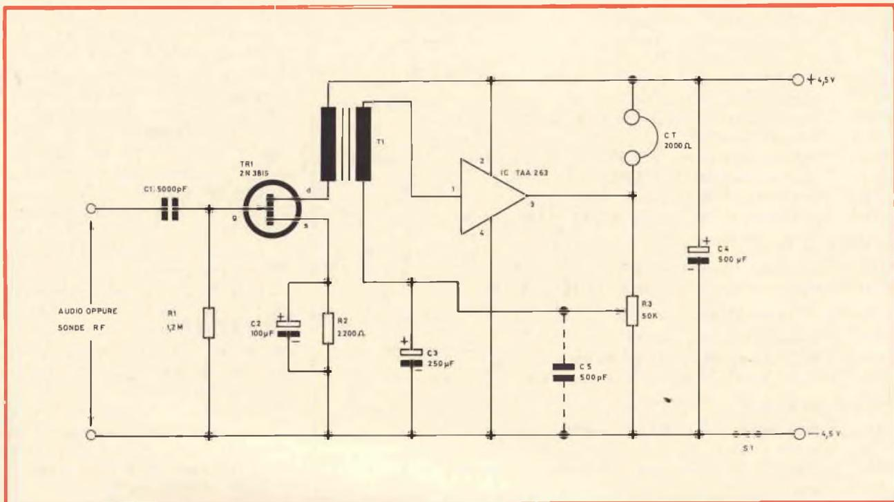
Fig. 6 - Schema elettrico di un «tracer» più sensibile che impiega il circuito integrato TAA263.
