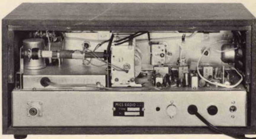
Fig. 5 - Vista del retro dello chassis. Sono ben visibili i componenti principali ed i due condensatori variabili che permettono la sintonia fondamentale ed il «verniero» per la sintonia sulla banda degli «OM».
