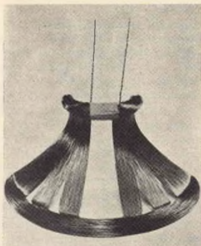
Fig. 5 - Bobina concava avvolta a singole sezioni.
