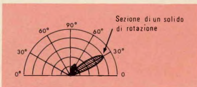
Fig. 5 - Angolo di radiazione verticale di un'antenna.
