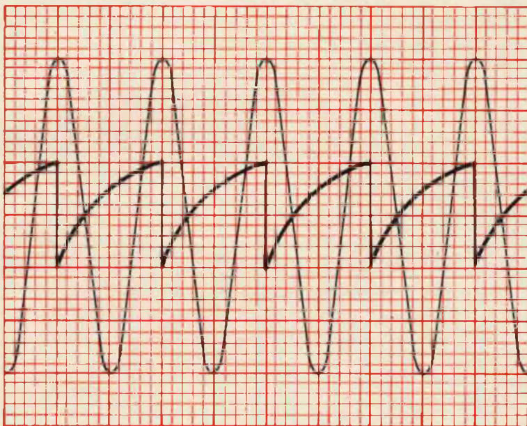
Fig. 16 - Oscillogramma rilevato con oscilloscopio a doppia traccia D 66 della Telequipment. Si notino la forma d'onda tipica a dente di sega, ad andamento esponenziale, del segnale di livello minore (4 V circa p. a p.) e la sinusoide perfetta del segnale di uscita (12 V circa p. a p.)
