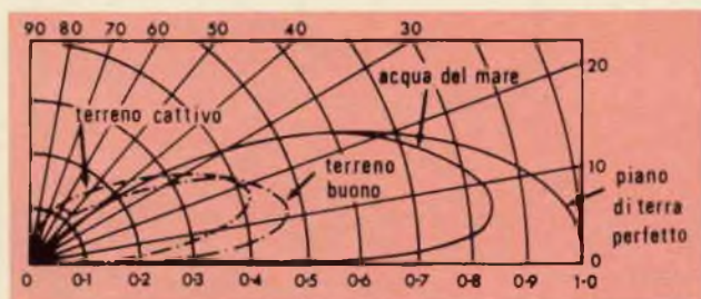
Fig. 13 - Andamento del lobo d'irradiazione verticale in funzione del tipo di terreno sottostante.
