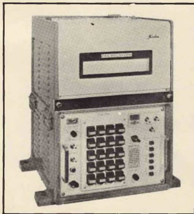
Fig. 1 - Apparecchio per la ricezione in fac-simile dei dati meteorologici della KODEN Electronics (APEL - MAR di Genova).
