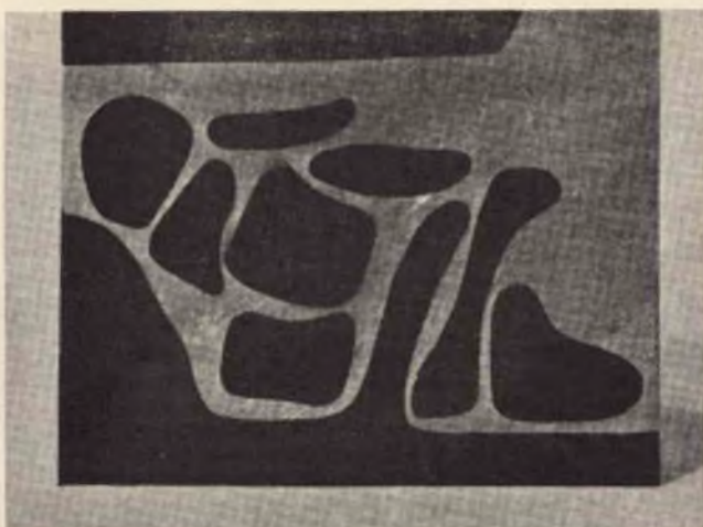
Fig. 18 - Quattro fasi del processo di incisione: in «A» riproduzione mediante carta carbone del disegno che identifica la struttura delle varie connessioni. In «B» le zone in rame sono state rivestite col materiale «resist» e la basetta è pronta per il bagno di incisione. In «C» è riprodotto l'aspetto della basetta dopo l'asportazione del rame mediante l'acido, ed in «D» è illustrata la basetta dal lato rame, dopo l'applicazione dei componenti e la relativa saldatura.
