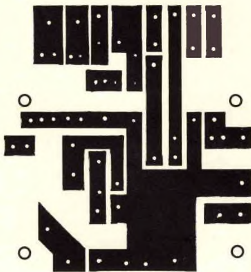
Fig. 3 - Disegno a grandezza naturale delle connessioni in rame presenti sulla basetta a circuiti stampati, dal lato opposto a quello sul quale vengono fissati i componenti.
