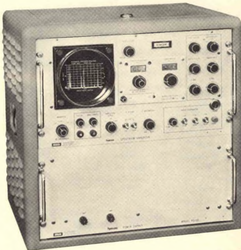
Fig. 4 - Analizzatore di spettro da 200 Hz a 25 MHz della Singer Company (Sil-verstar) con larghezza di banda regolabile da 20 Hz a 200 kHz.
