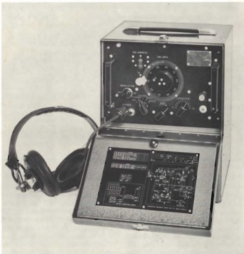
Fig. 1 - Questo è il complemento (fino ai 280 MHz) del famoso BC 221 già da noi descritto, nel numero 6/1971 pagina 929, che arrivava a coprire la banda dai 0,150 ai 20 MHz.
