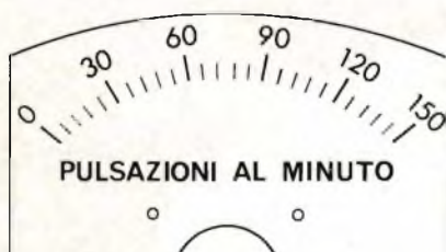
Fig. 3 - Esempio di scala da sostituire al microamperometro.
