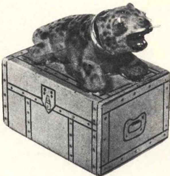
Fig. 3 - Esempio di animale finto nel quale gli occhi sono stati sostituiti dalle due lampade al neon. In questo caso, il bauletto che funge da base di supporto contiene anche una grossa batteria di alimentazione, nonché la morsettiera recante i condensatori ed i resistori attraverso i quali si ottiene l'effetto di lampeggio.
