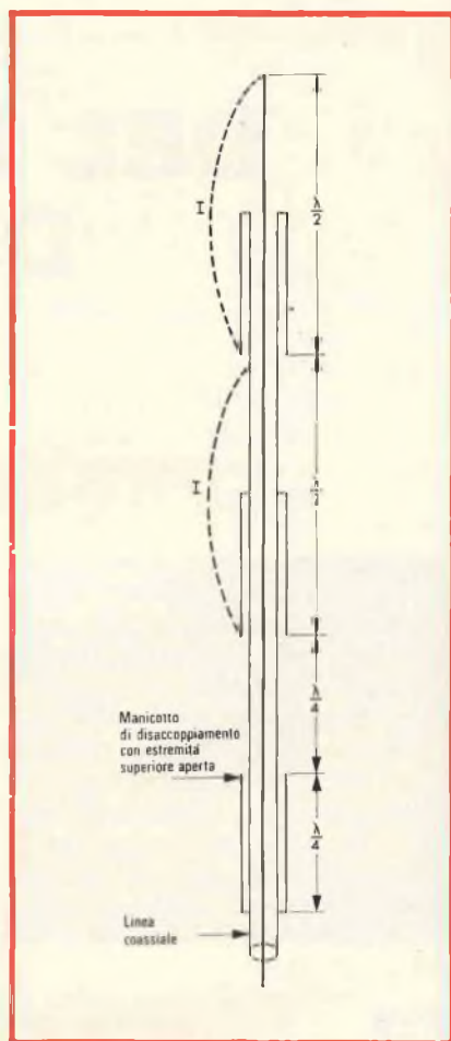
Fig. 5 - Altro esempio di antenna verticale realizzata impiegando un tratto di linea coassiale rigida come elemento, nel quale i manicotti per l'inversione di fase fanno capo al conduttore esterno.
