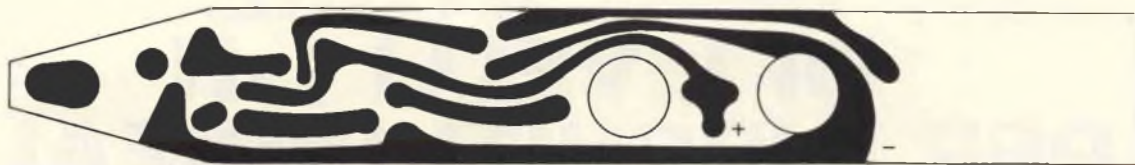
Fig. 3 - Circuito stampato dell'indicatore L-H, visto dal lato rame, secondo lo schema di figura 1.
