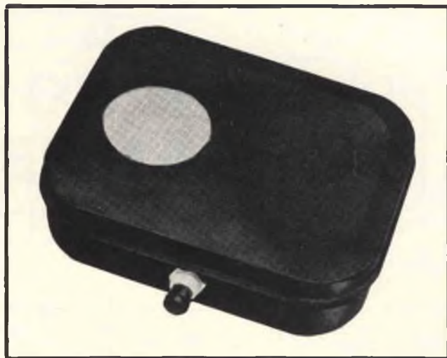
Fig. 6 - Per completare il dispositivo viene infine fissato il coperchio munito di un foro per il passaggio della luce proveniente dall'obiettivo. A questo foro è utile applicare uno schermo diffusore in vetro smerigliato od in plastica semio-paca.
