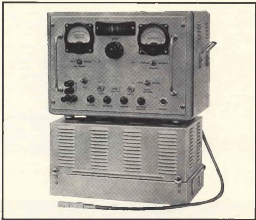
Fig. 5 - Complesso sovietico per misure di campo em esterne, per stazioni mobili.
