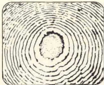
Fig. 9 - Esempio di immagine ottenuta, con il metodo interferenziale, durante il controllo di una puntina avente una superficie perfettamente sferica.
