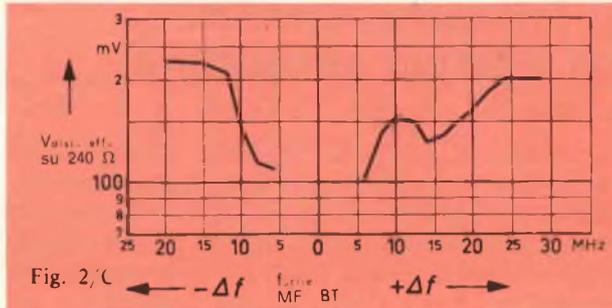
Come previsto è migliorato pure il campo di modulazione con minori scostamenti di linearità della curva caratteristica e la stabilità in frequenza dello oscillatore con più elevate tensioni utili di ingresso.
