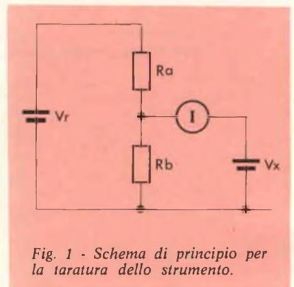
Fig. 1 - Schema di principio per la taratura dello strumento.
