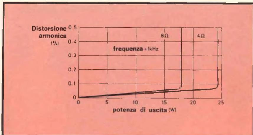
Fig. 7 - Variazione della distorsione armonica in funzione della potenza di uscita, calcolata con un carico di 4 e 8 Ω.
