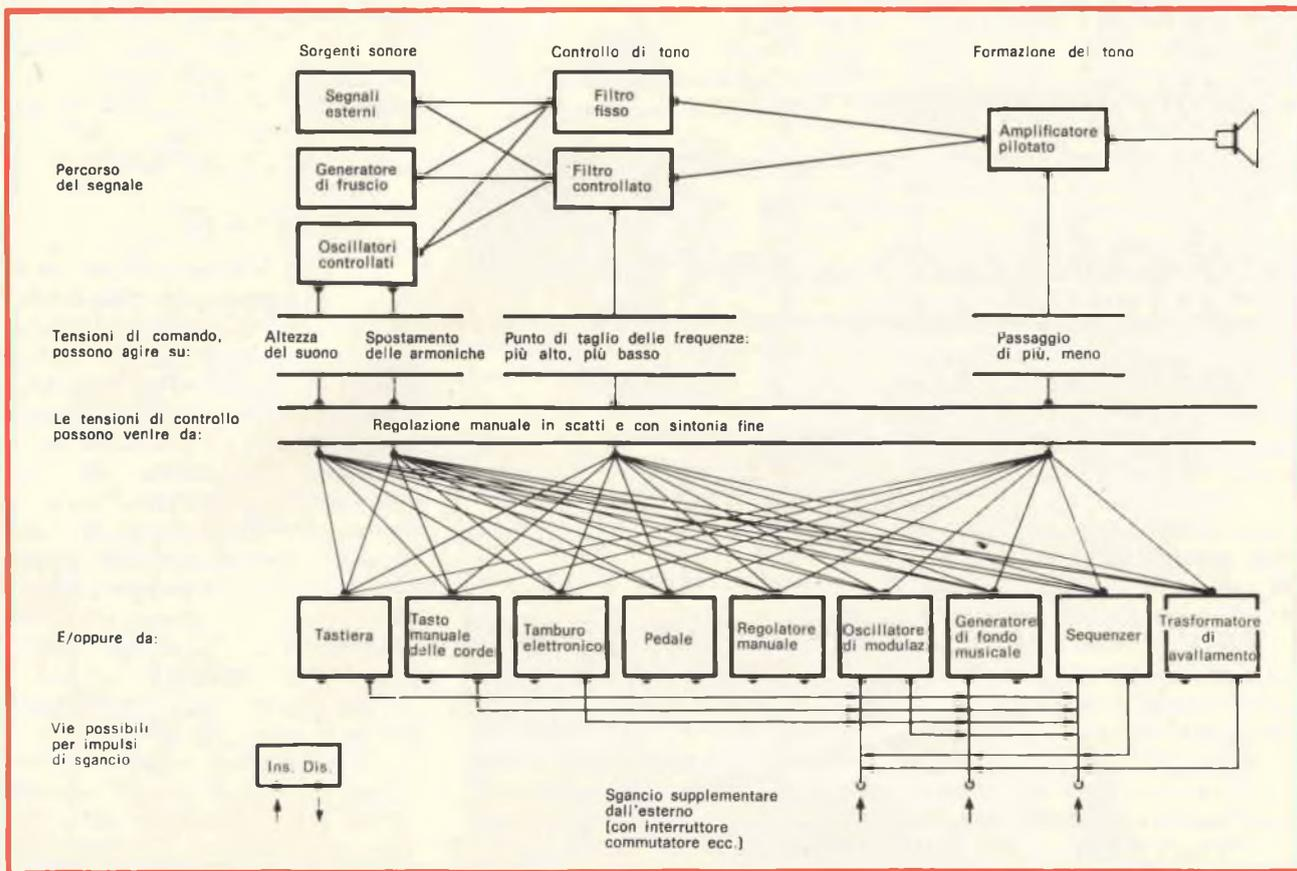
Fig. 2 - Schema di base di un sintetizzatore Moog.
