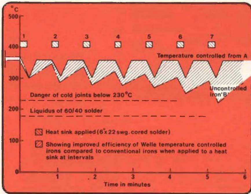
Fig. 2 - Rappresentazione grafica della variazione del tempo di recupero derivante da carichi termali ripetuti di dieci secondi, seguiti da intervalli di trenta secondi ciascuno.
