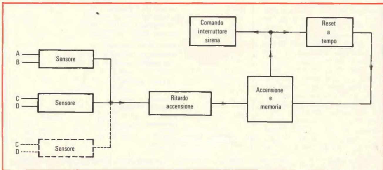
Fig. 5 - Schema a blocchi del centralino d'allarme.
