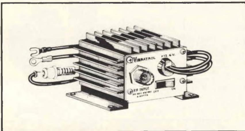
Fig. 5 - Amplificatore lineare per CB VIBRATOR modello RFL300A (GBC Italiana sigla ZR/7935-27) gamma 26800 ÷ 27600 kHz per AM, FM, SSB, DSB. Potenza di ingresso minima 3 W, massima 5 W, uscita 35 W. Alimentazione a 12 Vc.c.
