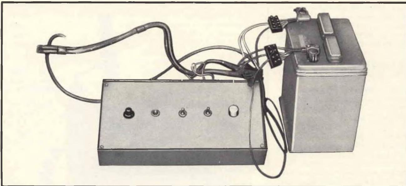
Fig. 9 - Prototipo dell'antifurto collegato alla batteria di accumulatori per l'alimentazione.
