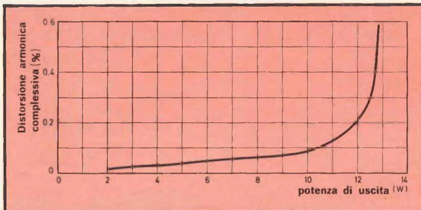
Fig. 5 - Curva di variazione della distorsione armonica totale in funzione della potenza d'uscita.
