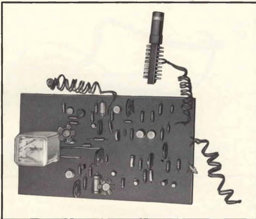
Fig. 8 - Vista della bassetta montata del centralino d'allarme.
