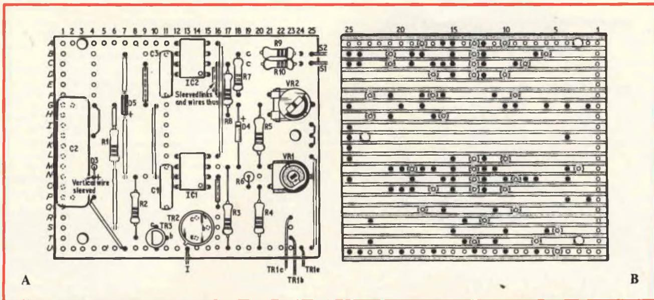
Fig. 13 - Disposizione dei componenti sulla basetta di supporto (A), e connessioni in rame a strisce presenti sul lato opposto della basetta (B).
