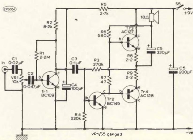
Fig. 9B - Circuito dell'amplificatore di bassa frequenza, che completa lo strumento con la presenza di un cercasegnali, munito di altoparlante incorporato.
