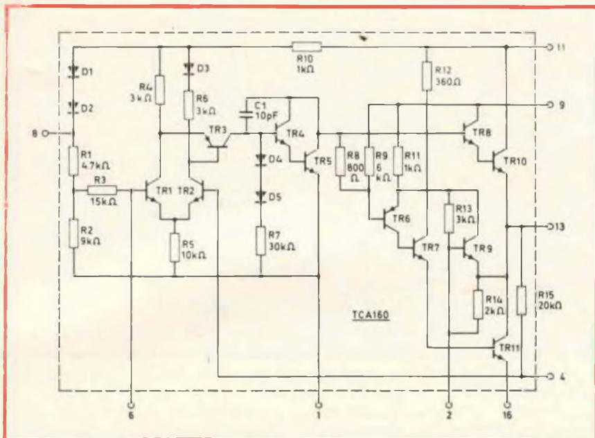
Fig. 1 - Struttura interna del circuito integrato TCA160.
