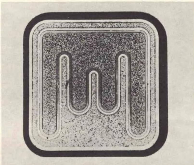
Sono stati recentemente introdotti sul mercato i transistori di potenza al silicio con base « epitassiale ». Secondo questa nuova tecnica, la base sulla quale verrà poi diffuso, in una fase successiva l'emettitore viene fatta crescere sul substrato (collettore) impiegando il processo epitassiale. Questo processo può essere facilmente tenuto sotto controllo e può essere usato per la
