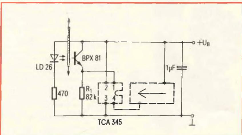
Fig. 11 - Esempio pratico di impiego di un circuito integrato Siemens TCA345 come interruttore di soglia per comandare l'esposizione degli apparecchi fotografici.
