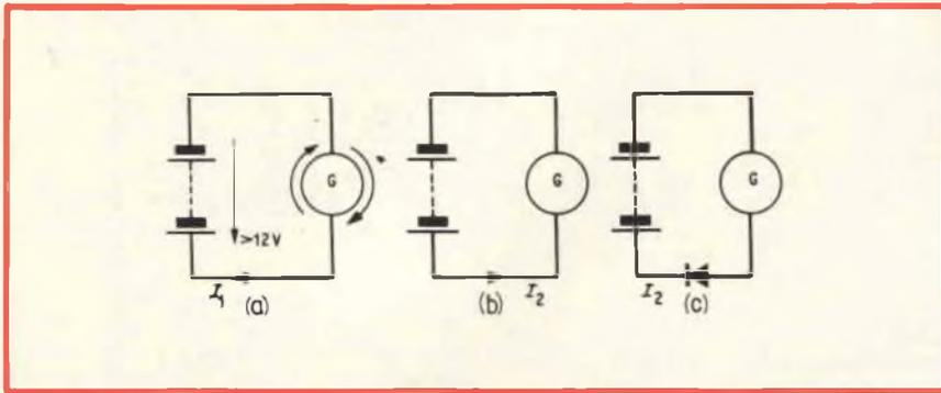
Fig. 10 - Tre casi tipici di funzionamento di un impianto automatico di ricarica della batteria di un'automobile: in (a) il generatore fornisce una tensione maggiore di 12 V di ricarica; in (b) se il generatore è fermo, si ottiene il passaggio di una corrente di scarica  $I_2$  attraverso il suo avvolgimento. Inserendo un diodo, come risulta evidente in (c), si impedisce il passaggio della suddetta corrente di scarica.
