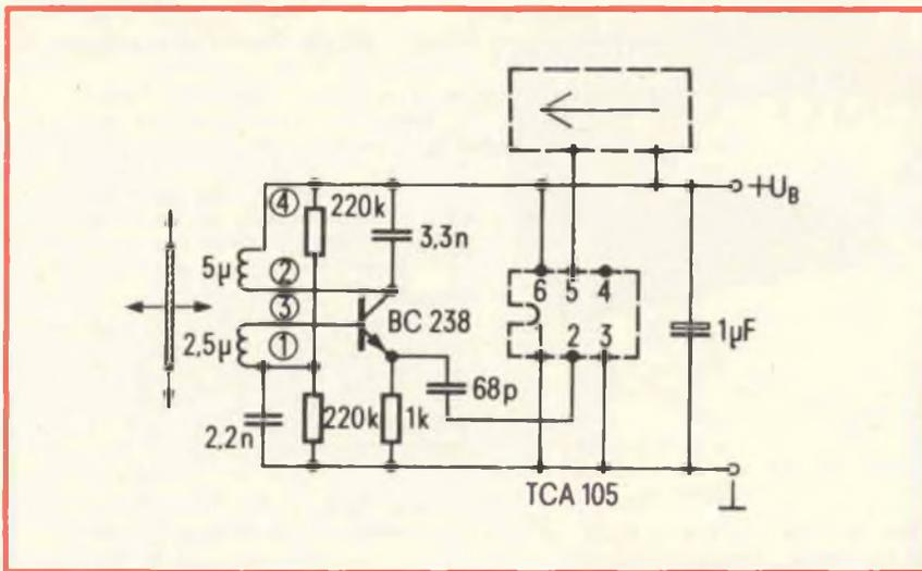
Fig. 9 - Esempio di impiego del circuito integrato Siemens TCA105 quale interruttore di prossimità per il conteggio di oggetti metallici.
