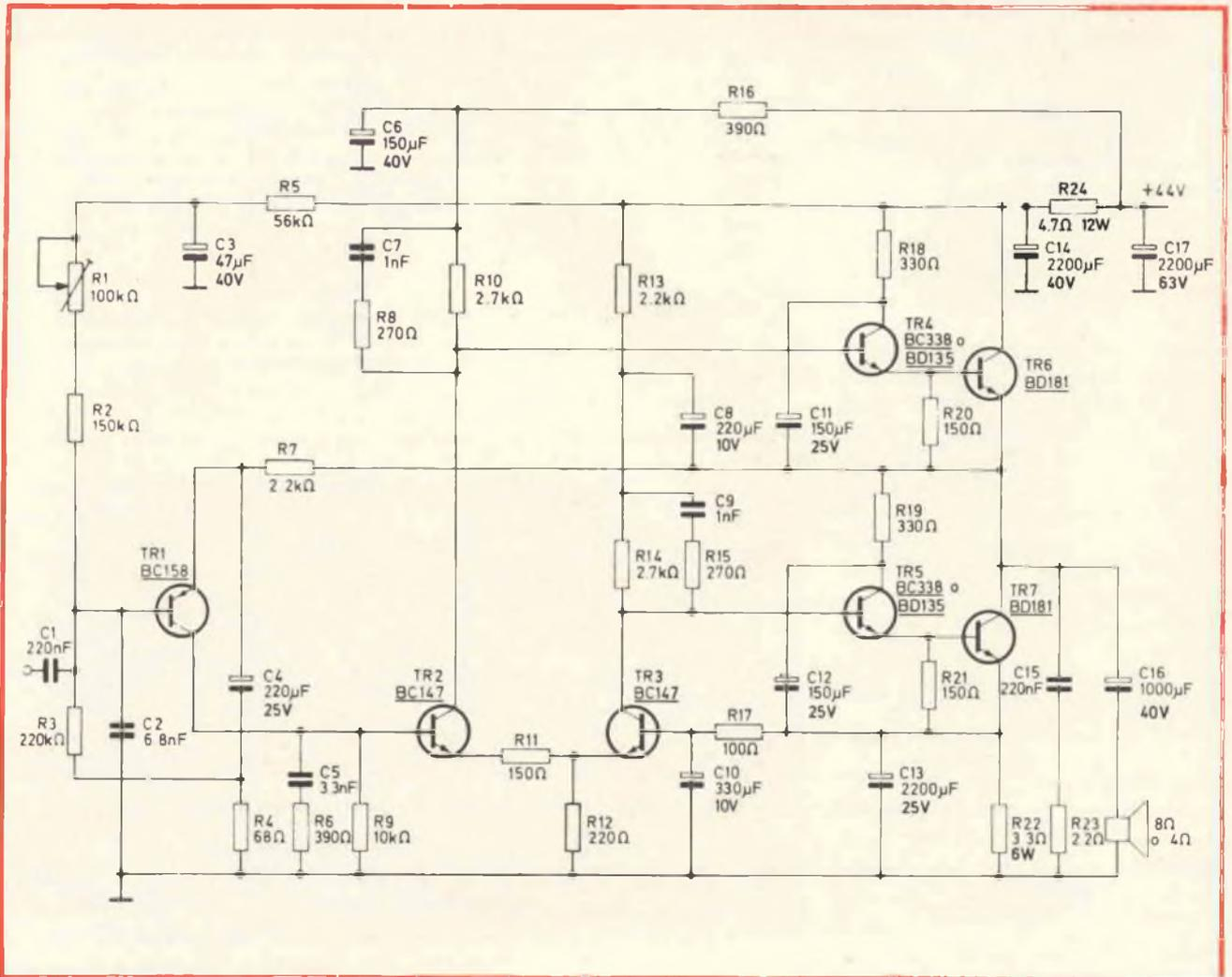
Fig. 6 - Schema elettrico dell'amplificatore da 15/20 W di potenza. L'ingresso è sul condensatore C1. Il valore di C2 dipende dall'impedenza della sorgente del preamplificatore.
