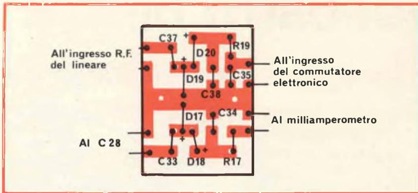
Fig. 2 - Disposizione dei componenti sul circuito stampato dei rivelatori di RF.
