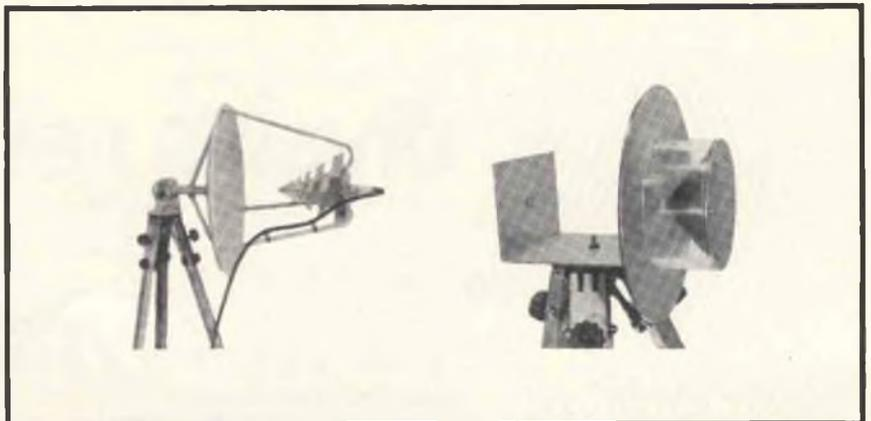
Fig. 5 - Antenne per misura campo funzionanti nella gamma EHF da 1 a 10 GHz.
