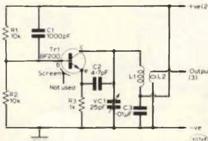
Fig. 6 - Circuito dell'oscillatore funzionante in VHF, sintonizzabile su tutte le frequenze comprese tra 75 e 150 MHz.
