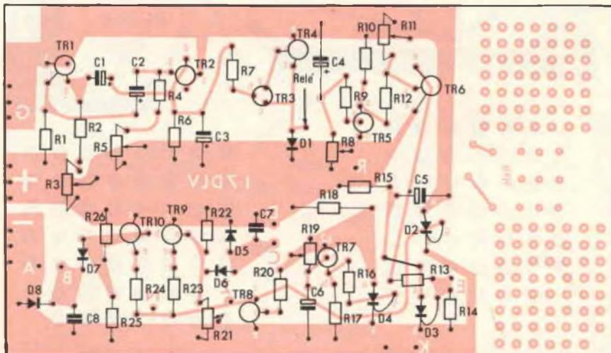
Fig. 7 - Disposizione dei componenti sul circuito stampato.
