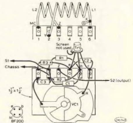
Fig. 7 - Tecnica costruttiva dell'oscillatore in VHF, montato direttamente sul retro del pannello frontale, mediante un supporto che sostiene anche il condensatore di sintonia.
