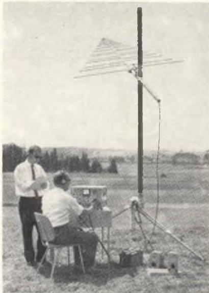
Fig. 6 - Misure di campo all'aperto su frequenze VHF-UHF mediante antenna log-periodica serie BN e misura-campo della Rohde & Schwarz.
