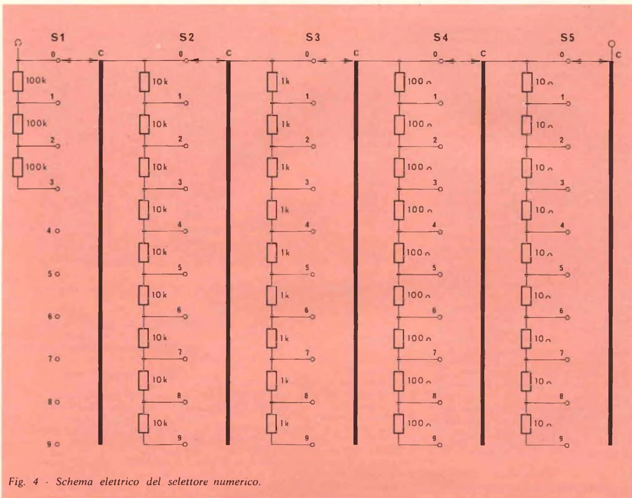
Fig. 4 - Schema elettrico del selettore numerico.
