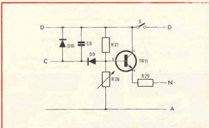
Fig. 2 - Schema elettrico del circuito aggiuntivo per le fotocellule.
