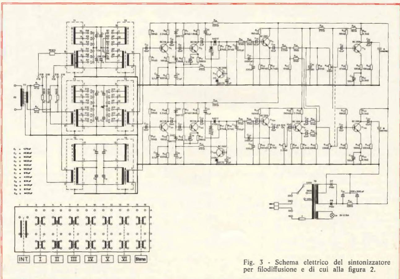
Fig. 3 - Schema elettrico del sintonizzatore per filodiffusione e di cui alla figura 2.
