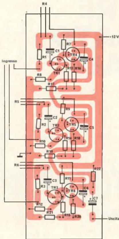
Fig. 2 - Disposizione dei componenti sul circuito stampato.
