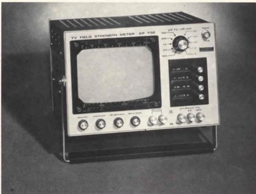
Fig. 2 - Tipico misuratore di campo con indicatore a tubo RC per installatori TV, modello EP 732 della UNAOHM. Gamme coperte  $48 \div 83$  MHz,  $175 \div 225$  MHz,  $470 \div 810$  MHz.
