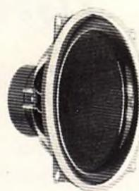
Altoparlante con sospensione pneumatica molto larga che permette un'ampia escursione del cono alle frequenze basse.
