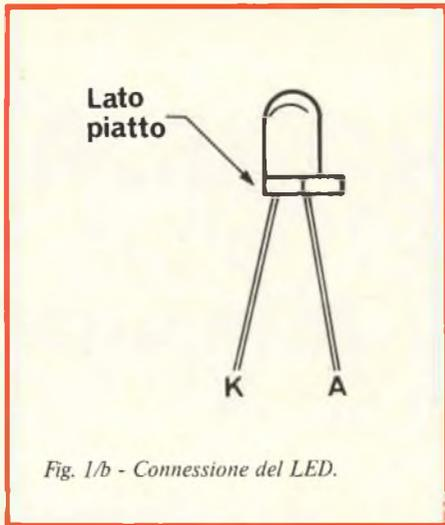
Fig. 1/b - Connessione del LED.
