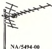
Antenna UHF a larga banda mod. 1605 Riflettore: a lambda Elementi: 17 Rapporto av./ind.: 23 dB Carico del vento: 2,5 Kp
