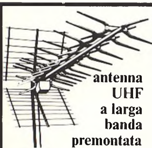
Riflettore: a lambda Elementi: 43 Canali: 21-65 Guadagno: 15 dB Rapporto av./ind.: 29 dB Angolo di apertura: H 28° Carico del vento: 8,2 Kp Impedenza: 60-240 ohm NA/4737-10 mod. 1676
