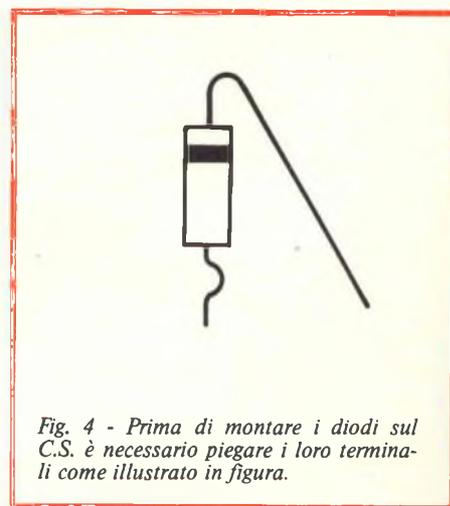
Fig. 4 - Prima di montare i diodi sul C.S. è necessario piegare i loro terminali come illustrato in figura.
