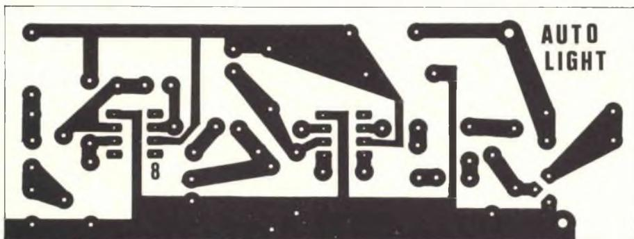
Fig. 10 - Bassetta a circuito stampato dell'autolight in scala 1:1.
