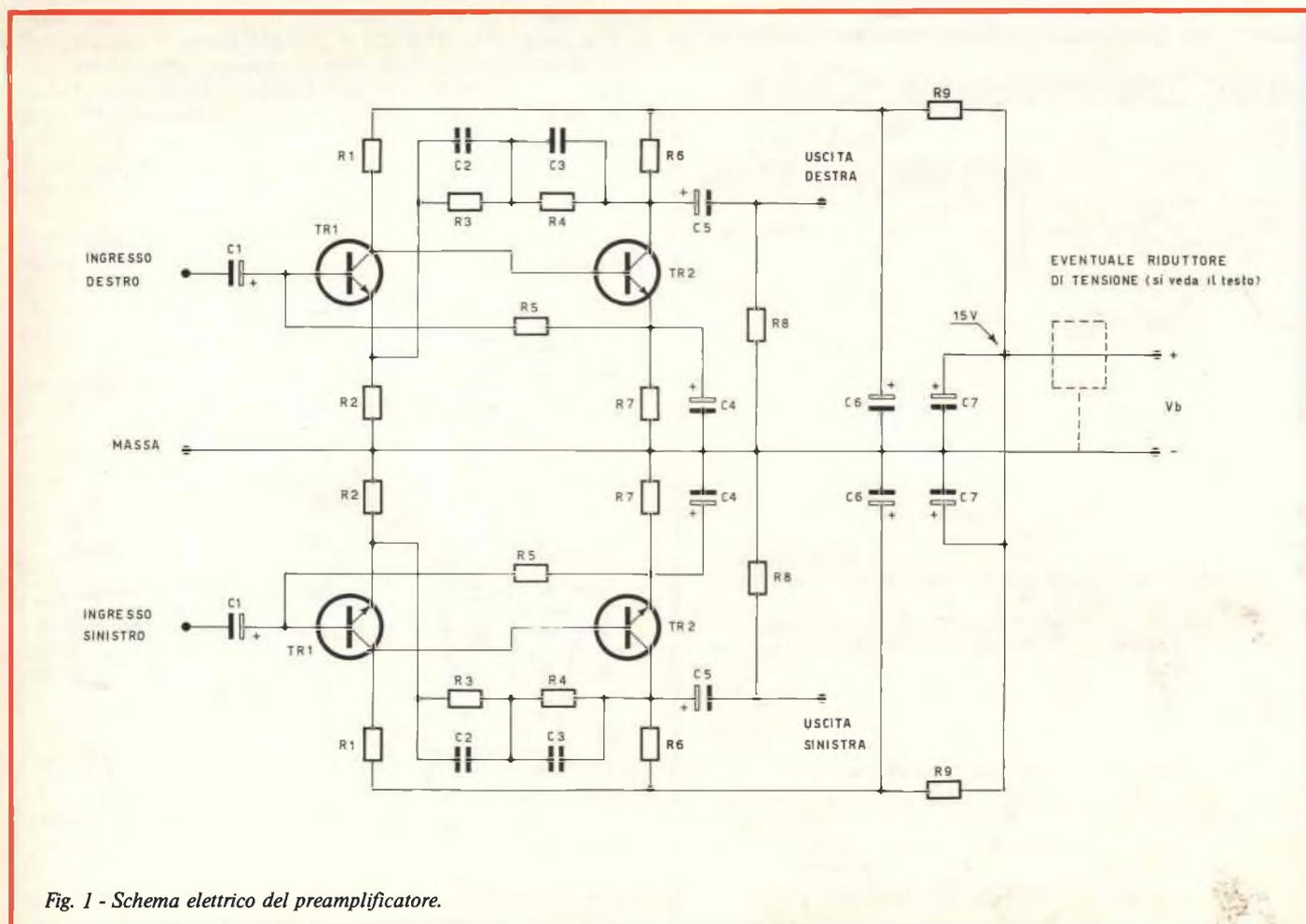
Fig. 1 - Schema elettrico del preamplificatore.
