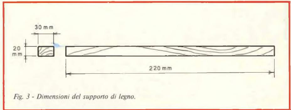
Fig. 3 - Dimensioni del supporto di legno.
