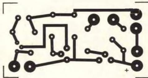
Fig. 2 - Disegno della basetta stampata in grandezza naturale.
