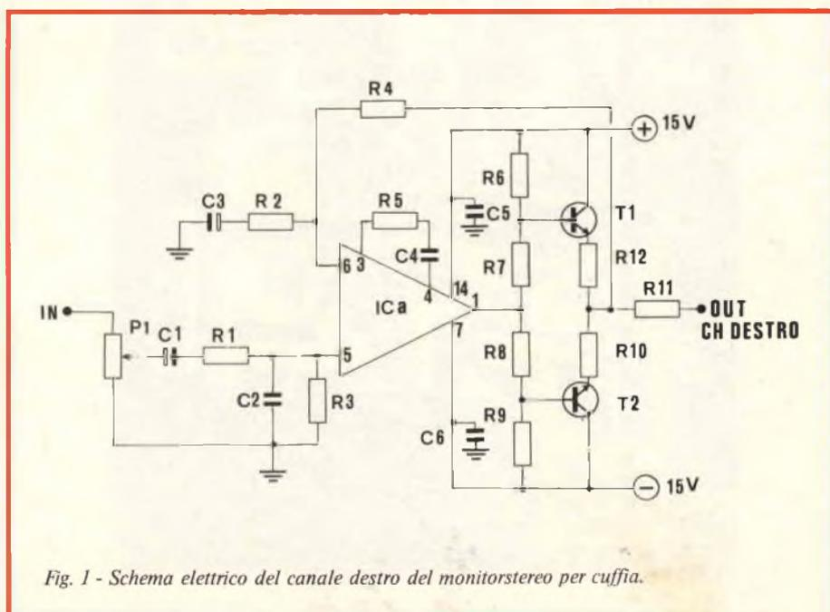
Fig. 1 - Schema elettrico del canale destro del monitorstereo per cuffia.
