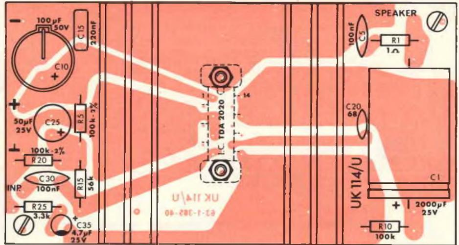
Fig. 2 - Disposizione dei componenti sulla basetta dell'amplificatore da 20 W.
