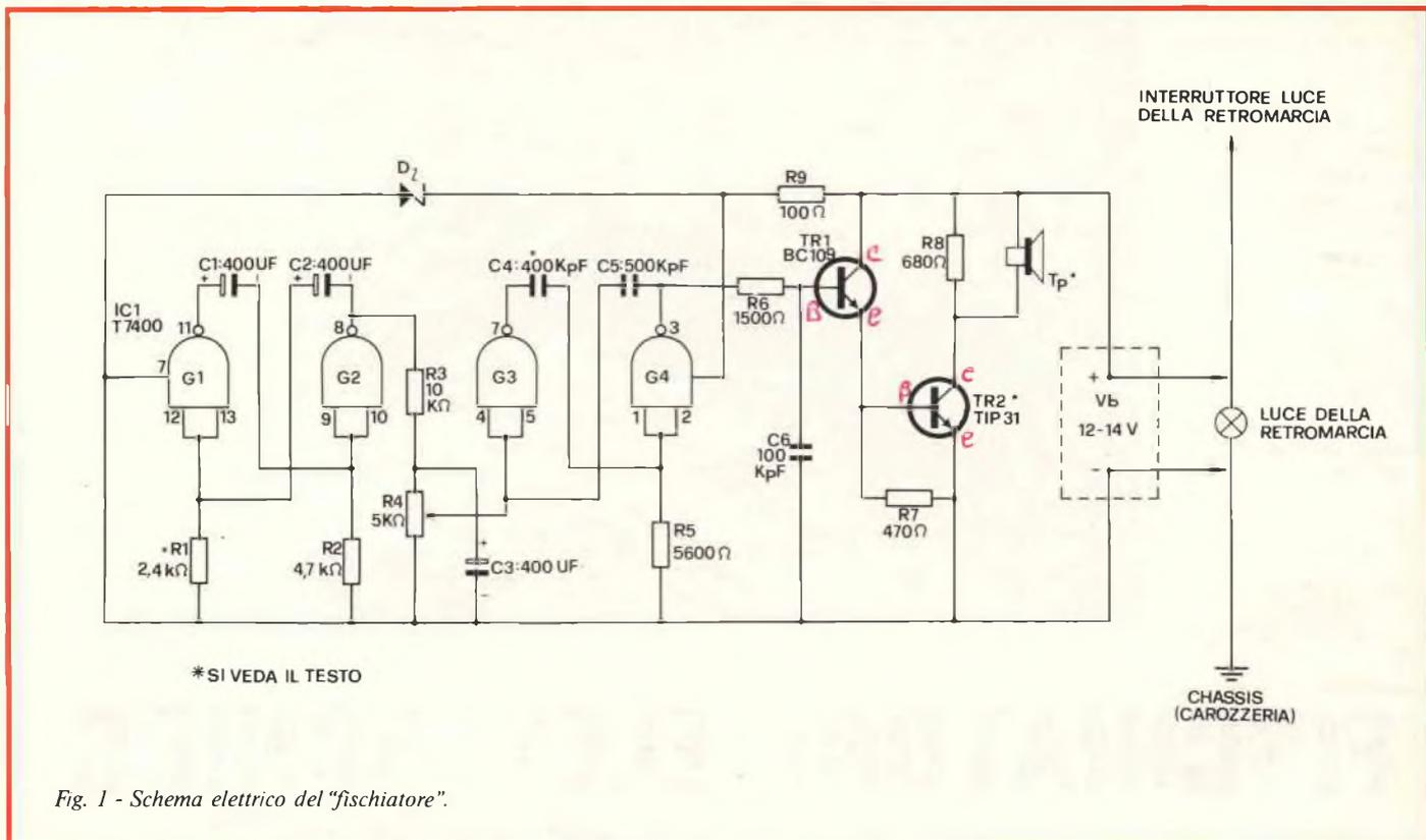
Fig. 1 - Schema elettrico del "fischiatore".
