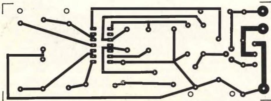
Fig. 2 - Disegno delle piste ramate sulla basetta stampata relativa al circuito di fig. 1.
