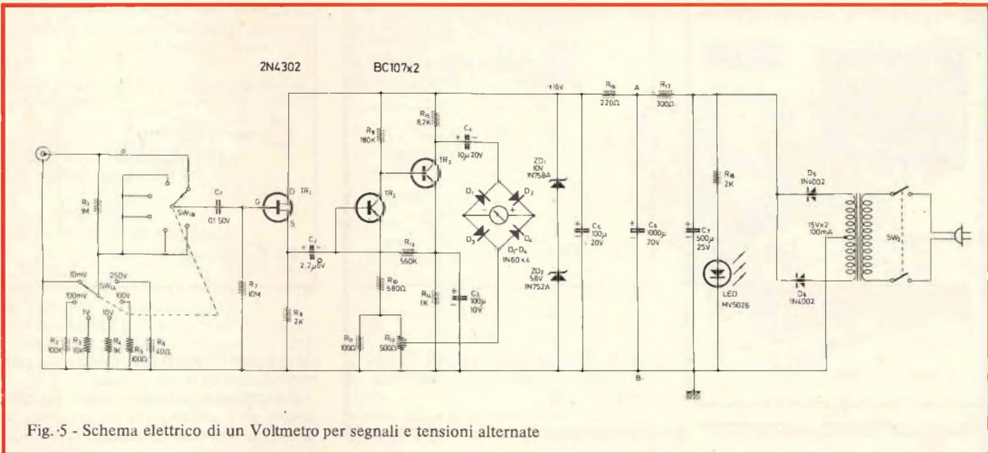
Fig. 5 - Schema elettrico di un Voltmetro per segnali e tensioni alternate
