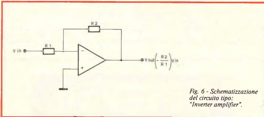
Fig. 6 - Schematizzazione del circuito tipo: "Inverter amplifier".
