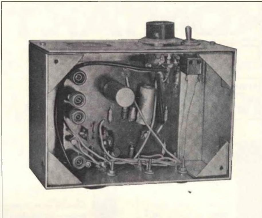
Fig. 4 - Fotografia dell'amplificatore completamente montato, visto dal di sotto: il coperchio inferiore è stato asportato per chiarire il metodo di fissaggio della basetta di supporto e dei componenti esterni.
