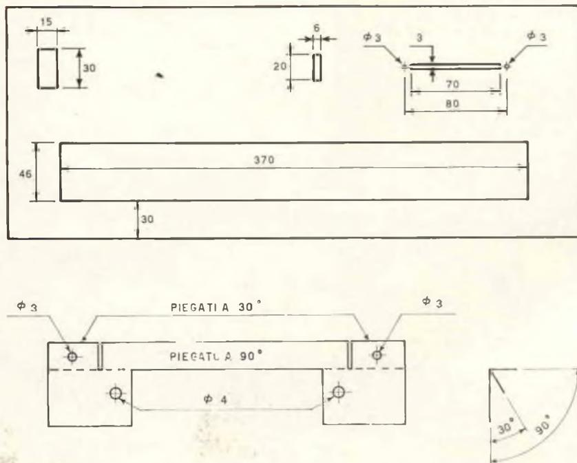
Fig. 2 - Piano di foratura del pannello frontale.
