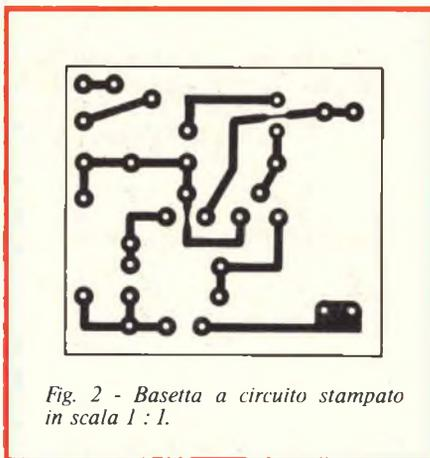
Fig. 2 - Basetta a circuito stampato in scala 1 : 1.
