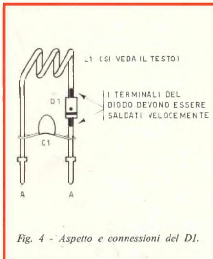
Fig. 4 - Aspetto e connessioni del D1.
