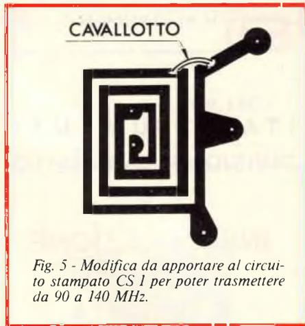
Fig. 5 - Modifica da apportare al circuito stampato CS 1 per poter trasmettere da 90 a 140 MHz.
