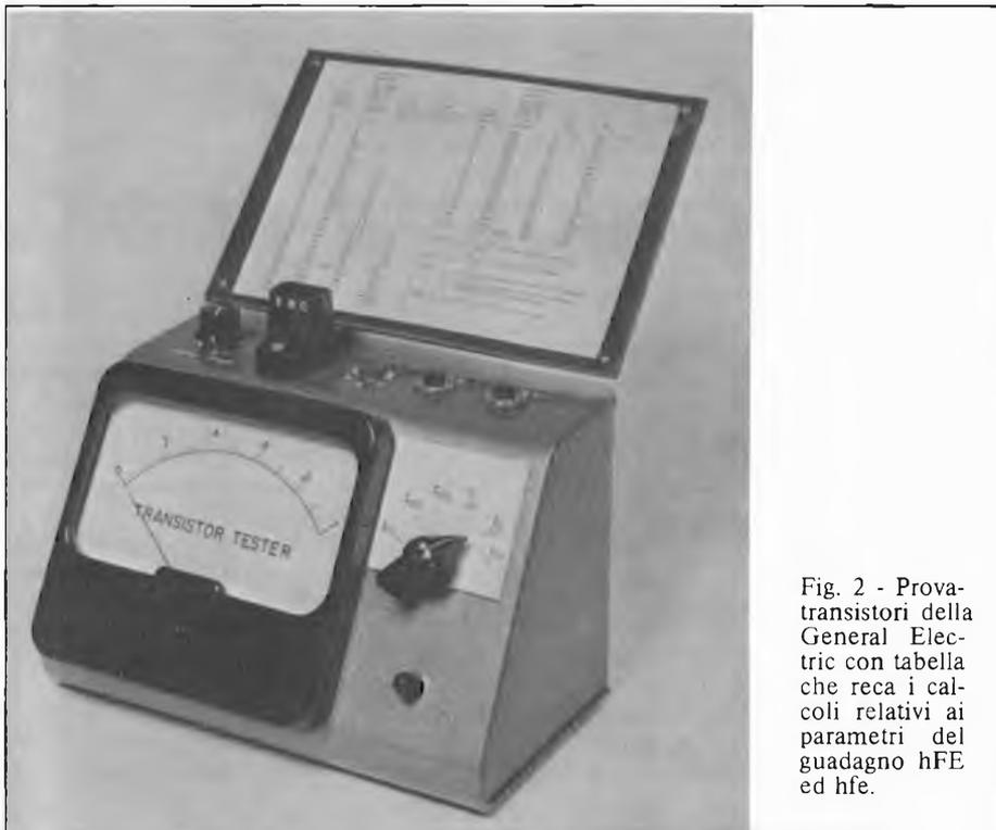
Fig. 2 - Prova-transistori della General Electric con tabella che reca i calcoli relativi ai parametri del guadagno hFE ed hfe.
