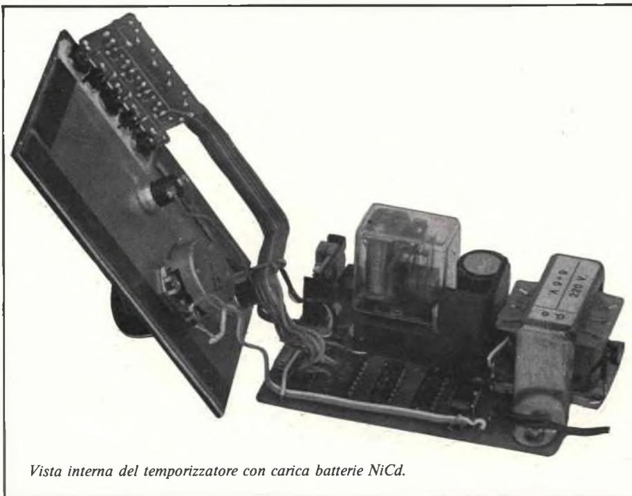
Vista interna del temporizzatore con carica batterie NiCd.
