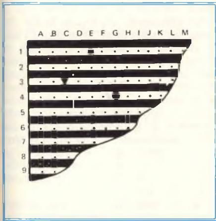
Fig. 11 - Matrice Blob-Board e coordinate per lo studio del piazzamento delle parti; il segno a forma quadra identifica la connessione "1E", quello triangolare la connessione "3C" ed infine il segno ritondo il punto "4G".
