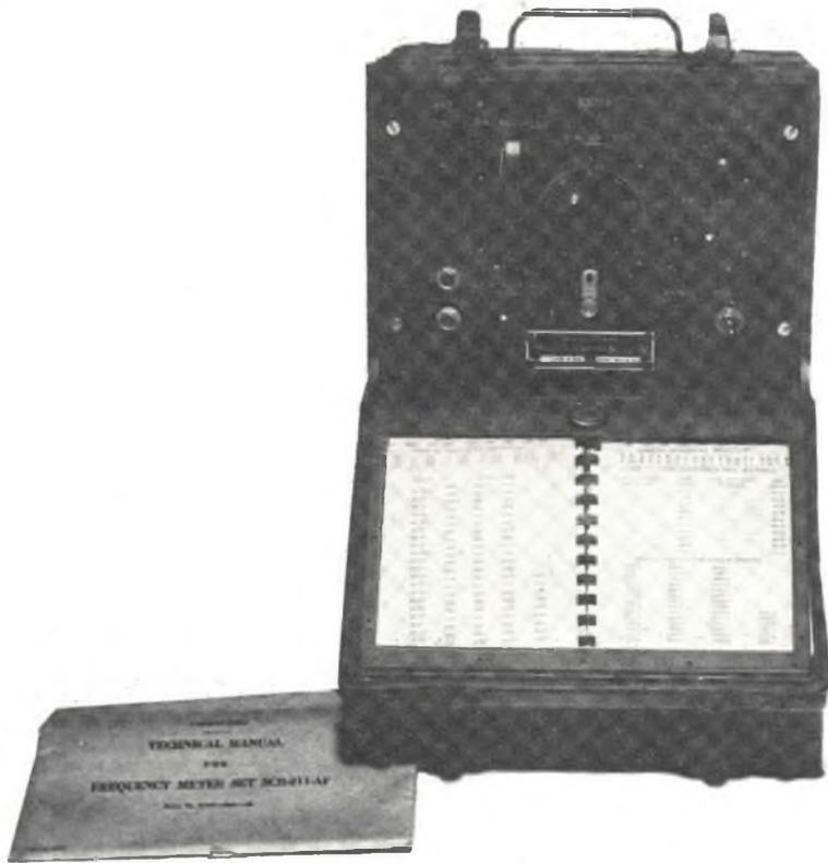
Fig. 4 - Aspetto del BC 221 completo di manuale
