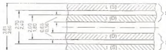
Fig. 6 - Caratteristiche del nastro di una compact-cassetta per registrazione mono-stereo.
