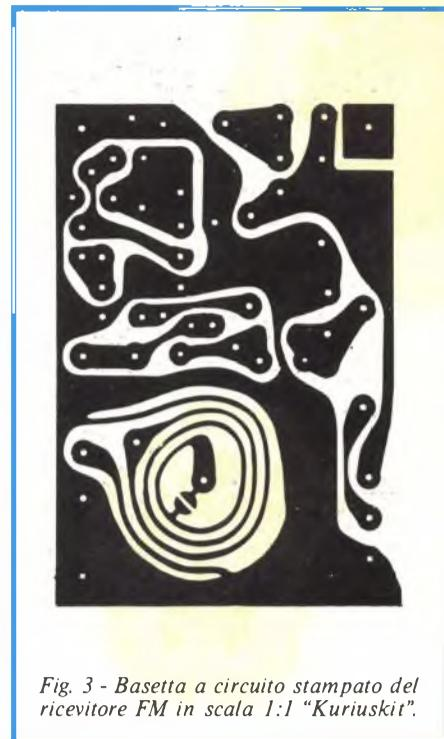
Fig. 3 - Basetta a circuito stampato del ricevitore FM in scala 1:1 "Kuriuskit".
