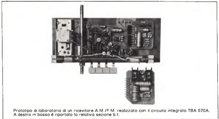
Prototipo di laboratorio di un ricevitore A.M./F.M. realizzato con il circuito integrato TBA 570A. A destra in basso è riportato lo relativa sezione b.f.
