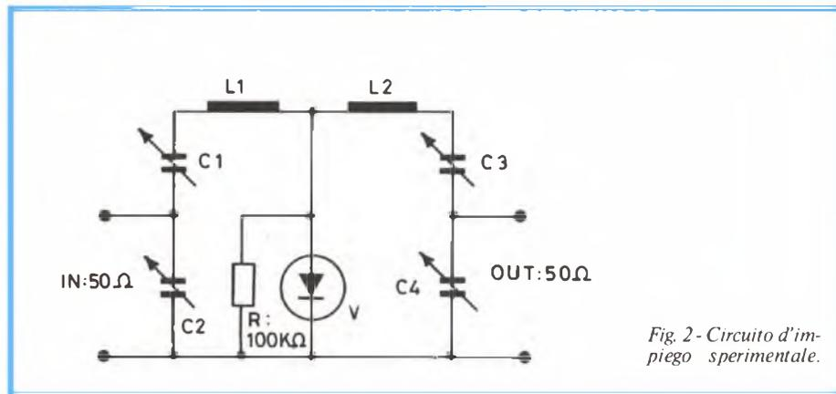
Fig. 2 - Circuito d'impiego sperimentale.
