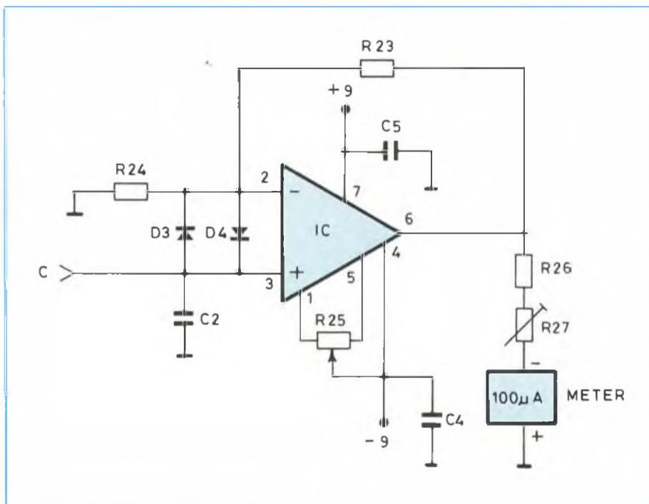
Fig. 1 - Schema elettrico dell'amplificatore in corrente continua.
