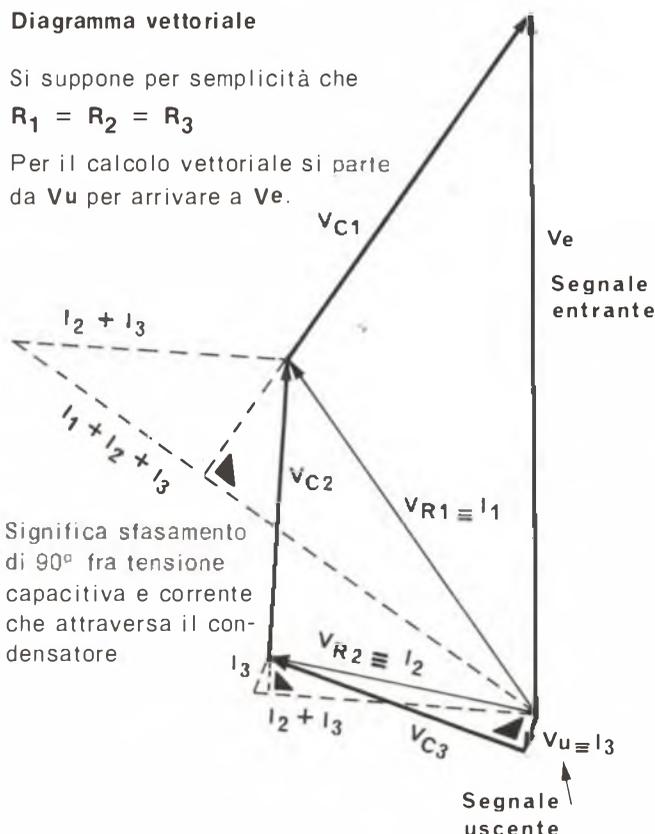
Significa sfasamento di  $90^\circ$  fra tensione capacitiva e corrente che attraversa il condensatore
