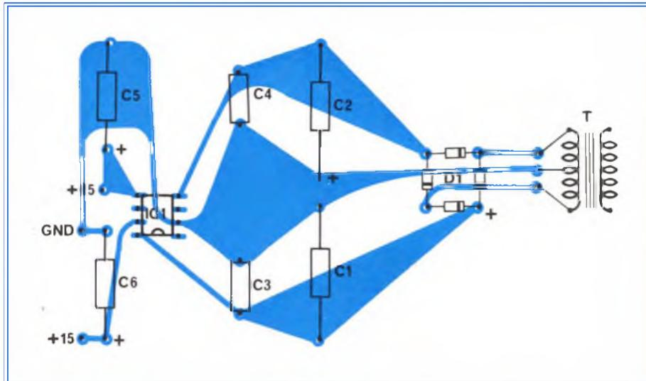
Fig. 9 - Disposizione componenti sul circuito stampato di fig. 8.
