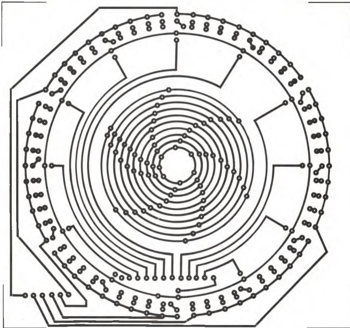
Fig. 3 - Basetta stampata relativa all'indicatore a diodi luminescenti.
