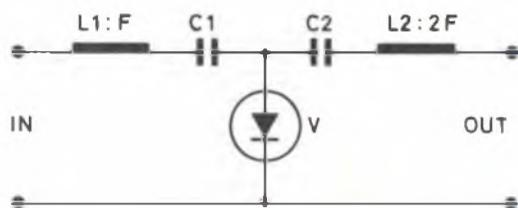
Fig. 1 - Circuito tipico di un moltiplicatore a varactor.
