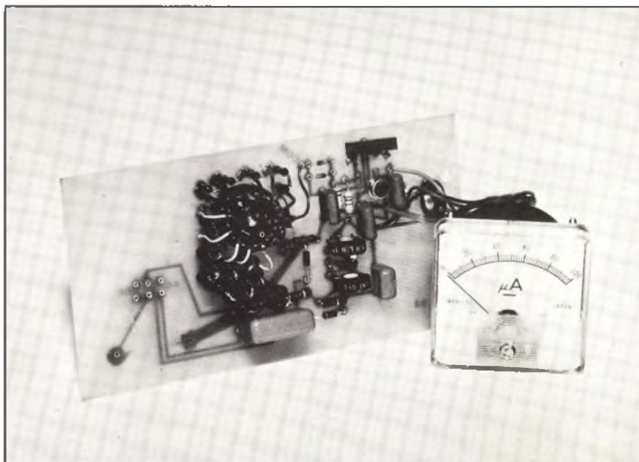
Fig. 2 - Circuito del partitore di tensione di ingresso
