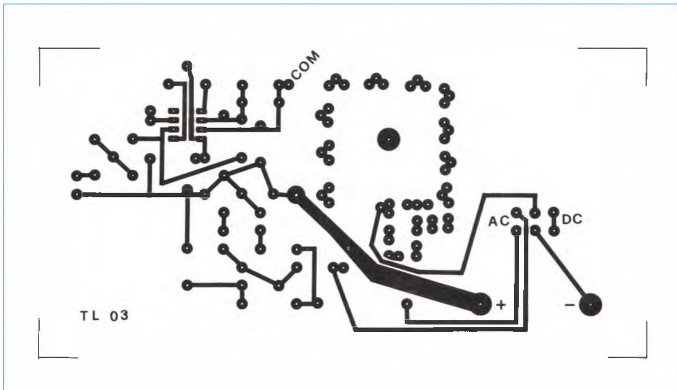
Fig. 4 - Circuito stampato del voltmetro analogico elettronico
