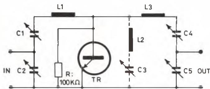
Fig. 4 - Circuito definitivo di duplicatore triplicatore VHF.
