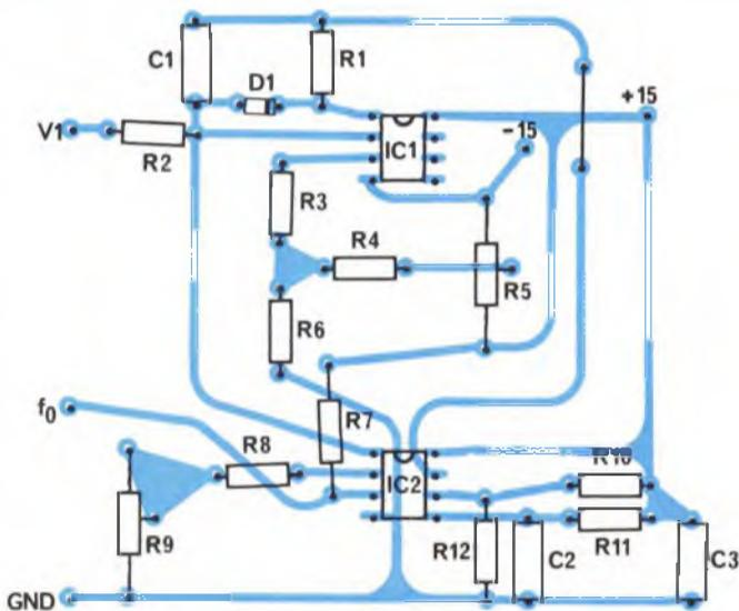
Fig. 5 - Disposizione componenti sul circuito stampato di fig. 4.
