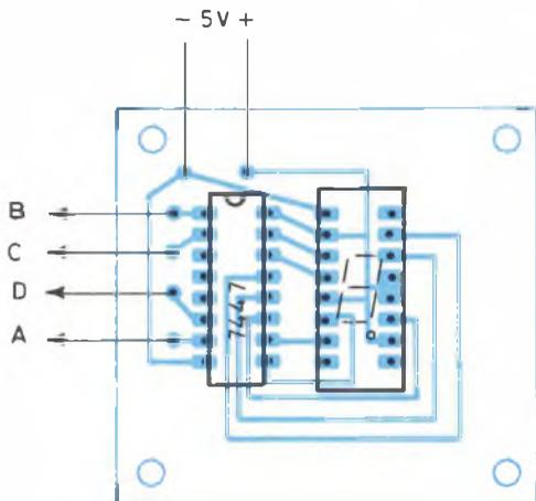
Fig. 6 - Disposizione dei componenti sul circuito stampato in fig. 5. I terminali A, B, C, D devono esser collegati con i punti corrispondenti della piastra comandi.
