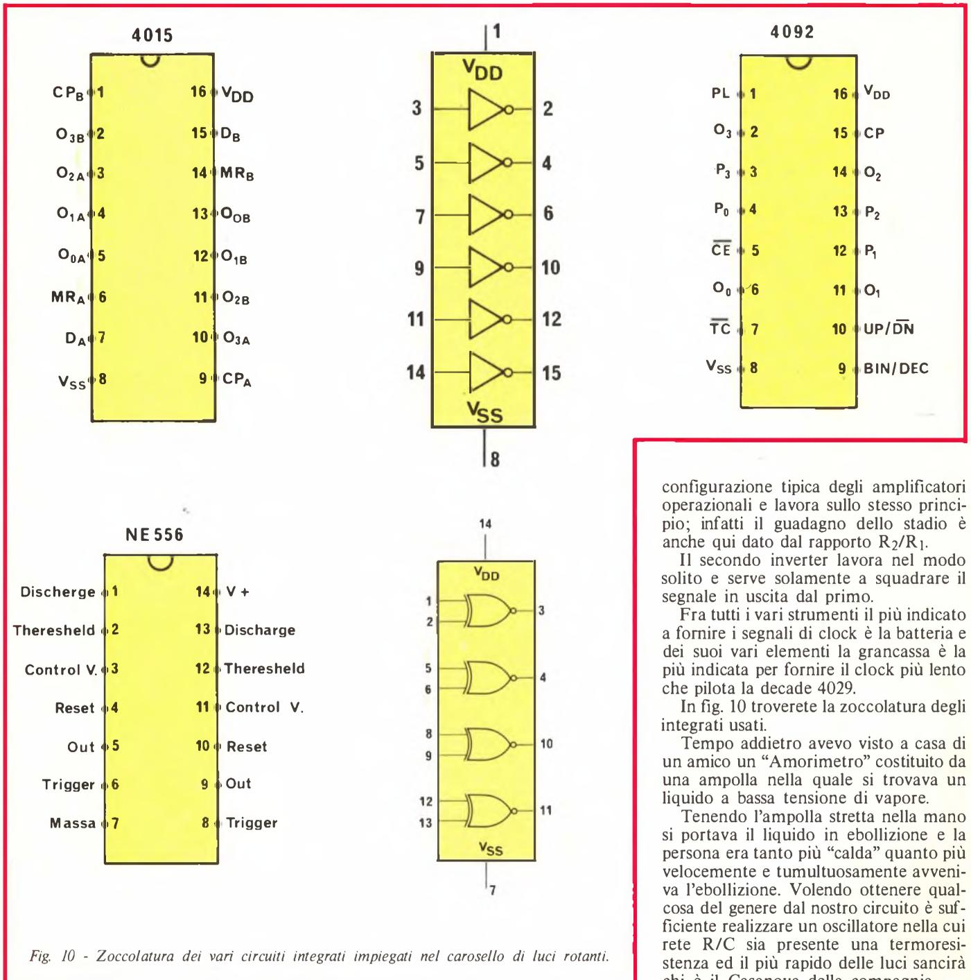
Fig. 10 - Zoccolatura dei vari circuiti integrati impiegati nel carosello di luci rotanti.
