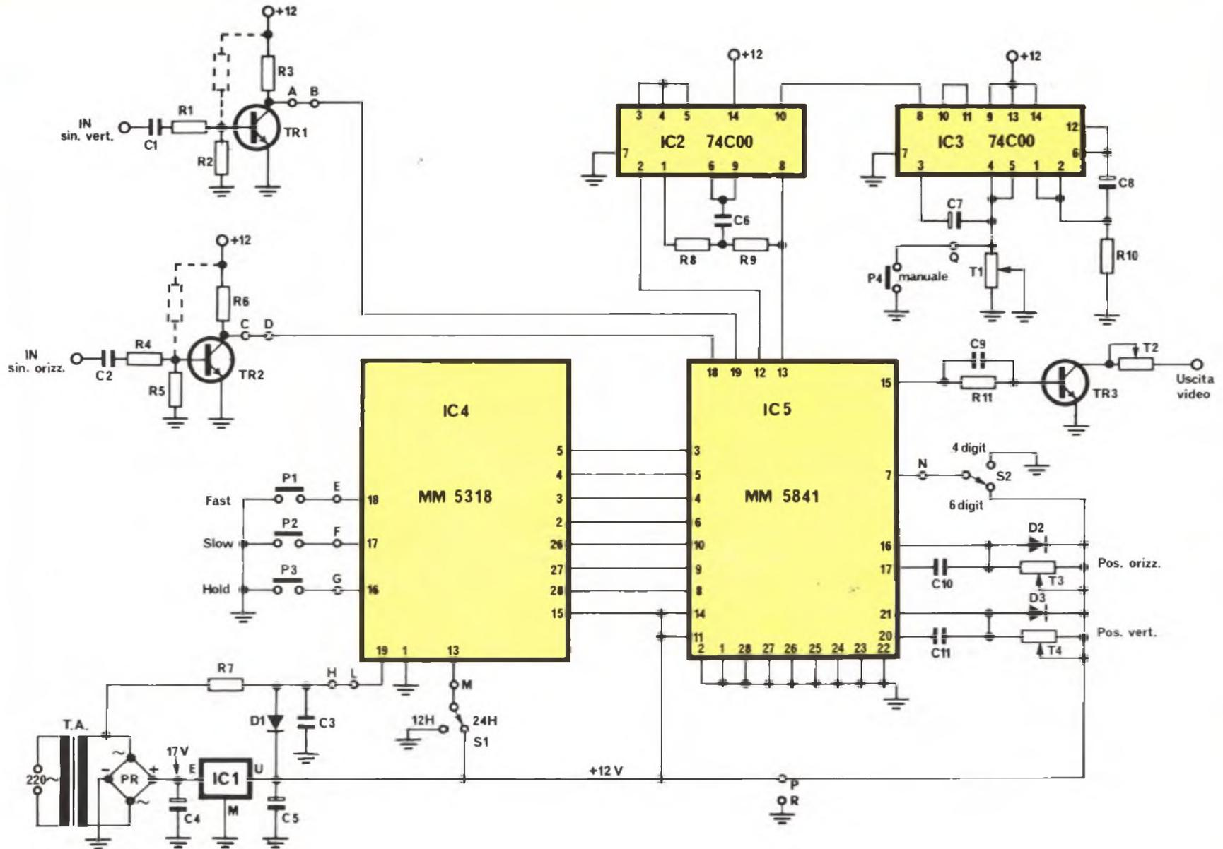
Fig. 1 - Schema elettrico completo del "TV-Clock". I resistori R2 ed R5 andranno posizionati a seconda dell'andamento dei segnali d'ingresso.
