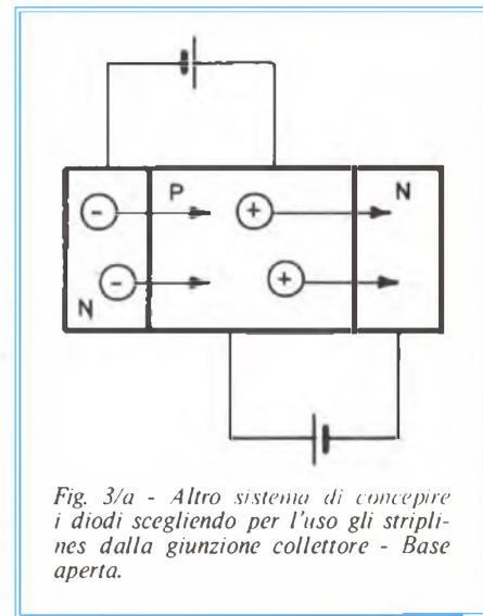
Fig. 3/a - Altro sistema di concepire i diodi scegliendo per l'uso gli striplines dalla giunzione collettore - Base aperta.
