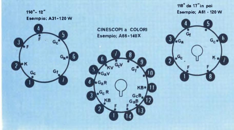
Connessioni filamenti valvole e connessioni zoccoli cinescopi. F = Filamento acceleratore (Griglia schema). Gf = Anodo focalizzatore. V = Verde. R = Rosso. B = Blu. K = Katodo. Ge = Griglia controllo. Ga = Anodo.
