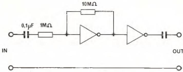
Fig. 9 - Amplificatore squadratore realizzato con due inverter C-MOS.
