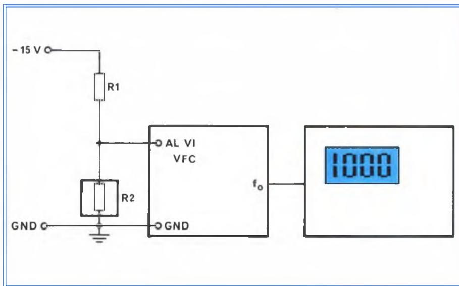
Fig. 10 - Esempio di utilizzazione con termistore o fotoresistenza.
