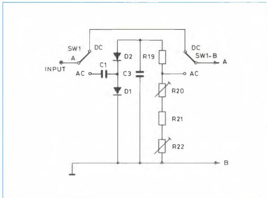
Fig. 3 - Schema del rettificatore delle tensioni alternate e del commutatore CC-CA.
