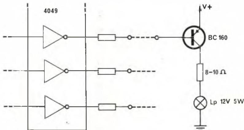
Fig. 7 - Schema dell'eventuale circuito di pilotaggio di lampadine.
