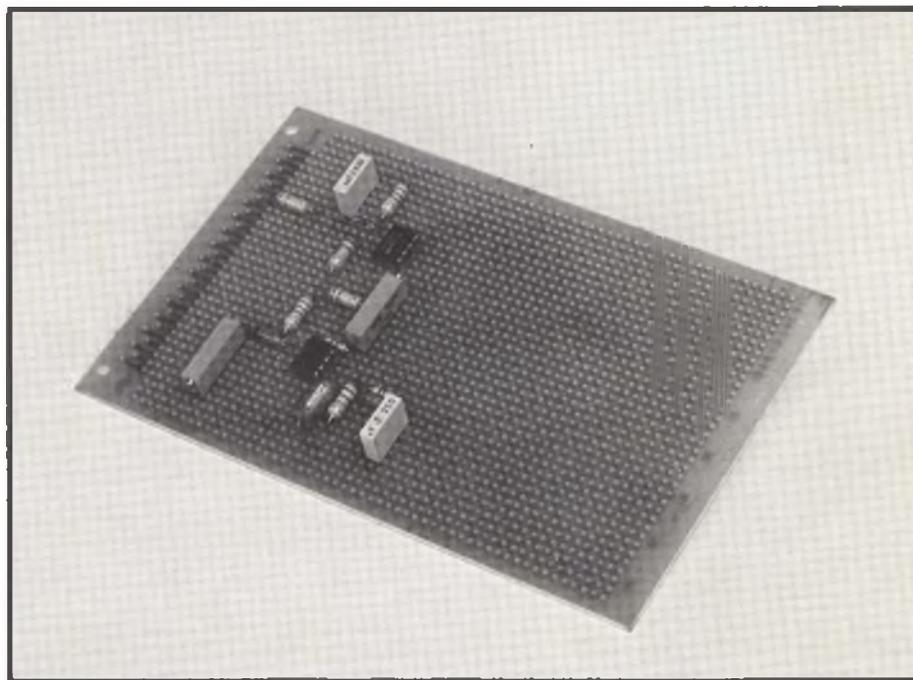
Fig. 2 - Prototipo del convertitore tensione frequenza realizzato su basetta perforata.
