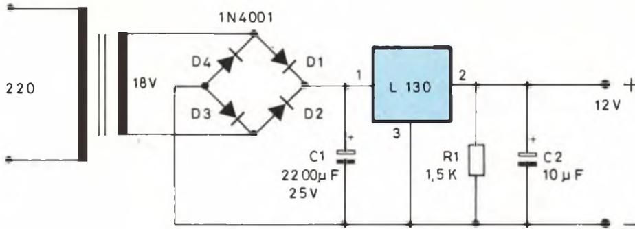
Fig. 1 - Schema elettrico dell'alimentatore IC KS250 della "Kuriuskit".
