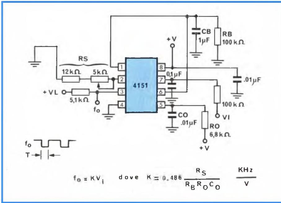
Fig. 2 - Circuito di prova dell'integrato 4151.
