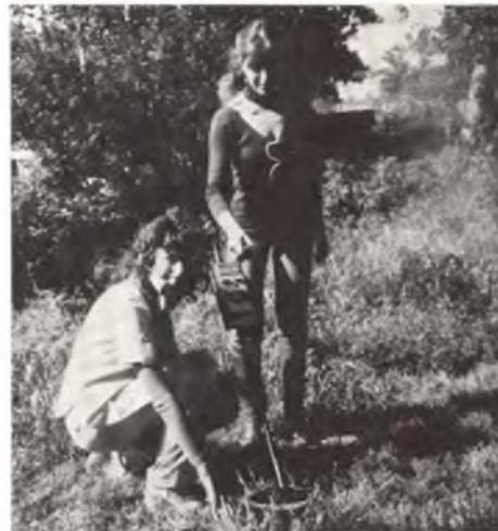
Fig. 5 - Impiego corretto del C-Scope; la "paddella rivettrice" è tenuta a 5 cm dal terreno.
