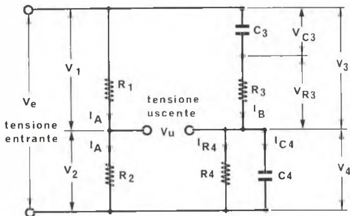
Il caso particolare che qui esaminiamo contempla ciò che succede quando le tensioni  $V_3$  e  $V_4$  del ramo reattivo hanno la stessa fase delle tensioni  $V_1$  e  $V_2$  del ramo resistivo.
