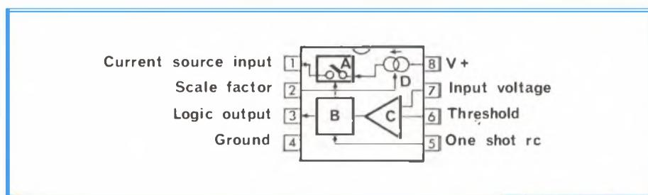
Fig. 1 - Disposizione piedini e schema a blocchi dell'integrato 4151.
