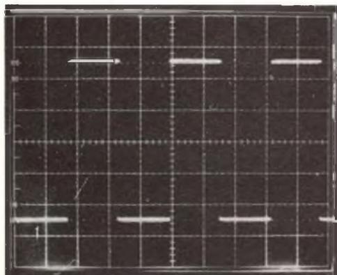
Fig. 2/a - Onda quadra ottenuta commutando S2.
