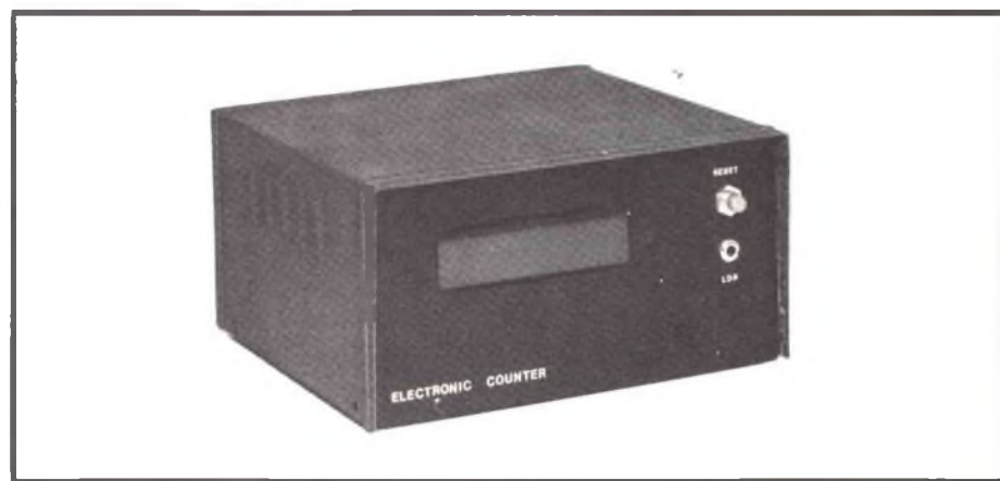
Vista esterna del contapezzi a realizzazione ultimata.
