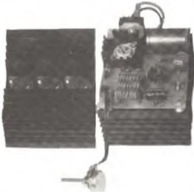
**Mod. 3** - Volt da 0,7 a 30 - carico max 6,5 A corrente lavoro 5 A autoprotetto contro i cortocircuiti. **L. 45.000**
