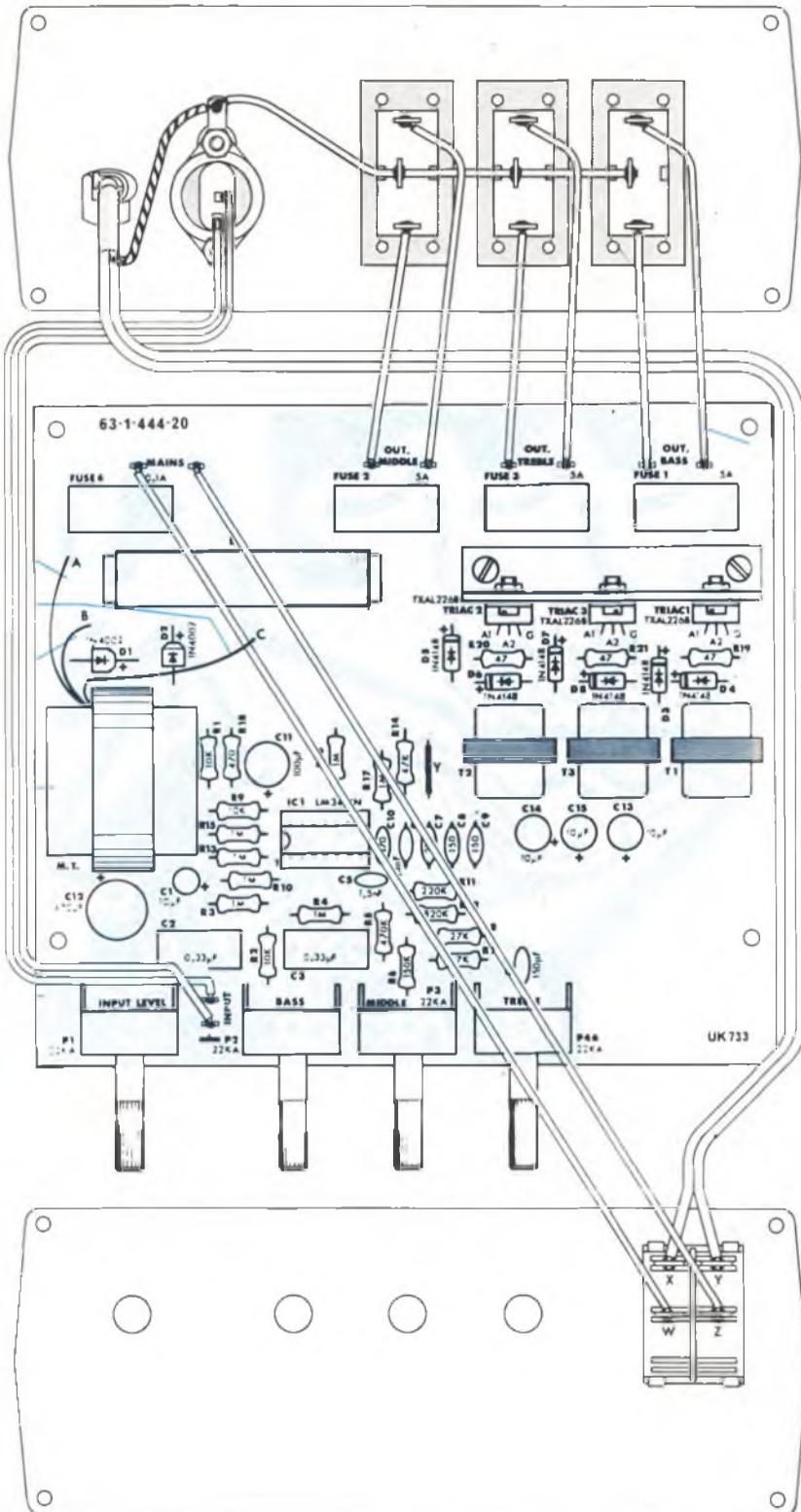
Fig. 6 - Assemblaggio generale del generatore di luci psichedeliche 3 x 1000 W.
