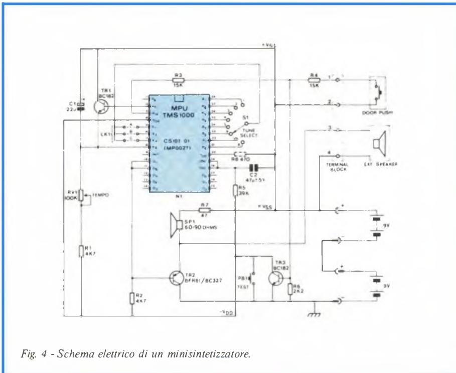
Fig. 4 - Schema elettrico di un minisintetizzatore.
