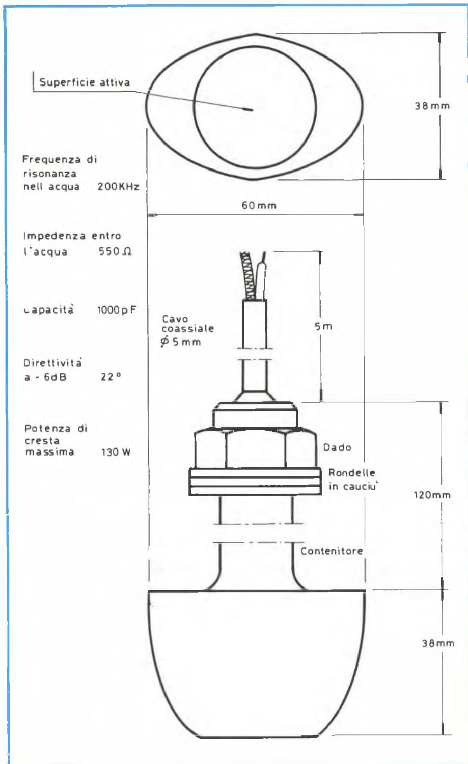
Fig. 1 - Caratteristiche del trasduttore UT 200 LLS
