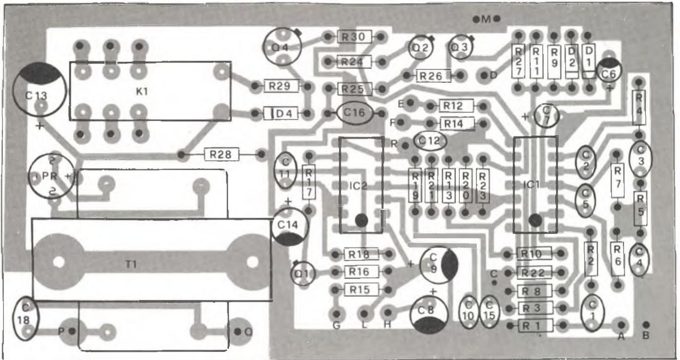
Fig. 4- Disposizione dei componenti sulla basetta stampata.
