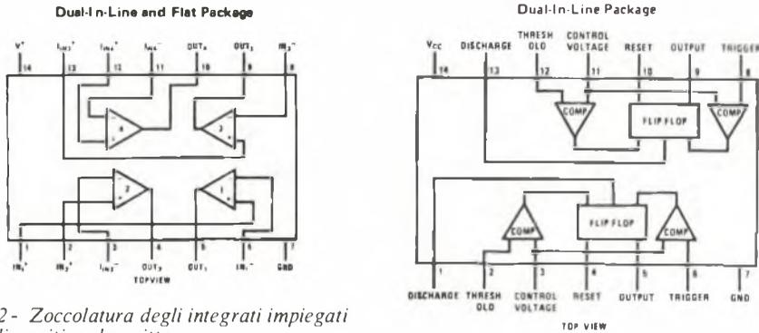
Fig. 2 - Zoccolatura degli integrati impiegati nel dispositivo descritto.
