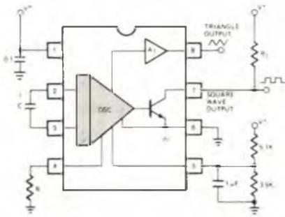
Fig. 4 - Generatore di funzioni funzionante con l'alimentazione classica (negativo a massa). I terminali +V sono diretti al positivo; le parti "R-C-RL" sono commentate nel testo.
