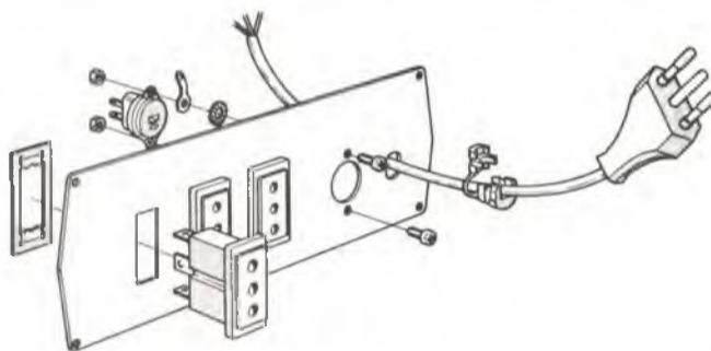
Fig. 4 - Esploso delle parti allocate sul pannello posteriore
