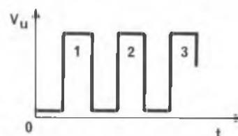
L'azione fissatrice (vedi 31.62) del condensatore col diodo formato fra base ed emettitore del transistor sarà tale da polarizzare (clamping) interamente il segnale (vedi anche 32.83).
