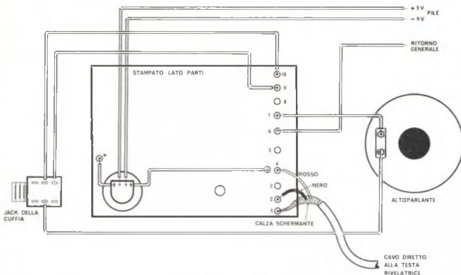
Fig. 6 - Disegno semplificato dello chassis IB/TR200.
