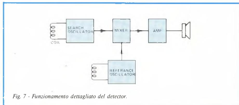
Fig. 7 - Funzionamento dettagliato del detector.
