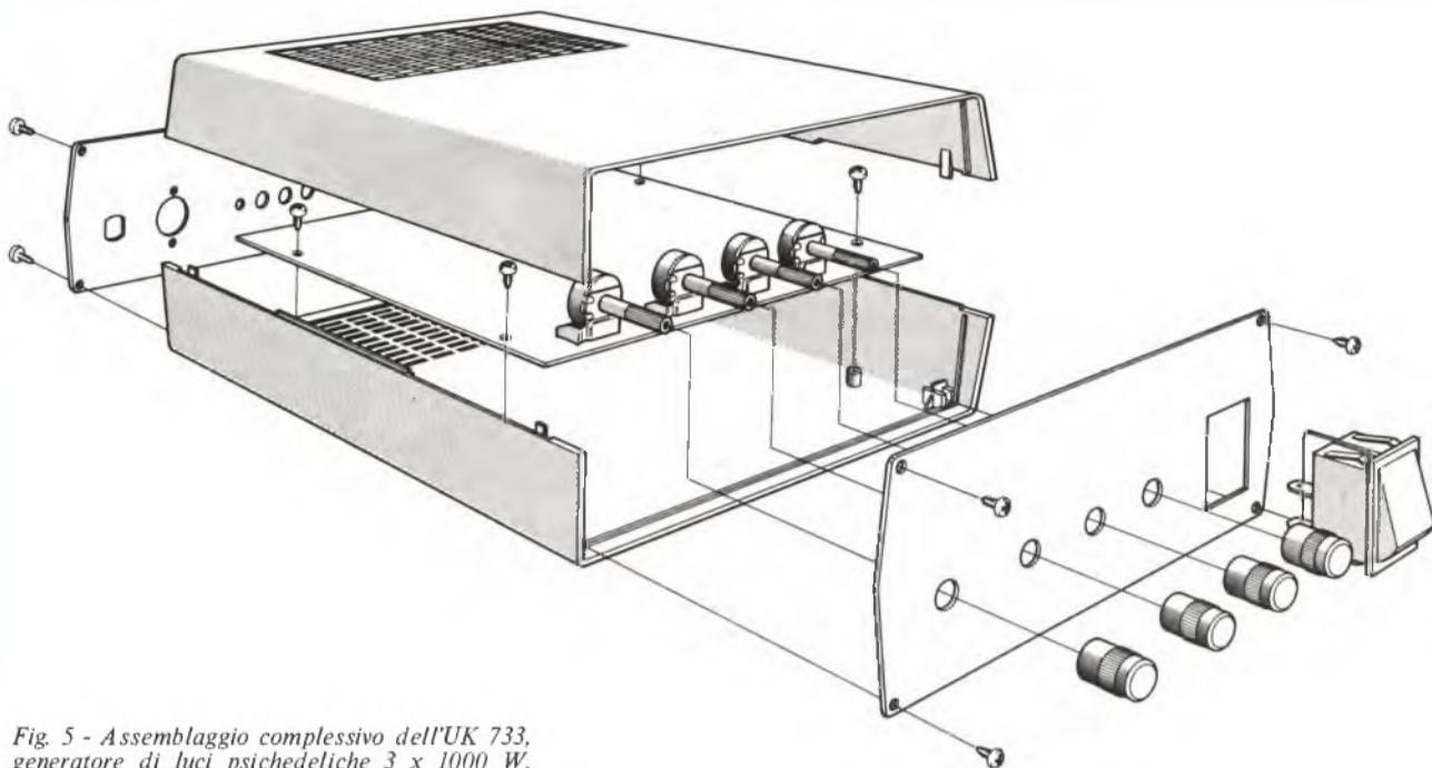
Fig. 5 - Assemblaggio complessivo dell'UK 733, generatore di luci psichedeliche 3 x 1000 W.
