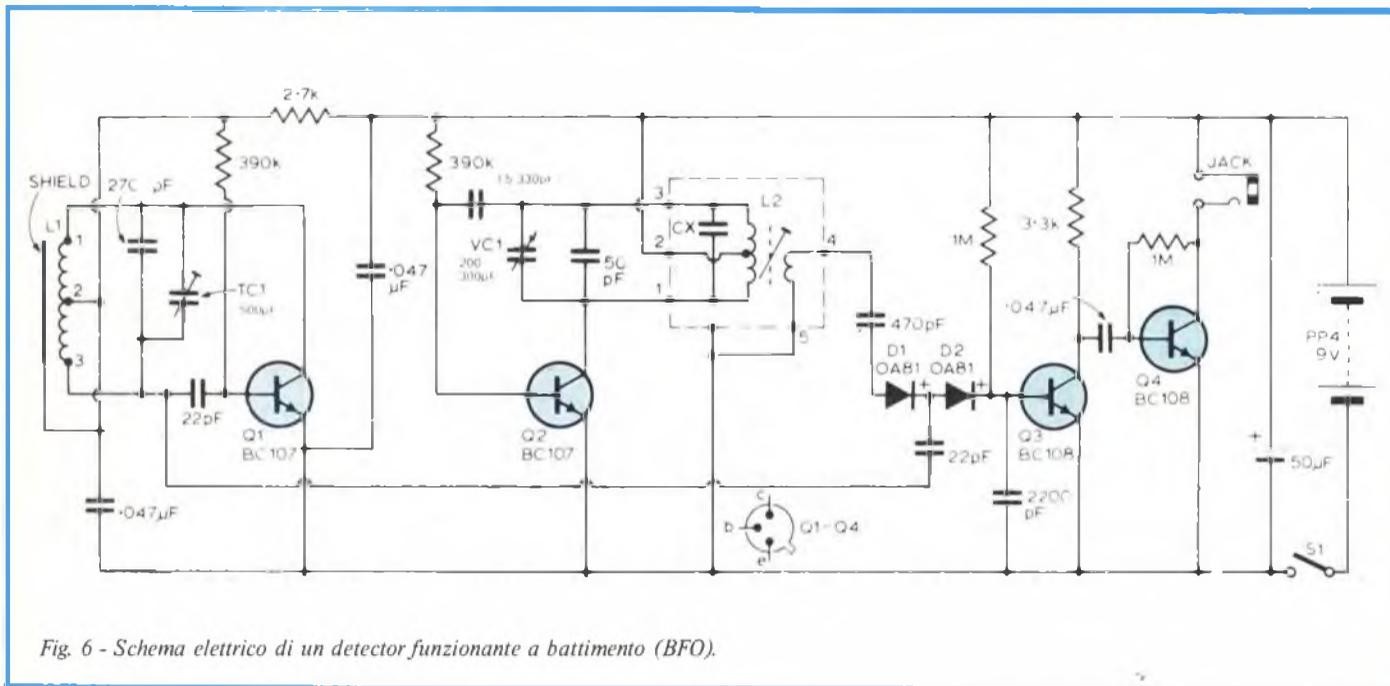
Fig. 6 - Schema elettrico di un detector funzionante a battimento (BFO).
