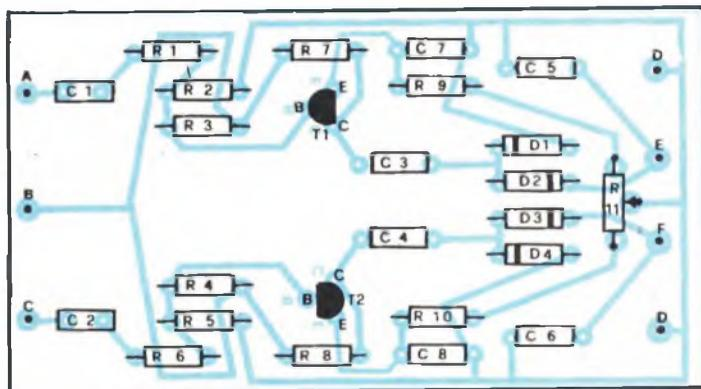
Fig. 4 - Disposizione dei componenti sulla basetta dell'amplificatore simmetrico.
