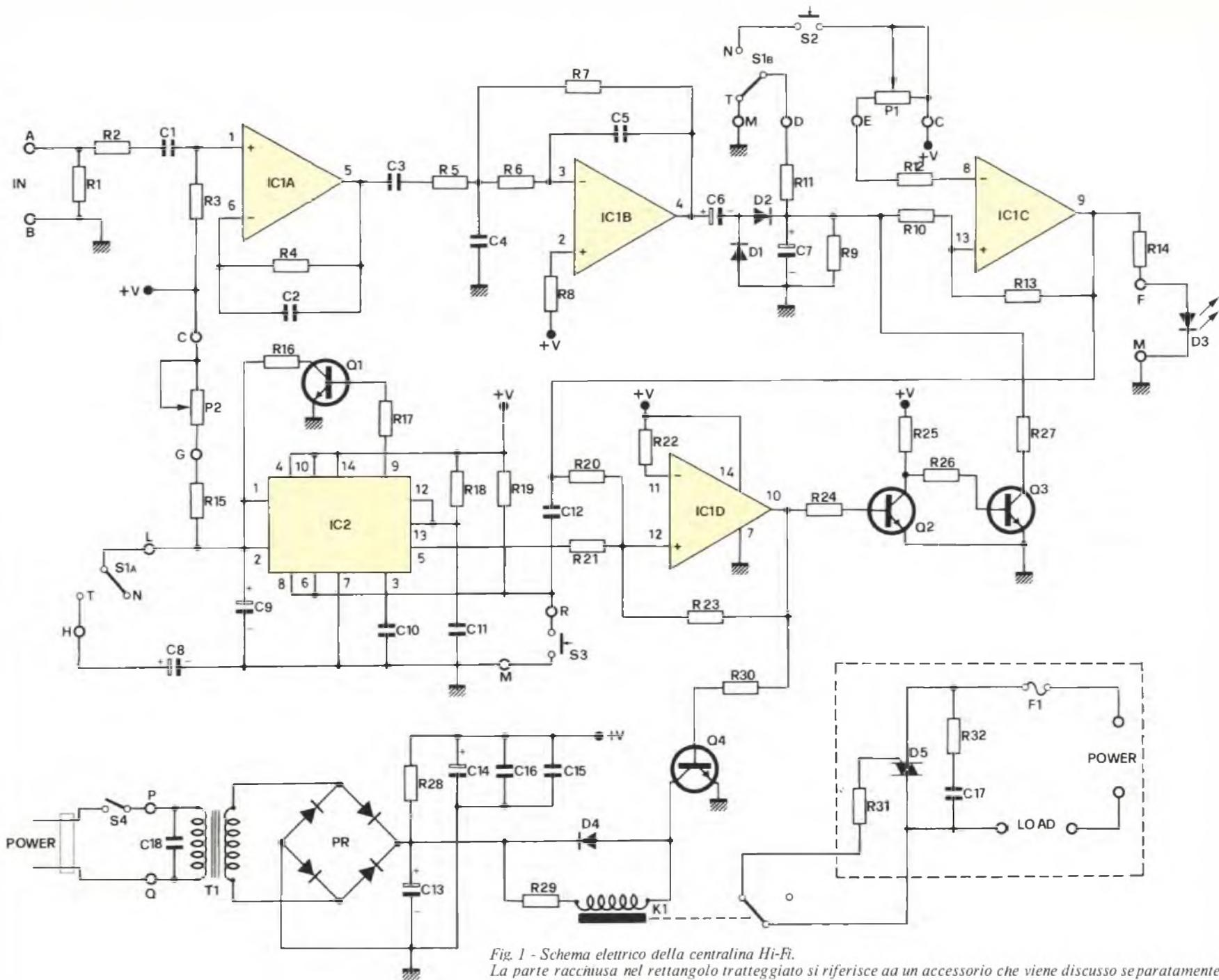
Fig. 1 - Schema elettrico della centralina Hi-Fi.
