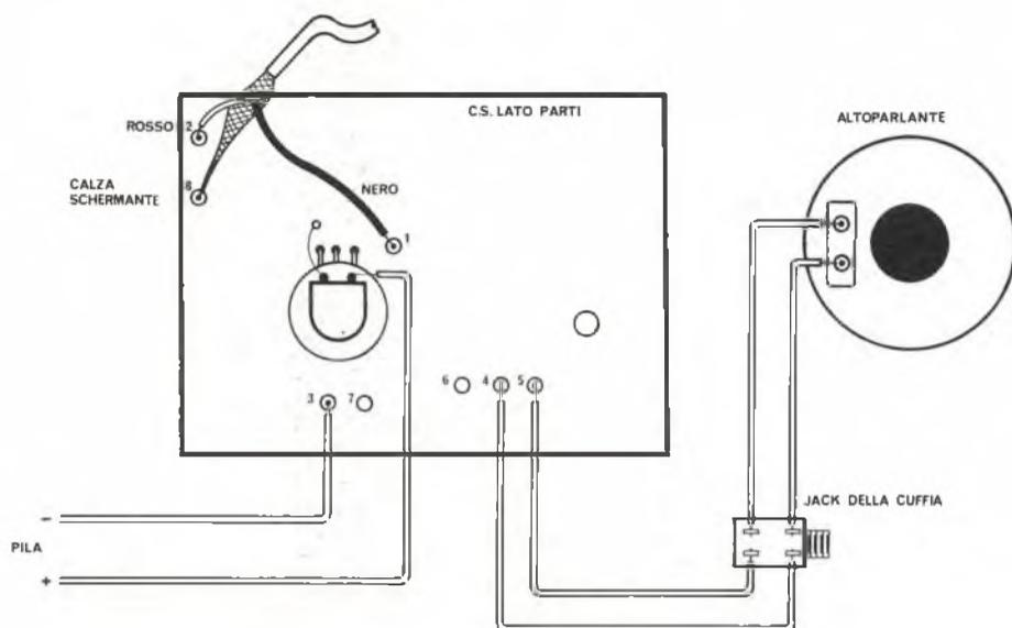
Fig. 2 - Disegno semplificato dello chassis del BFO-50
