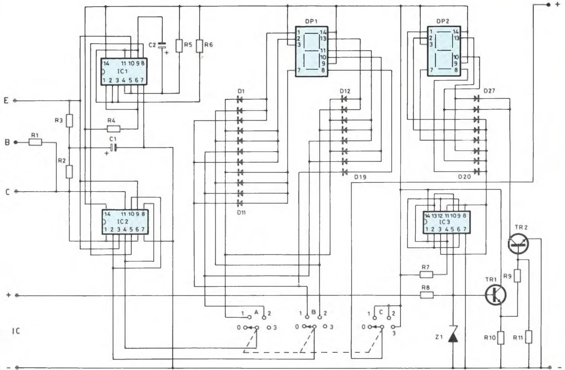
Fig. 1 - Schema elettrico del prova transistori digitale
