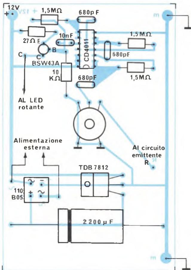
Fig. 11 - Disposizione dei componenti sulla basetta ricevente
