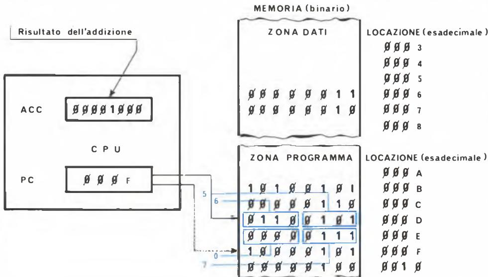
Anche questa è una istruzione da due bytes. Il dato contenuto nella settima posizione di memoria viene sommato al contenuto dell'ACCUMULATORE che, a istruzione eseguita, contiene il risultato dell'addizione.
