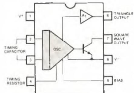
Fig. 2 - Connessioni ai terminali dei blocchi attivi interni, funzioni ed alimentazione.
