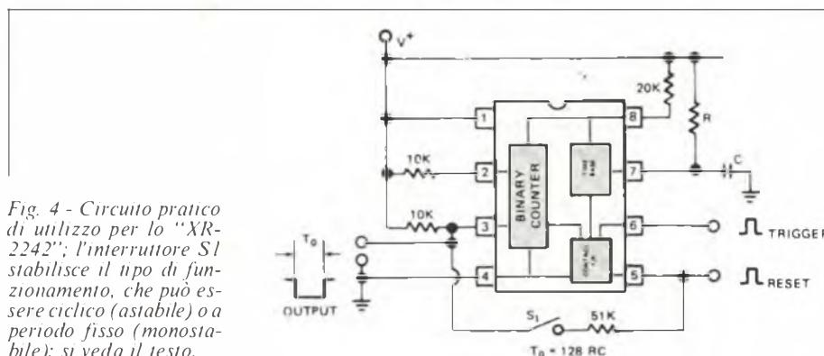
Fig. 4 - Circuito pratico di utilizzo per lo "XR-2242"; l'interruttore S1 stabilisce il tipo di funzionamento, che può essere ciclico (astabile) o a periodo fisso (monostabile); si veda il testo.
