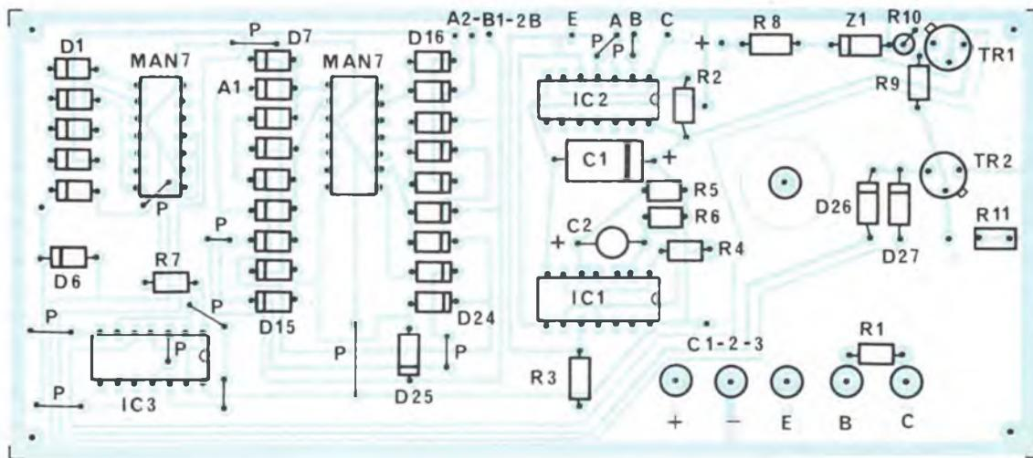
Fig. 3 - Disposizione dai componenti sulla basetta di figura 2 - La numerazione dei diodi (che sono identici tra di loro) viene dato in contrasto a quello dello schema elettrico per maggior chiarezza del disegno sopra riportato
