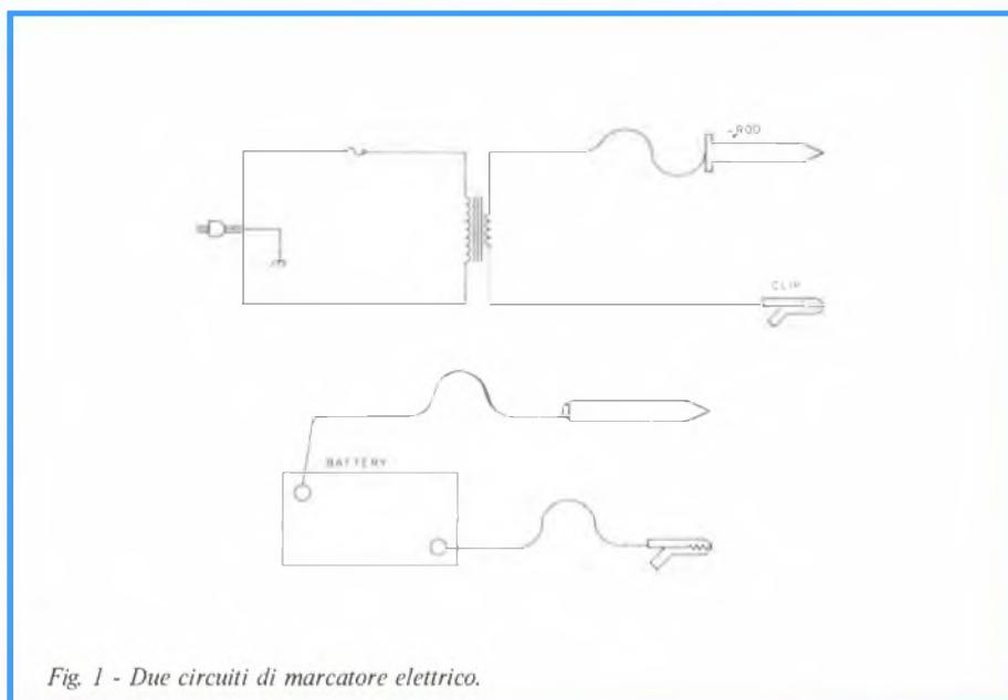
Fig. 1 - Due circuiti di marcatore elettrico.
