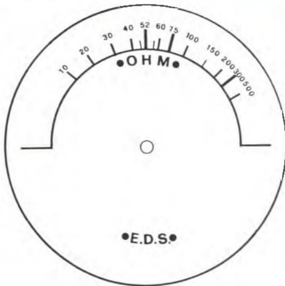
Fig. 6 - Scala graduata tarata in OHM in grandezza naturale dell'impedenziometro.
