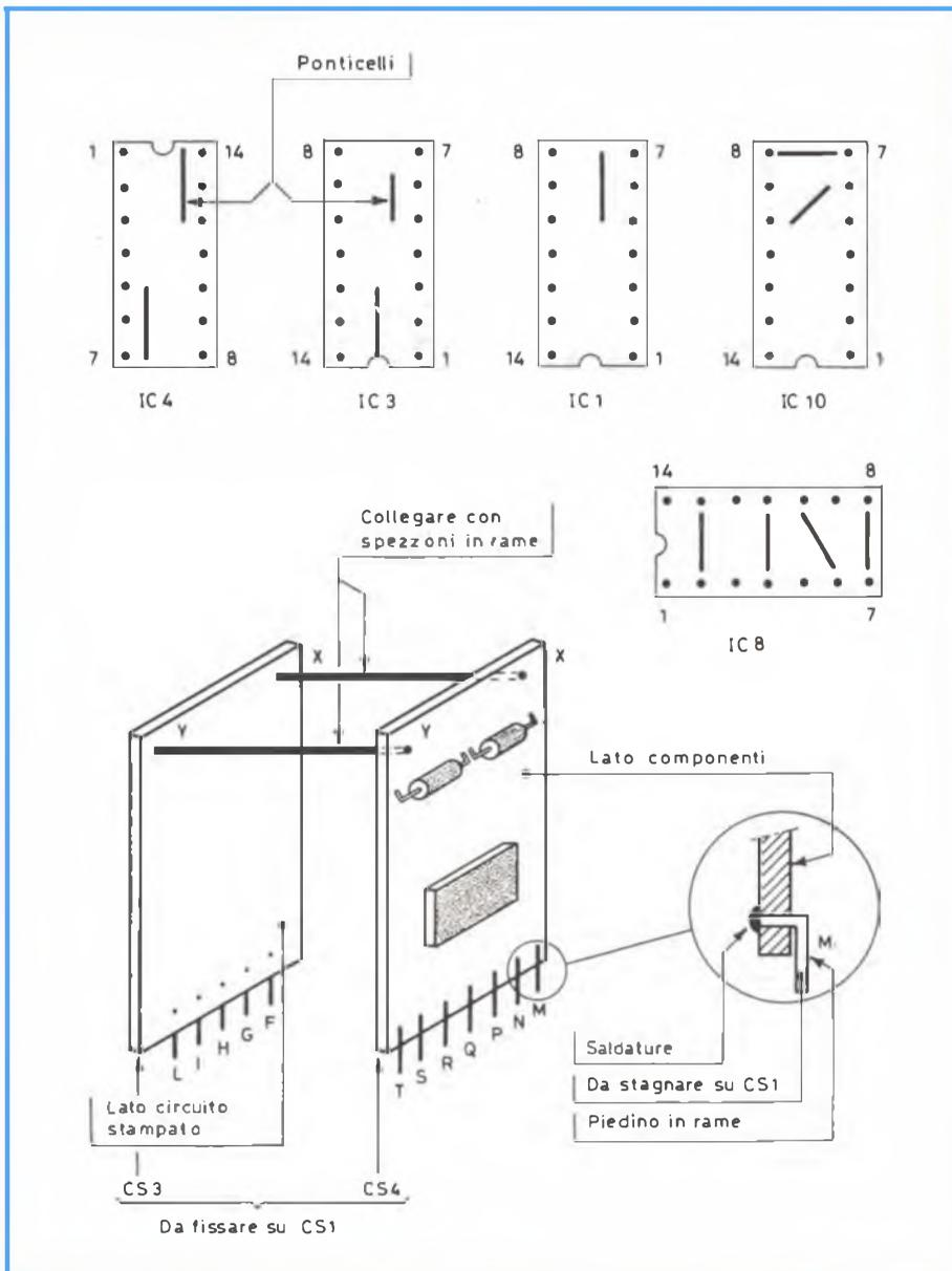
Fig. 3/b - Disposizione dei ponticelli sotto gli integrati.
