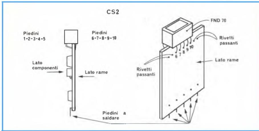
Fig. 3/a - Montaggio dei Display FND 70.
