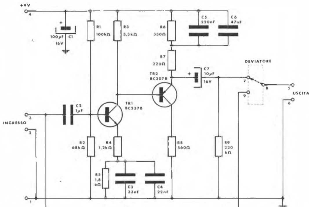
Fig. 1 - Schema elettrico dell'amplificatore di super acuti
