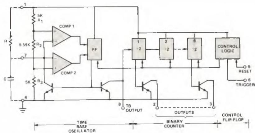
Fig. 1 - Circuito a blocchi dell'IC "XR-2242"
