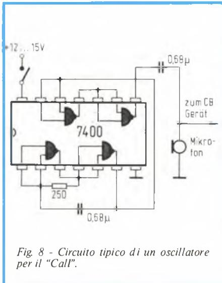
Fig. 8 - Circuito tipico di un oscillatore per il "Call".
