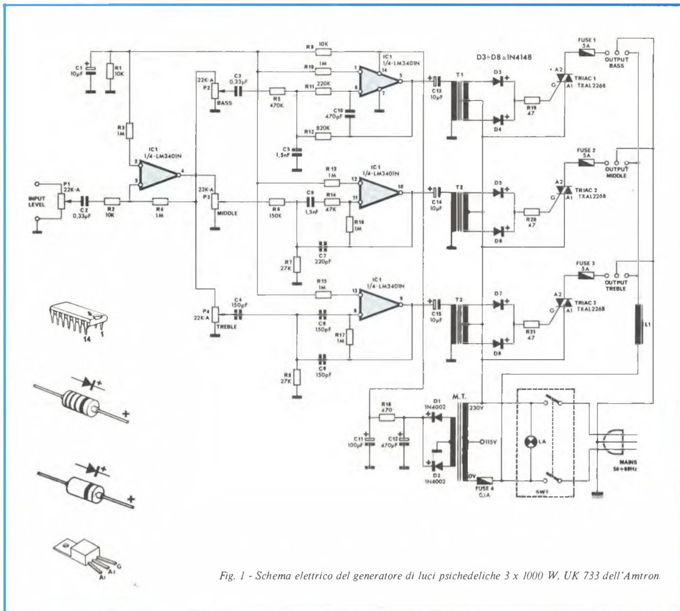
Fig. 1 - Schema elettrico del generatore di luci psichedeliche 3 x 1000 W, UK 733 dell'Amtron.
