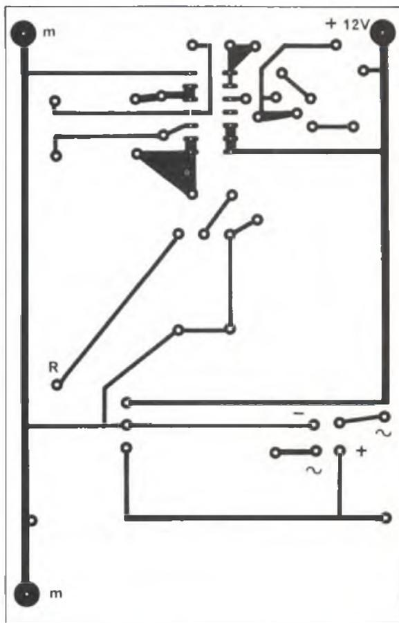
Fig. 10 - Basetta a circuito stampato della basetta ricevente in scala 1:1
