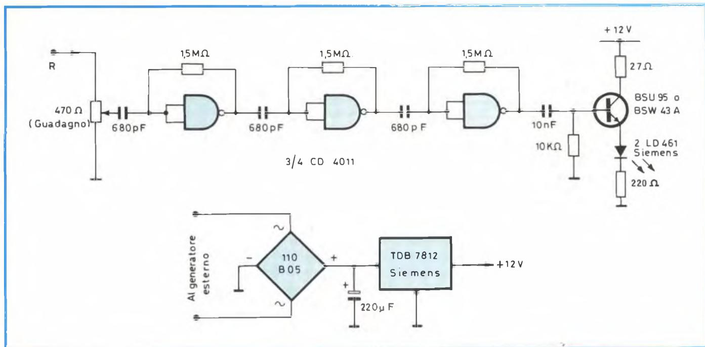
Fig. 5 - Schema di principio del ricevitore
