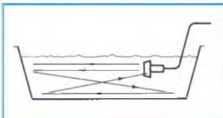
Fig. 13 - Controllo di funzionamento in acqua.
