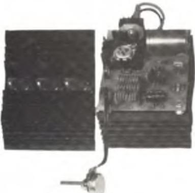
**Mod. 3** - Volt da 0,7 a 30 - carico max 6,5 A corrente lavoro 5 A autoprotetto contro i cortocircuiti.
