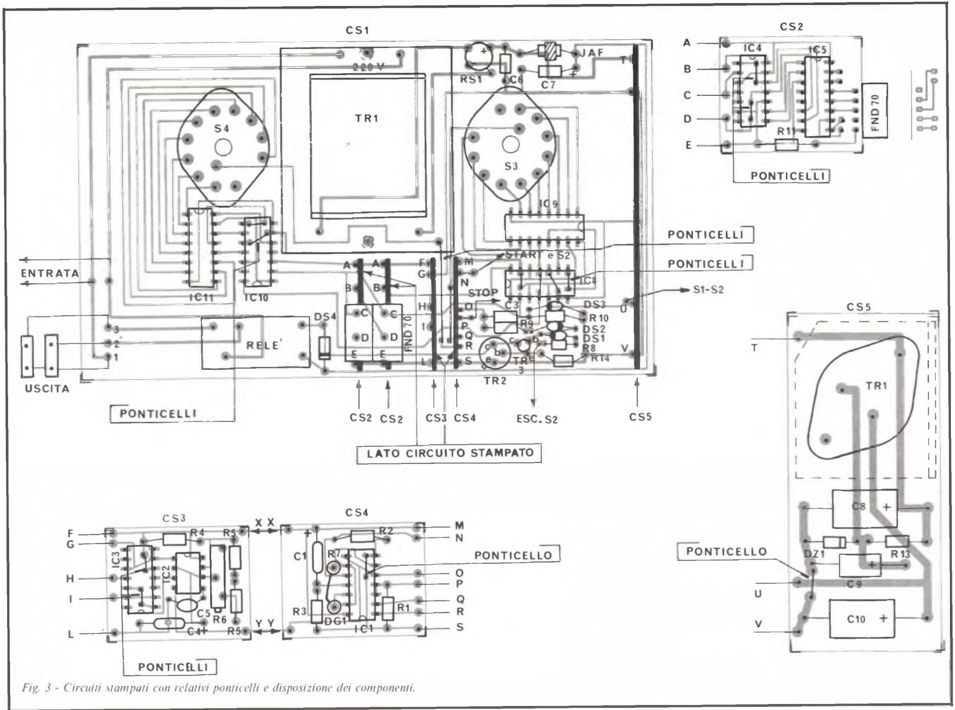
Fig. 3 - Circuiti stampati con relativi ponticelli e disposizione dei componenti.
