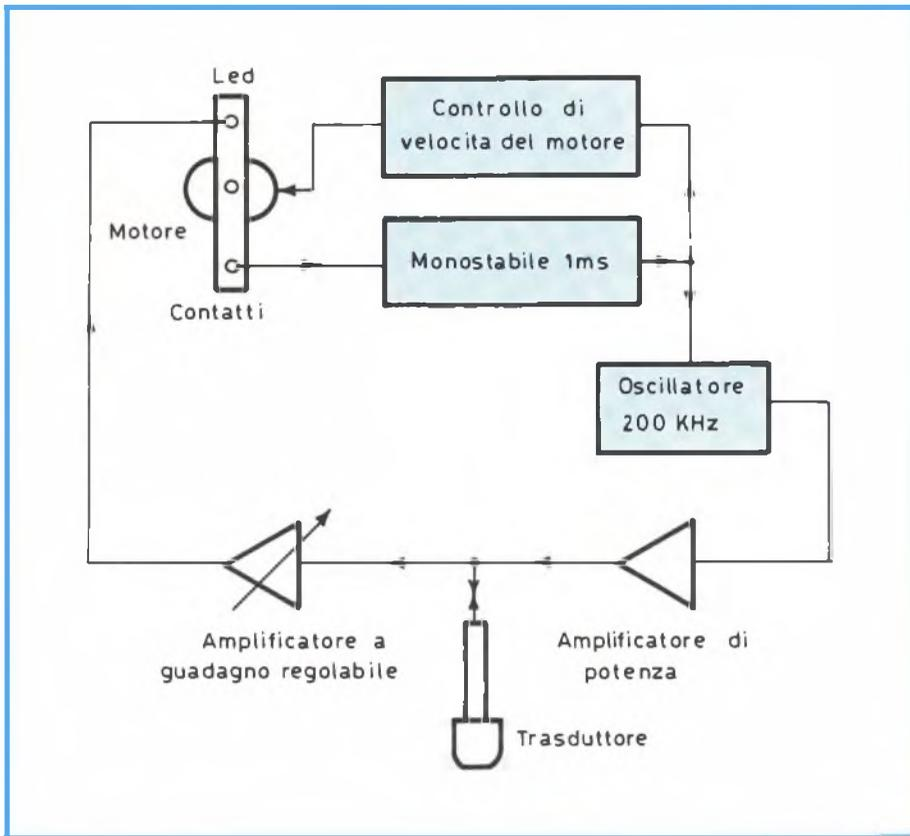
Fig. 3 - Schema a blocchi dell'Eco sonda
