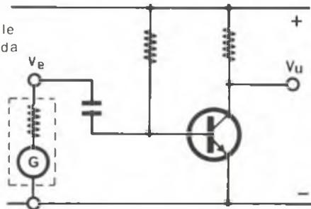
La polarizzazione del transistor è tale da trovarsi in conduzione in assenza di segnale entrante.
