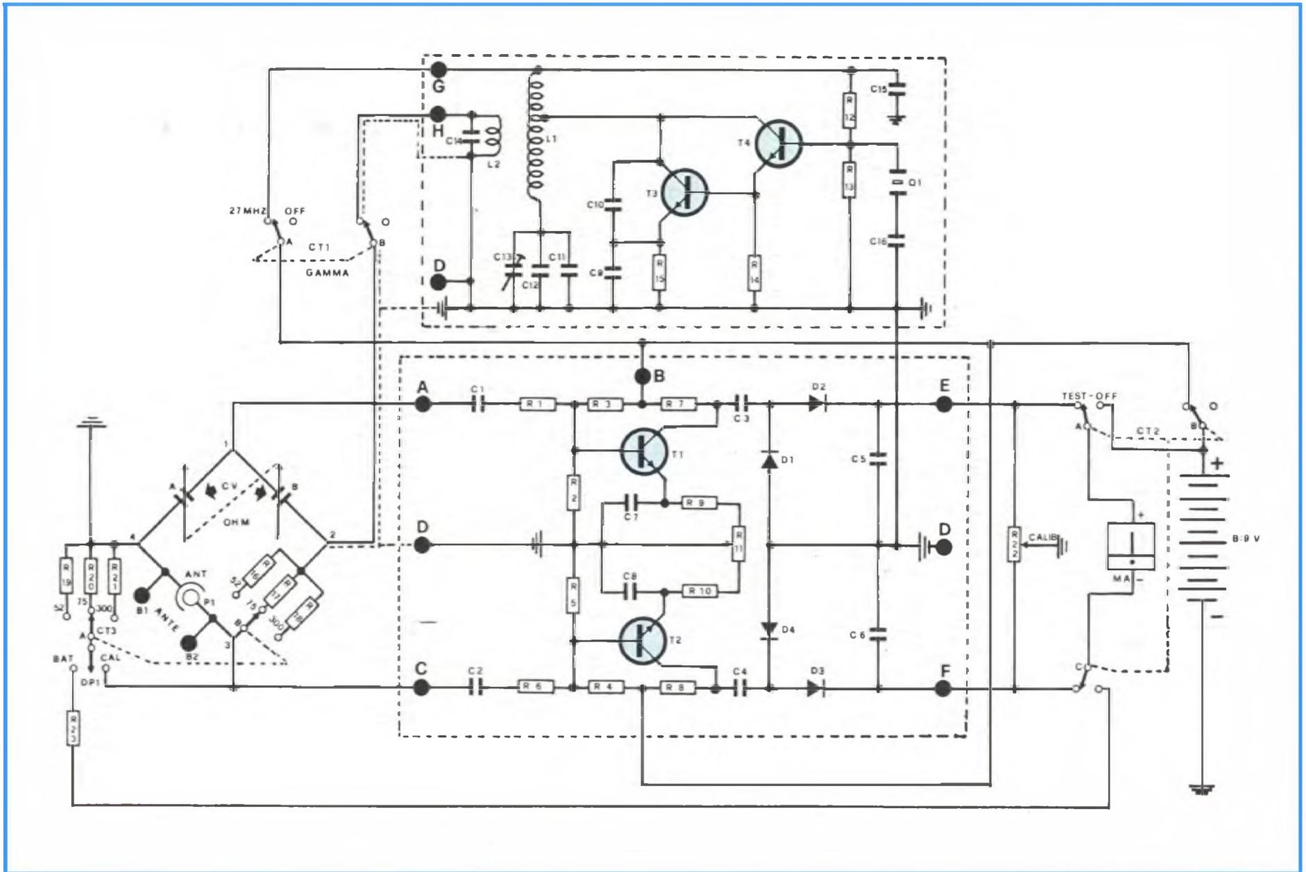
Fig. 1 - Schema elettrico del misuratore d'impedenza per CB, il cui funzionamento è basato su un circuito a ponte.
