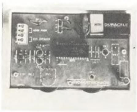
Fig. 5 - Campanello a microcomputer a realizzazione ultimata.
