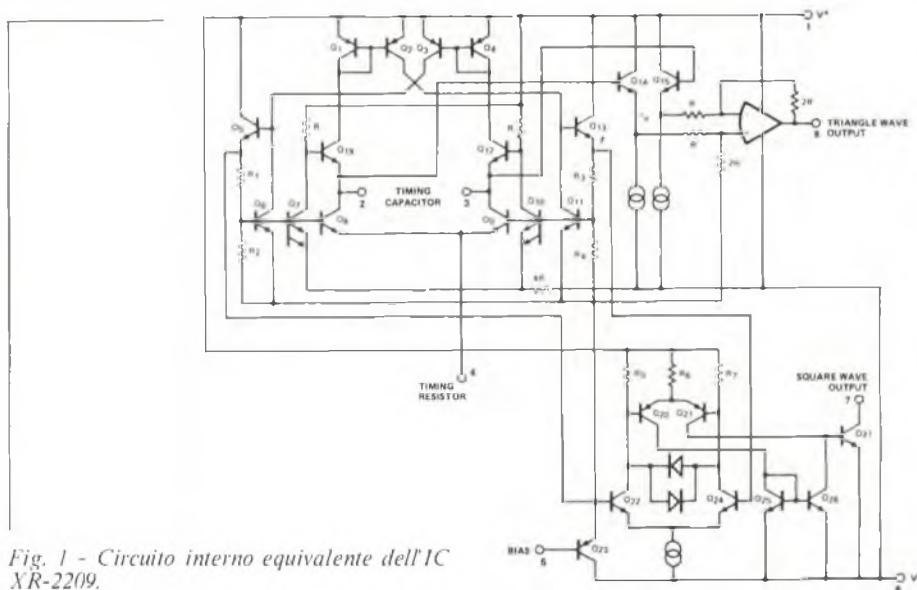
Fig. 1 - Circuito interno equivalente dell'IC XR-2209.
