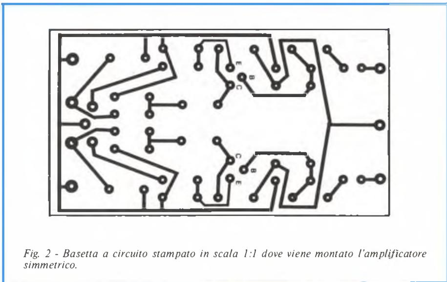
Fig. 2 - Basetta a circuito stampato in scala 1:1 dove viene montato l'amplificatore simmetrico.
