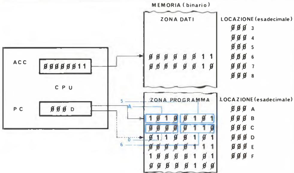
Si tratta di una istruzione da due bytes, contenuta nella posizione di memoria 000B e 000C, posizioni indicate dal Program Counter (PC) prima della esecuzione. Eseguita l'istruzione il contenuto del PC è 000D che rappresenta l'indirizzo da cui verrà prelevata la prossima istruzione.
