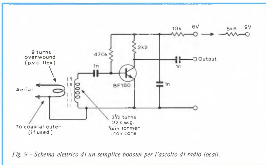
Fig. 9 - Schema elettrico di un semplice booster per l'ascolto di radio locali.
