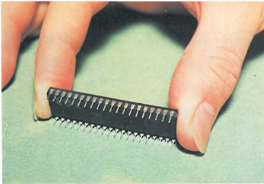
Fig. 10 - Particolare della piegatura dei piedini dei circuiti integrati che permette un perfetto inserimento degli stessi negli appositi zoccoli.
