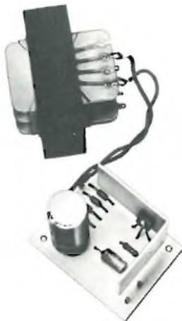
Un alimentatore stabilizzato a circuito integrato dalle molte applicazioni, eroga una tensione costante con tolleranza ristretta.
