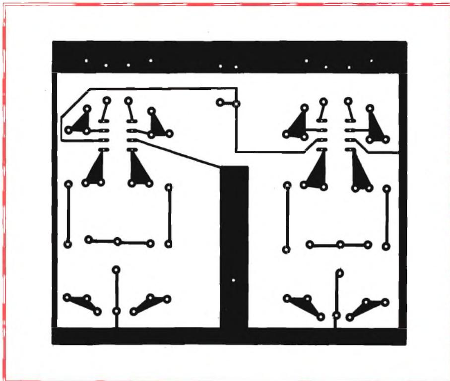
Fig. 3 - Basetta a circuito in scala 1:1 "panning" quadrifonico.
