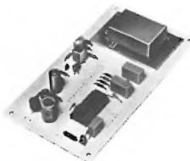
Moderno, efficientissimo e compatto circuito che, applicato ad un normale televisore, permette di giocare a tennis o a ping pong, hockey, squash, palla a volo da soli od in coppia. Le racchette sono mobili sia in senso verticale che orizzontale. Uno stabile oscillatore trasmette il segnale al televisore.
