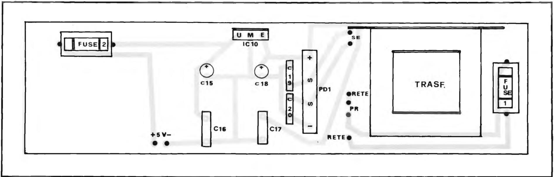
Fig. 7 - Disposizione dei componenti sul circuito stampato dell'alimentatore.
