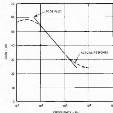
Fig. 5 - Curva di equalizzazione NAB e relativo scarto.
