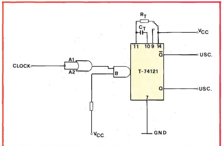
Fig. 1 - Schema di principio di un monostabile
