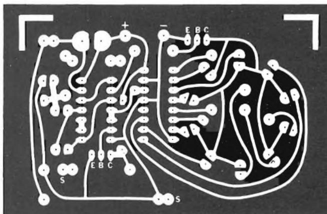
Fig. 4 - Circuito stampato lato rame della roulette tasabile.
