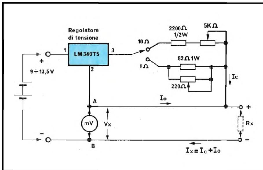
Fig. 1 - Schema elettrico dell'ohmetro.
