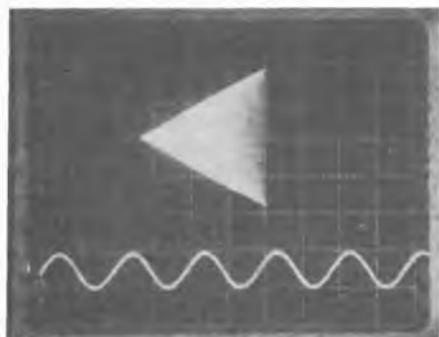
Fig. 4 - Modulazione perfetta esattamente al 100%.
