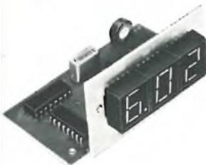
La tecnica digitale, che offre elevata precisione e chiarezza di lettura, è alla base di questo eccellente voltmetro a tre cifre per tensioni continue dal minimo di 1 mV al massimo di 999 V.
