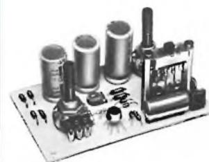
Circuito di elevate caratteristiche elettriche, produce un'onda quadra dai fianchi molto ripidi, adatta per la verifica della risposta di frequenza degli amplificatori audio. Impedenza di uscita qu: si indipendente dal carico. Tre gamme di frequenza commutabili.
