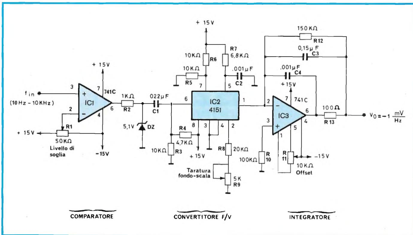
Fig. 1 - Schema elettrico del convertitore frequenza - tensione.
