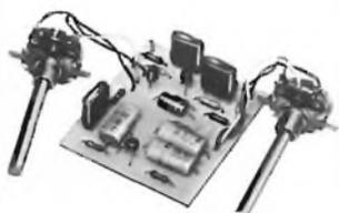
Oltre a preamplificare il segnale proveniente da uno strumento musicale a corde o di altro tipo trasduttore elettroacustico, permette di ottenere l'effetto di "vibrato" con possibilità di regolazione della frequenza, dell'ampiezza e di esclusione del medesimo.
