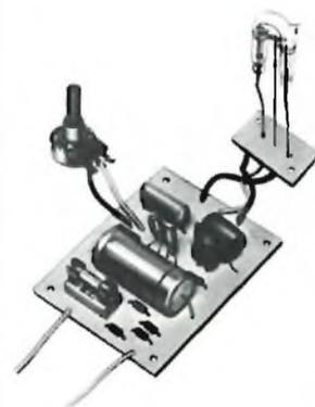
Efficiente lampeggiatore stroboscopico a scarico nel gas Xenon con possibilità di regolazione della frequenza. Utile per il controllo di organi rotanti o vibranti oppure per scopi di intrattenimento anche in combinazione con luci psichedeliche.
