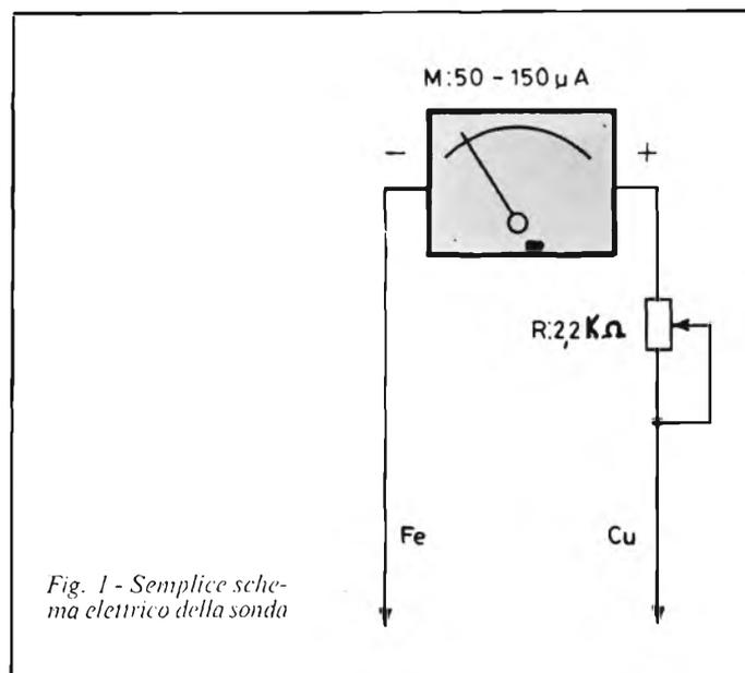
Fig. 1 - Semplice schema elettrico della sonda
