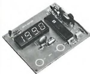
Uno strumento digitale di alta precisione a tre cifre e mezza con visualizzazione a LED, di facile montaggio e messa a punto. Eccezionali prestazioni. Adatto per laboratorio e servizio riparazioni.
