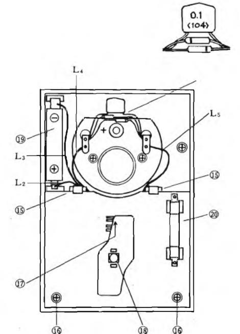
Fig. 10 - Metodo di installazione dei due diodi e del condensatore C, in parallelo allo strumento a bobina mobile. Il disegno riproduce anche i particolari relativi alla batteria (19), al fusibile (20), alla parte rotante del commutatore (17), ed ai terminali di ingresso (16).
