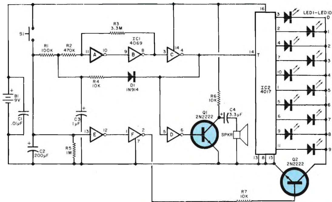
Fig. 2 - Schema elettrico di una mini-roulette.
