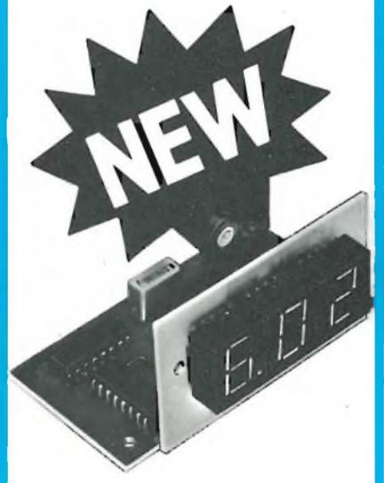
La tecnica digitale, che offre elevata precisione e chiarezza di lettura, è alla base di questo eccellente voltmetro a tre cifre per tensioni continue dal minimo di 1 mV al massimo di 999 V.
