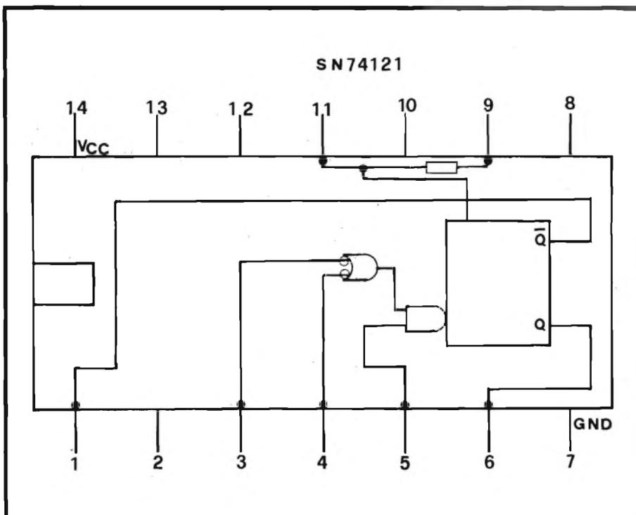
Fig. 3 - Circuito interno dell'IC9
