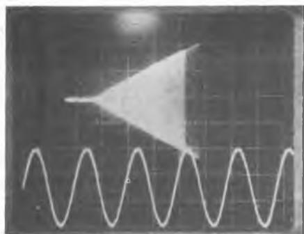
Fig. 5 - Aumentando il segnale appare la sovr modulazione.
