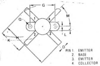
Fig. 7 - Connessione dell'I.C. 2N6368 della Motorola.
