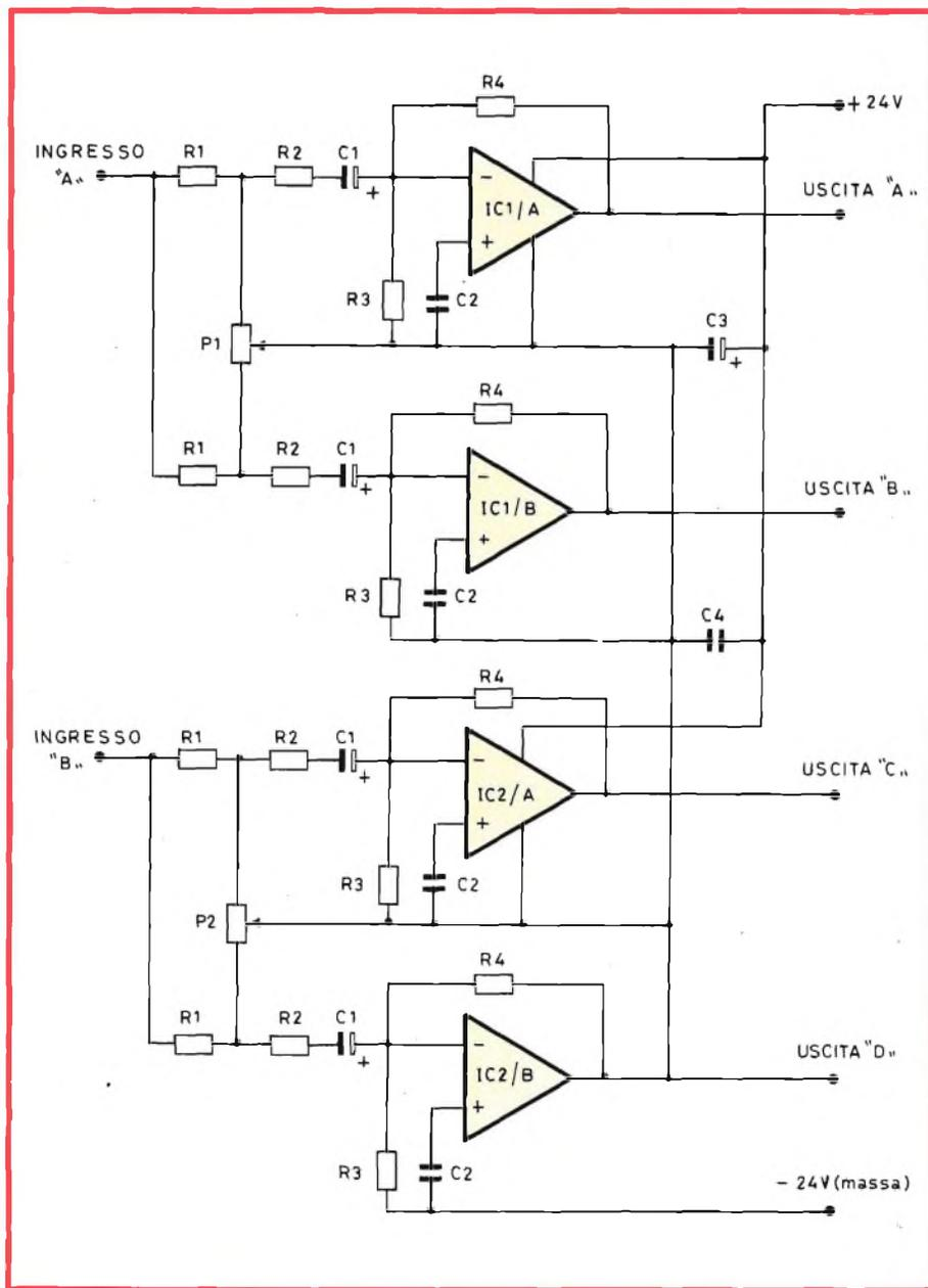
Fig. 1 - Schema elettrico del panning: si noti l'identità simmetrica dei 4 canali.
