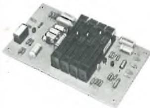
La funzione di un equalizzatore è quella di modificare la risposta in frequenza di un sistema di riproduzione in banda fonica. Tale modificazione può essere richiesta sia per compensare eventuali anomalie del sistema (imperfezioni acustiche del locale di produzione, anomalie dell'orecchio dell'ascoltatore, anomalie della parte elettrica) sia per ascoltare determinati "pezzi" in modo personalizzato.
