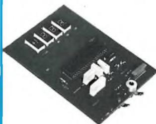
Finalmente uno strumento digitale a tre cifre e mezza (precisione 1 mV) di facile costruzione e messa a punto, di basso costo e di eccezionali prestazioni. Display luminoso a LED. Adatto per laboratorio o servizio riparazioni.
