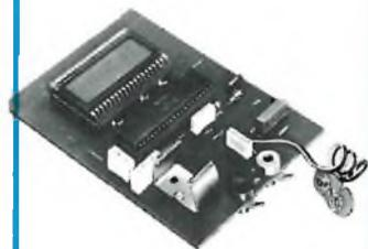
Un versatile e preciso strumento digitale a tre cifre e mezza (precisione 1 mV) di facile costruzione e messa a punto, di basso costo e di eccezionali prestazioni. Display a cristalli liquidi di basso consumo, adatto per alimentazione a batteria.
