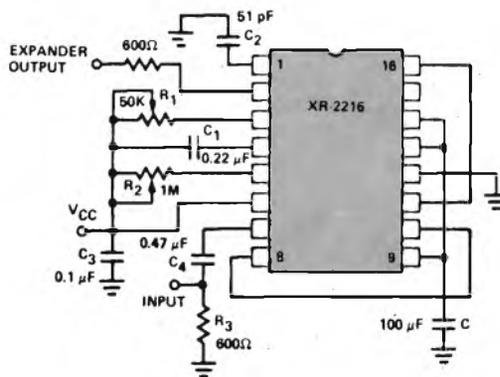
Fig. 5 - Circuito di utilizzazione dello XR-2216 come espansore.
