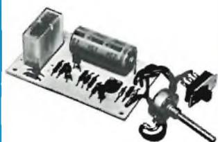
Un temporizzatore di prestazioni nettamente superiori ad altri tipi sul mercato, per precisione, semplicità costruttiva e versatilità. Permette temporizzazioni regolabili da 40 secondi fino a 1 ora e 30 minuti. Inseribile in qualsiasi apparecchio.
