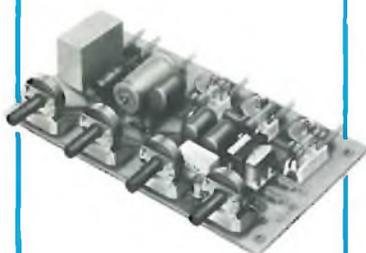
Il circuito consente di visualizzare, con l'ausilio di lampade colorate il ritmo e le tonalità di un pezzo musicale. È provvisto di regolazione sui toni bassi, medi e alti e di una regolazione della sensibilità d'ingresso. La presenza di un transistor amplificatore, conferisce una ottima sensibilità alla fonia.
