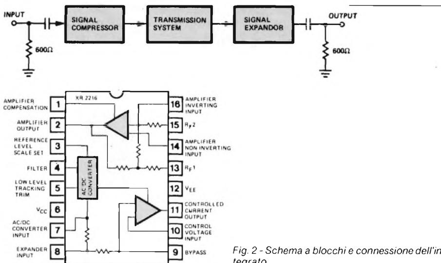
Fig. 2 - Schema a blocchi e connessione dell'integrato.
