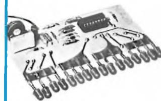
Questo indicatore del livello d'uscita (Vu-Meter) oltre ad essere preciso perchè non soffre dello smorzamento e dell'inerzia che sono caratteristici dei sistemi ad indice, abbellisce il pannello dell'apparecchio che lo impiega, dando, durante il funzionamento, l'impressione di "vedere" suoni, oltre a udirli. E' economico, facile da realizzare.
