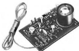
Un trasmettitore di piccolissima potenza ma di eccellenti risultati, operante sulla gamma delle radiodiffusioni FM. Un divertente gadget per l'uso in casa e fuori, di minimo ingombro con raggio di azione ottimale di una trentina di metri e ricevibile con qualsiasi apparecchio radio a modulazione di frequenza.
