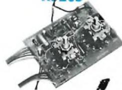
Indispensabile per trasformare un millivoltmetro digitale in un completo "multimetro" estendendo alla misura di varie grandezze elettriche, come le correnti e le tensioni sia continue che alternate e la resistenza. Si può costruire in tre varianti per adattarlo alla gamma completa di millivoltmetri della serie KS.
