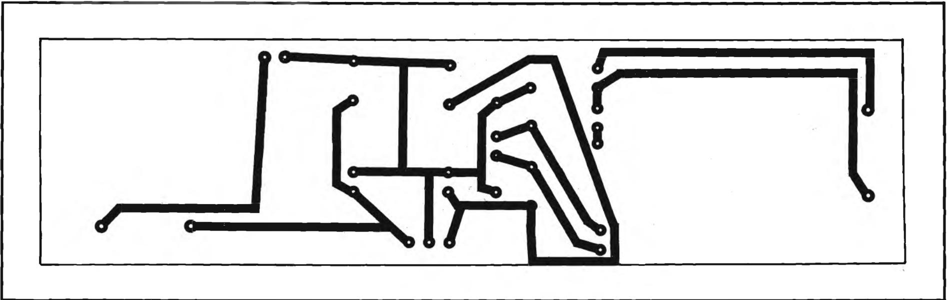
Fig. 8 - Basetta a circuito stampato dell'alimentatore in scala 1:1.
