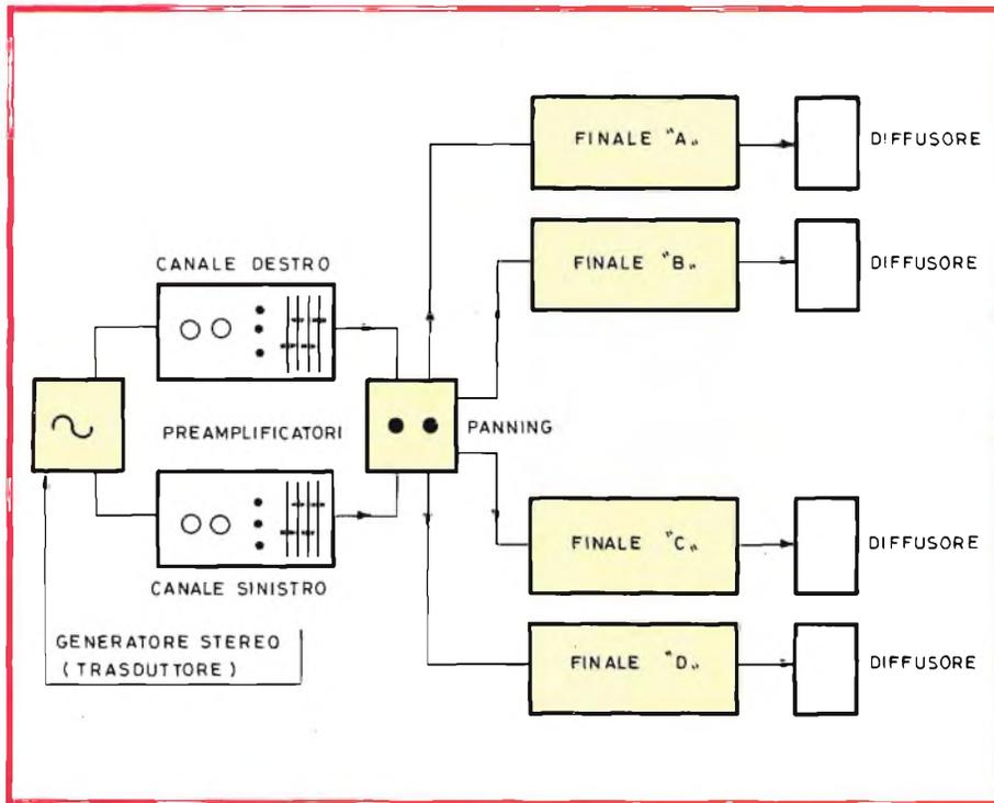
Fig. 4 - Collegamento del sistema "panning" tra le uscite di un preamplificatore e quattro gruppi di potenza.
