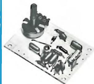
Un semplicissimo ricevitore radio super-rigenerativo dalle prestazioni brillanti. Miniatuzzato e di semplicissima costruzione, può servire per l'ascolto in cuffia delle emittenti in modulazione di frequenza, oppure collegato ad un amplificatore per l'ascolto in altoparlante. Sintonia a diodo varicap.
