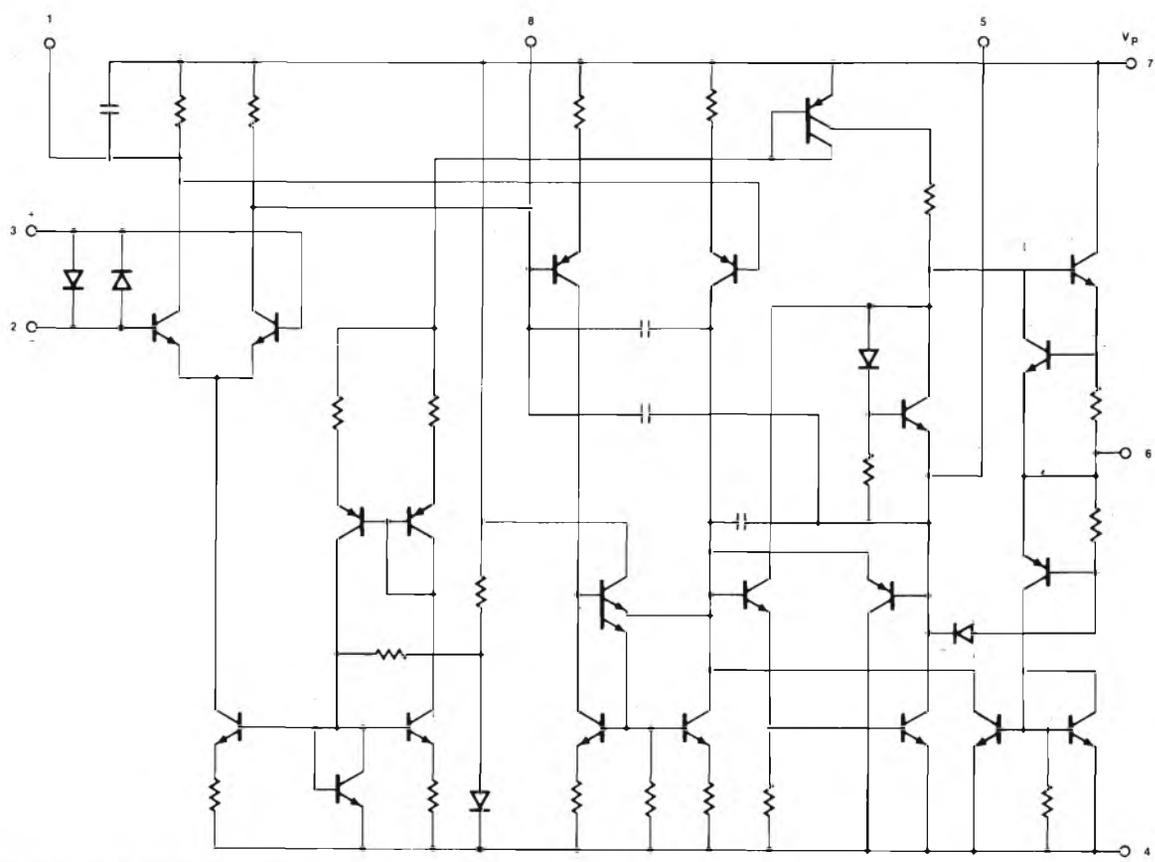
Fig. 2 - Circuito equivalente dell'integrato.
