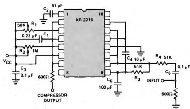
Fig. 4 - Circuito di utilizzazione dello XR-2216 come compressore.
