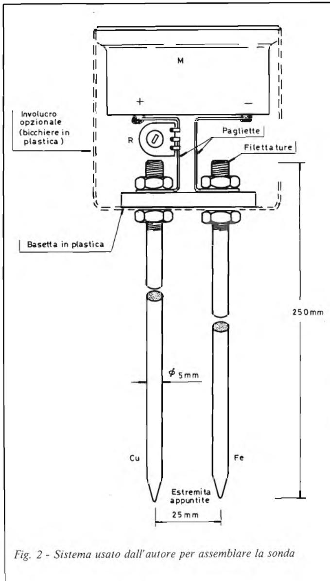
Fig. 2 - Sistema usato dall'autore per assemblare la sonda
